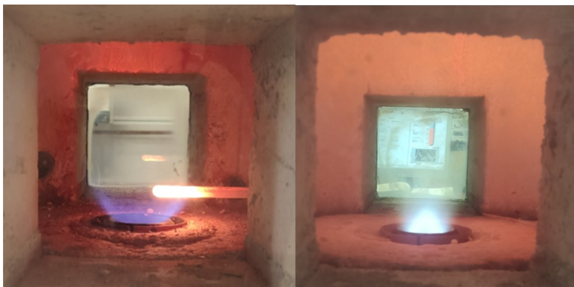
Rysunek 49. Płomień wirowy podczas pomiarów sondą aspiracyjną oraz płomień zawirowany bez utworzenia strefy CTRZ
