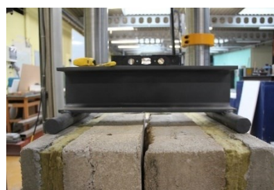
Rysunek 63 Betonowe matryce do badań: a) montaż kotw wklejanych, b) widok gotowej matrycy przed opisaniem i montażem na stanowisku, c) rama do przekazania obciążeń po wypoziomowaniu
