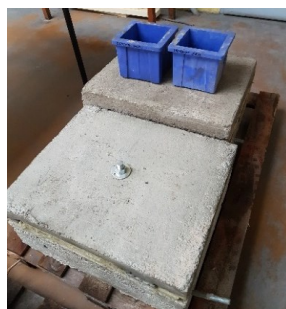
Rysunek 63 Betonowe matryce do badań: a) montaż kotw wklejanych, b) widok gotowej matrycy przed opisaniem i montażem na stanowisku, c) rama do przekazania obciążeń po wypoziomowaniu
