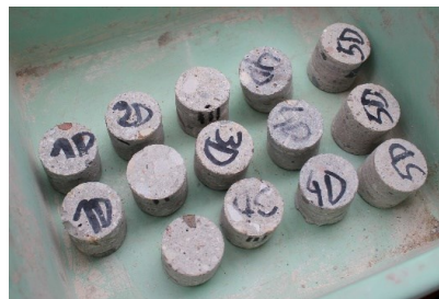
Rysunek 41 Odwierty rdzeniowe do badania wytrzymałościowego: a) po wywierceniu b) po przygotowaniu w laboratorium
