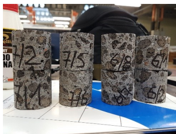
Rysunek 47 Próbkę klejone do badania wytrzymałości: a) przygotowane zestawy próbek, b) poprawne uszkodzenie próbki
