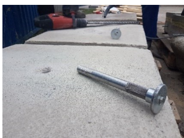
Rysunek 63 Betonowe matryce do badań: a) montaż kotw wklejanych, b) widok gotowej matrycy przed opisaniem i montażem na stanowisku, c) rama do przekazania obciążeń po wypoziomowaniu
