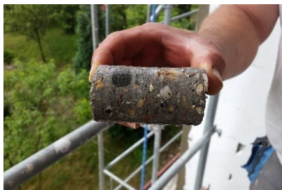
Rysunek 41 Odwierty rdzeniowe do badania wytrzymałościowego: a) po wywierceniu b) po przygotowaniu w laboratorium
