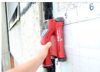
Rysunek 42 Skanowanie zbrojenia urządzeniem Ferroskan PS200: a) w trakcie pomiaru, b) bloki 60x60 z widocznymi odchyłkami w ułożeniu zbrojenia i punktami charakterystycznymi (kotwa)
