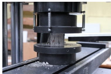
Rysunek 46 Badanie wytrzymałości na ściskanie betonu warstwy fakturowej: a) pomiar parametrów próbki, b) prawidłowo zniszczona próbka
