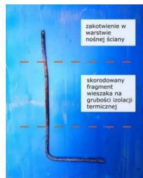
Rysunek 43 Pobranie wieszaków stalowych do badania wytrzymałościowego: a) miejsce pobrania z widocznymi kotwami wzmacniającymi, b) wieszak przed wykuciem i wycięciem z warstwy nośnej ściany, c) pobrana próbka z widoczną korozją w grubości izolacji termicznej [156]
