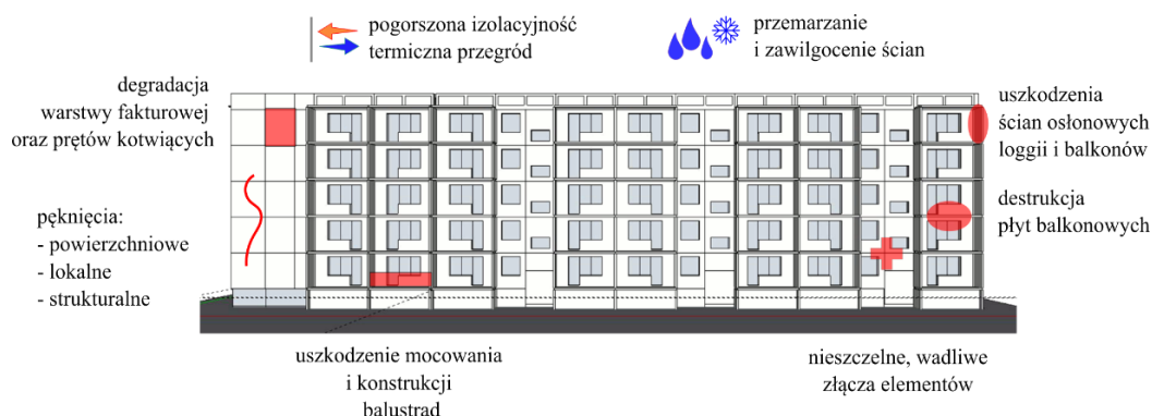
Rysunek 10 Najczęstsze uszkodzenia budynków wielopłytowych powstałe w wyniku działania warunków atmosferycznych
