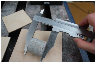
Rysunek 46 Badanie wytrzymałości na ściskanie betonu warstwy fakturowej: a) pomiar parametrów próbki, b) prawidłowo zniszczona próbka
