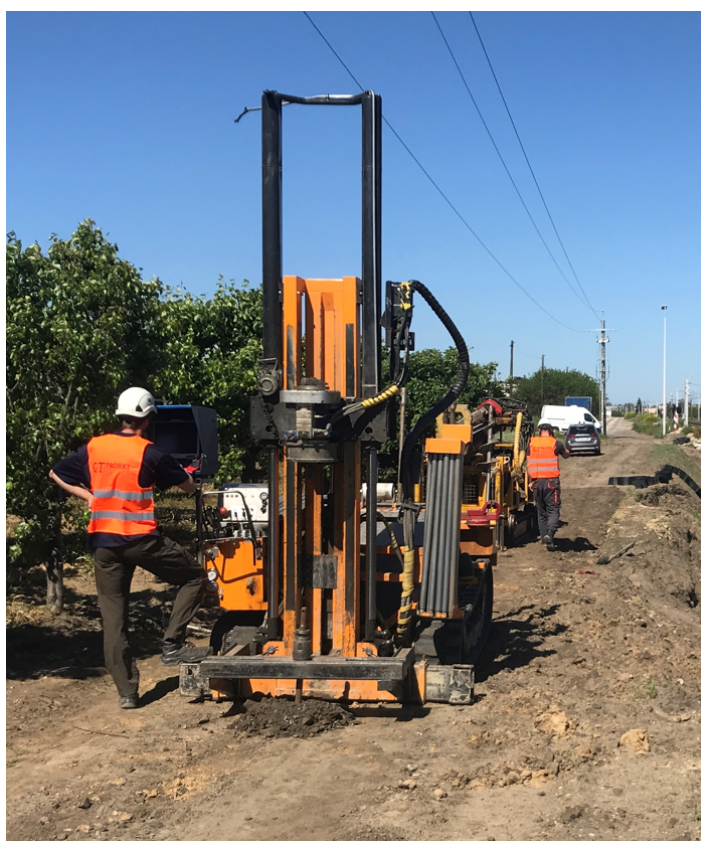
RYSUNEK 3.11: Sonda statyczna w trakcie pracy - archiwum GT Projekt
