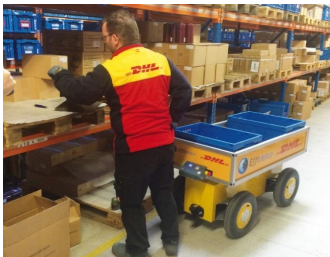
Rys. 4.5. Effibot – zautomatyzowany wózek transportowy [81]
