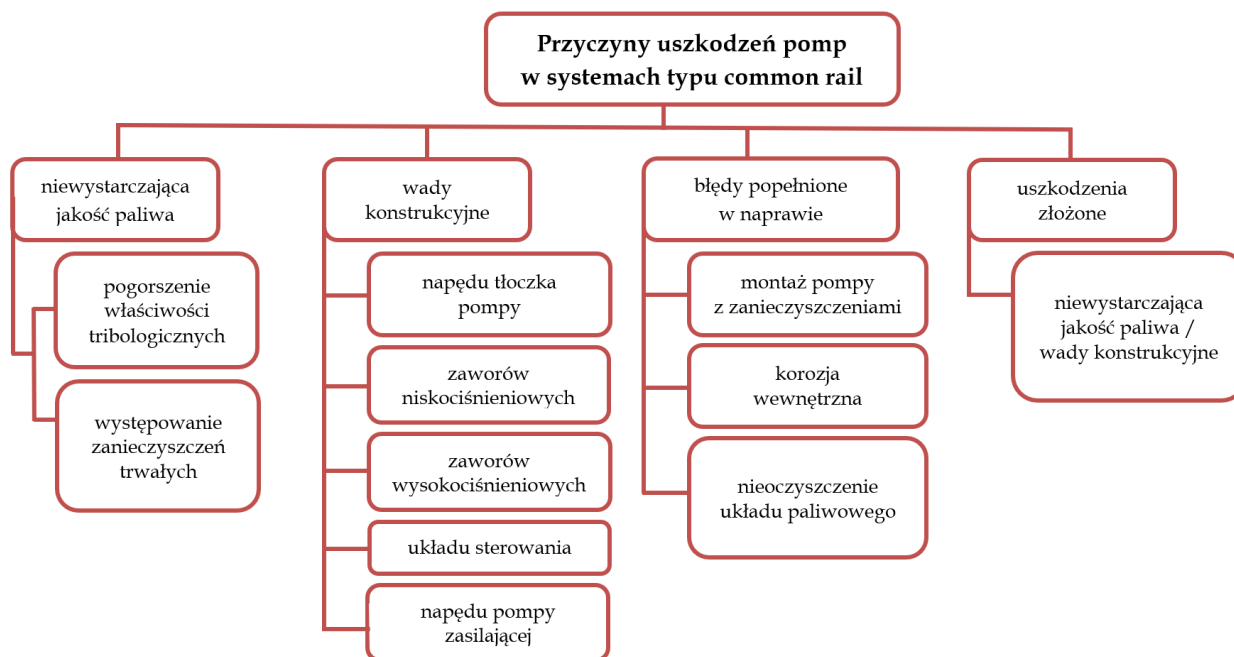
Rys. 1. Przyczyny uszkodzeń pomp wtryskowych w systemach typu common rail
