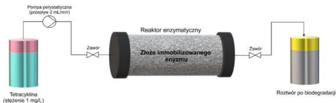
Rys. 11. Schemat bioreaktora zastosowanego w procesie konwersji tetracykliny przez lakazę unieruchomioną na chitynowym szkielecie gąbki Aplysina archeri
