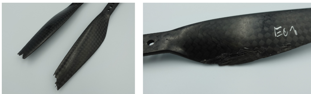
Rys. 6.1: Przykłady dwóch głównych typów uszkodzeń wirników — złamanie płata (po lewej) oraz deformacja krawędzi (po prawej)
