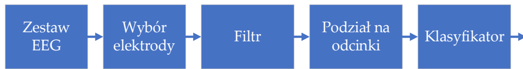
Rys. 11. Przepływ sygnału w metodzie SSVEP
