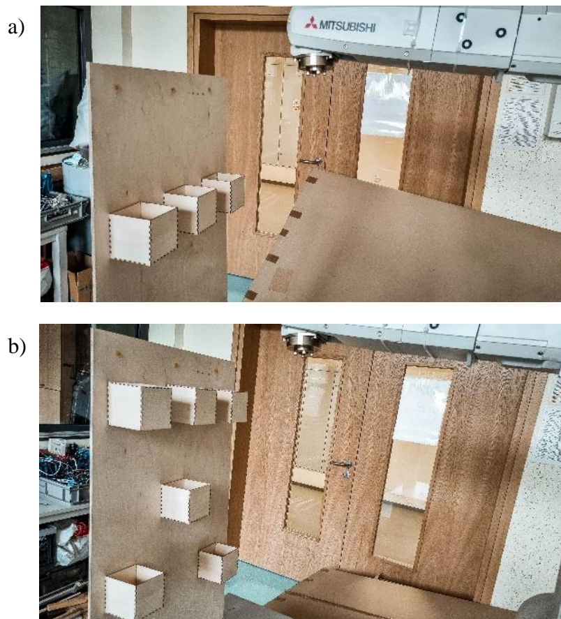
Rys. 77. Widok stanowiska do sortowania z robotem przemysłowym: a) scenariusz pierwszy, b) scenariusz drugi
