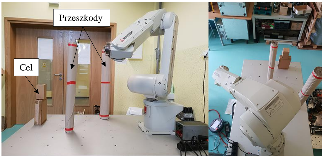
Rys. 74. Zdjęcie robota na stanowisku badawczym do testów interfejsu w trzecim scenariuszu, przeszkody oraz cel
