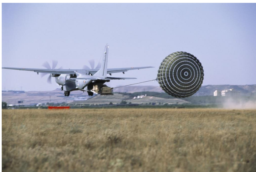
Fot.4.2. Zrzut ładunków z bardzo małej wysokości z samolotu C-295M CASA [fot. EADS CASA, 2003 r.].
