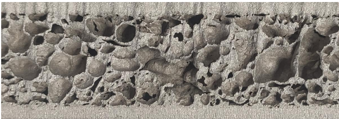
Rysunek 2. Przekrój monolitycznej struktury typu sandwich z rdzeniem z piany aluminiowej [Opr. własne]
