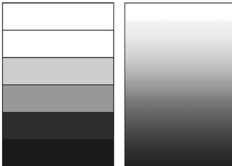
Rysunek 1. Przykład skokowej oraz ciągłej zmiany właściwości materiałowych FGM [50]
