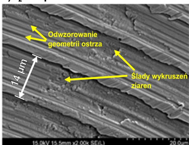
Rys. 7.35. Obrazy SEM powierzchni obrobionej stali C45 po mikrofrezowaniu z posuwem f_z = 1 \mu\text{m}/\text{ostrze} (a), f_z = 1,4 \mu\text{m}/\text{ostrze} (b), f_z = 2 \mu\text{m}/\text{ostrze} (c) oraz f_z = 7 \mu\text{m}/\text{ostrze} (d)
