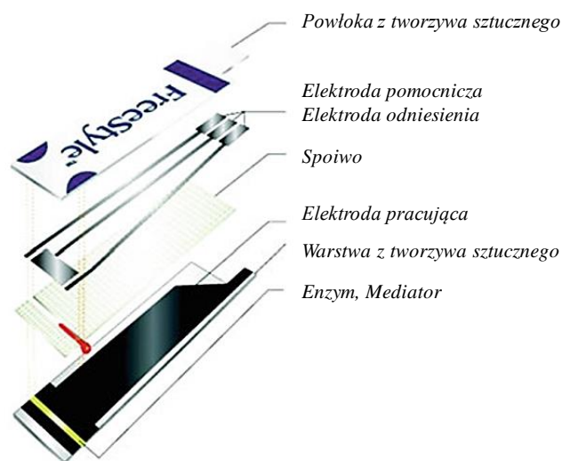
Rys. 13. Budowa jednorazowego paska testowego. 34
