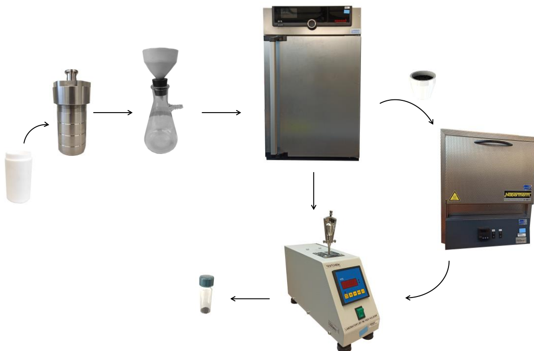
Rys. 26. Etapy procesu syntezy materiałów metodą hydrotermalną.
