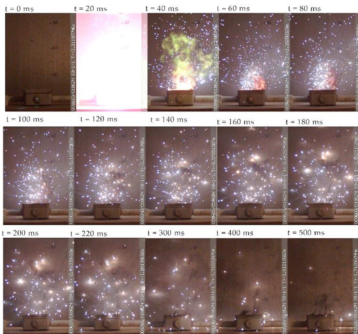
Rys. 2. Kluczowe klatki rejestracji zapłonu i rozwoju wyładowania łukowego ( I_m = 1250A , U = 400V ) [Publikacja III, fig. 10].
