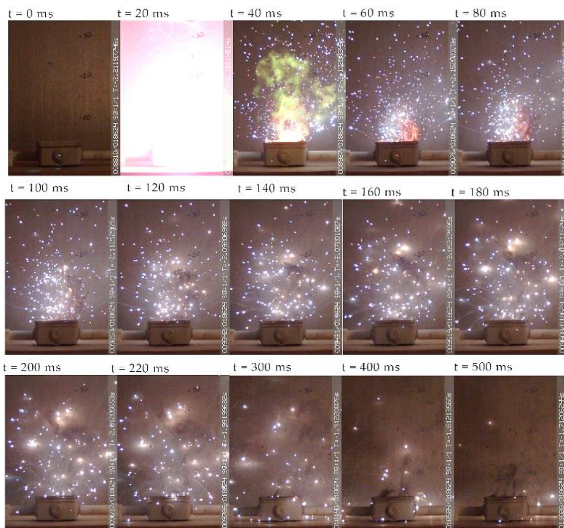
Rys. 2. Kluczowe klatki rejestracji zapłonu i rozwoju wyładowania łukowego ( I_m = 1250\text{A} , U = 400\text{V} ) [Publikacja III, fig. 10].
