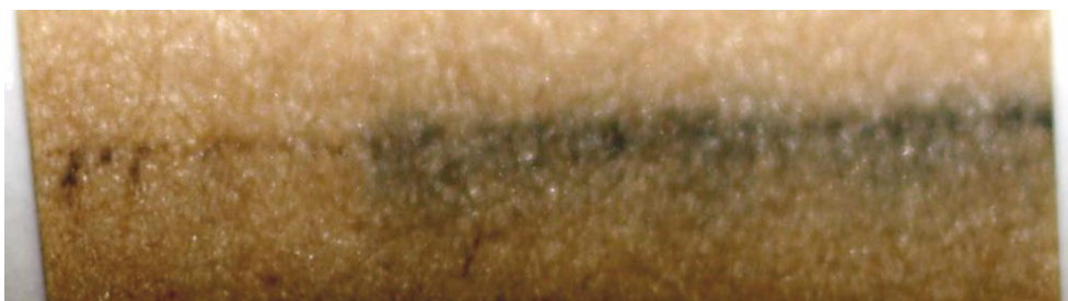
Rys. 3.2. Fragment izolacji rdzenia; powyżej ciemnej linii znajdowała się folia aluminiowa; poniżej folii stwierdzono dendryty z zawartością jonów miedzi (rysunek udostępniony przez Keitha Ellisa)
