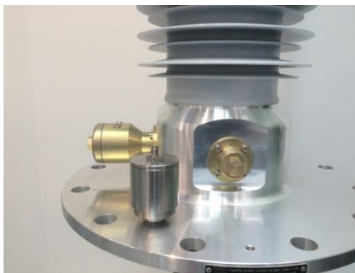
Rys. 9.5. Gniazdo pomiarowe i napięciowe z sondami w izolatorze Moser-Glaser
