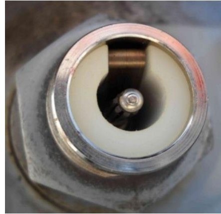
Rys. 2.13. Modyfikacja gniazda pomiarowego ze sprężyną uziemiającą; trzpień wykonany z wiązki mosiężnych drutów
