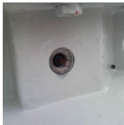
Rys. 2.10. Widok gniazda „typu B” z trzpieniem zacisku o średnicy 4mm
