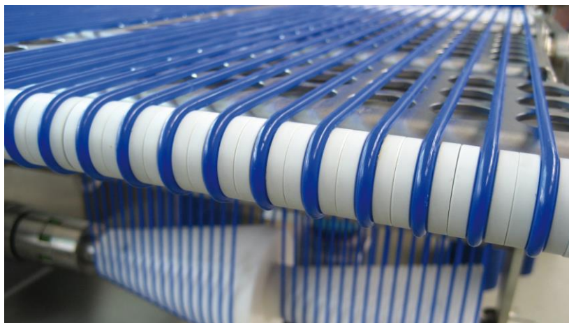
Rys. 11. Przenośnik z pasem okrągłym z funkcjonalnością obracania transportowanych produktów, dzięki zróżnicowaniu prędkości liniowych poszczególnych ciągów [17]
