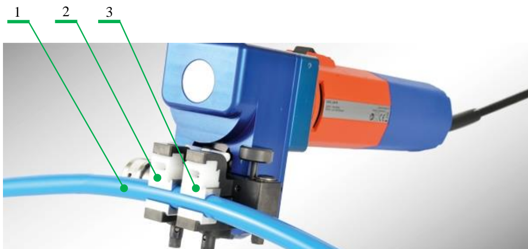
Rys. 23. Zgrzewarka wibracyjna ręczna firmy Optibelt [44]: 1 – zgrzewany pas, 2 – szczęka ruchoma, 3 – szczęka stała
