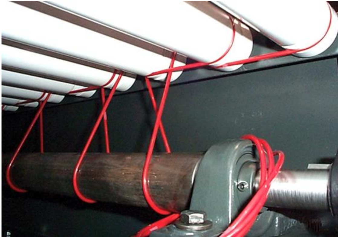
Rys. 6. Przykład przekładni pasowej z pasem okrągłym, ilustrujący łatwość zmiany płaszczyzny, w której umieszczone są kolejne napędzane koła [9]
