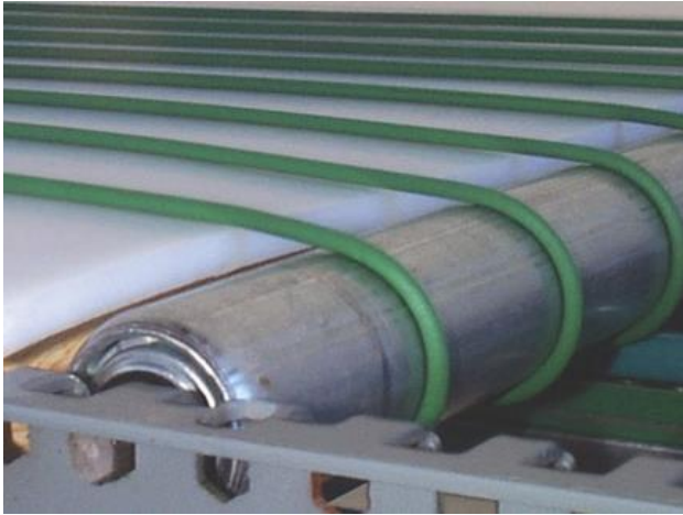
Rys. 8. Rozwiązania przenośników pasowych z pasami o przekroju kołowym: a) współpraca pasa o przekroju kołowym z gładkim krążnikiem, b) wkładki ustalające wspomagające właściwe prowadzenie pasa na gładkich rolkach [9]
