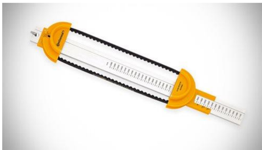
Rys. 17. Pomiar długości pasa o zamkniętym obwodzie za pomocą dedykowanego przymiaru z liniałem prostym [31]
