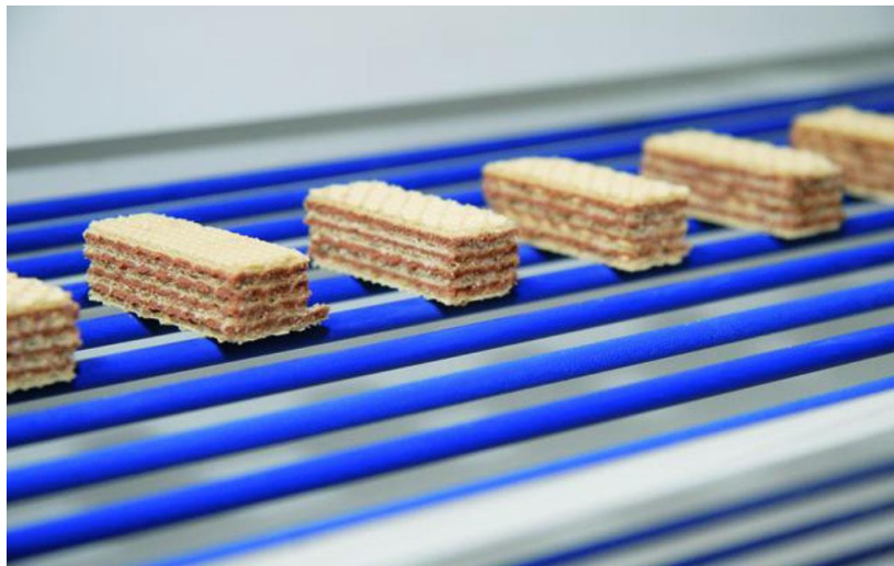
Rys. 10. Przenośnik pasowy zastosowany do transportu lekkich produktów w przemyśle spożywczym [16]
