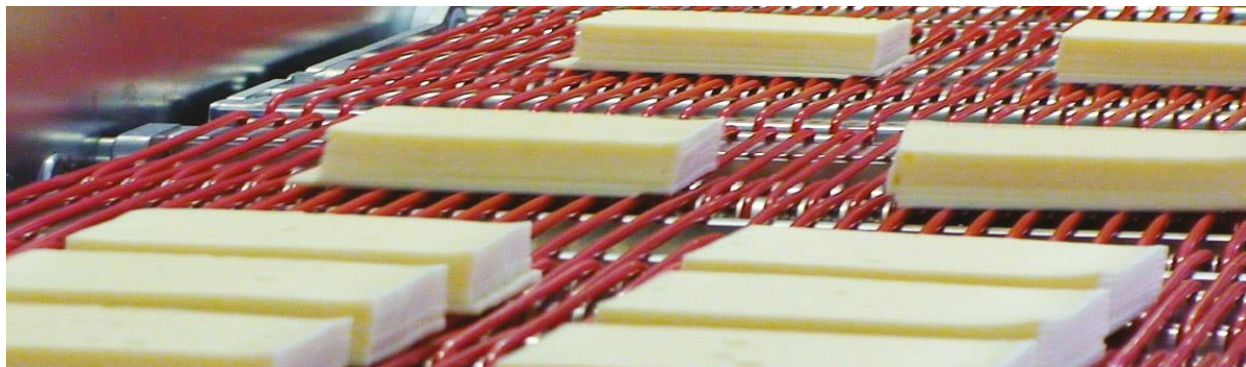
Rys. 12. Układ napędowy z pasem okrągłym, pełniącym jednocześnie funkcję transportującą i napędową na przykładzie linii transportu sera [18]
