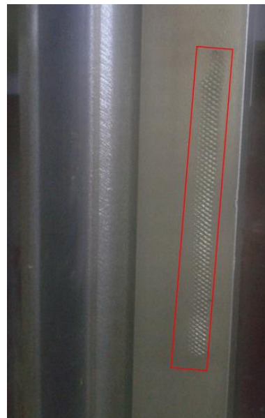
Rys. 4.17. Prowadnica typu T90/A: a) widok prowadnicy od góry z zaznaczoną na czerwono powierzchnią roboczą S , b) widok z plastycznie uszkodzoną powierzchnią roboczą
