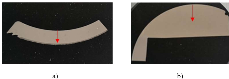
Rys. 5.5. Zglądy metalograficzne, obszar i kierunek pomiarów twardości: a) panewka, b) głowa.
