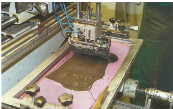
Rys. 8.1. Nanoszenie powłoki na bazie grafitu metodą sitodruku
