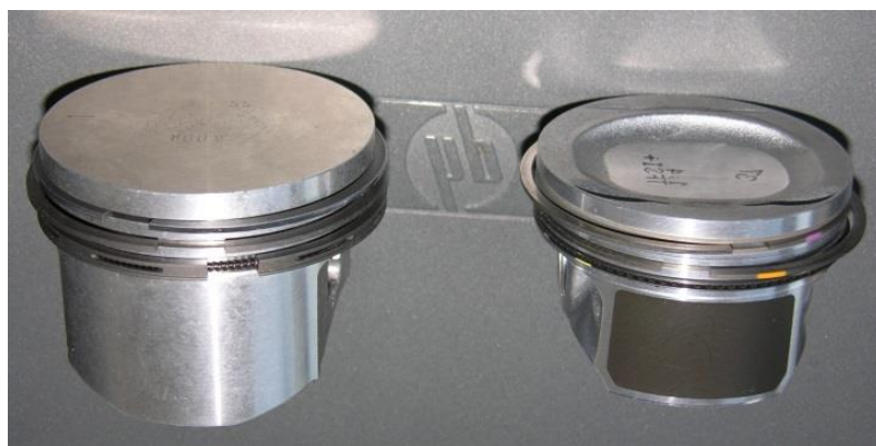
Rys. 2.1. Tłok silnika samochodu Fiat Cinquecento z lat pięćdziesiątych ubiegłego wieku – z lewej strony oraz tłok VW 1,4 – z prawej strony
