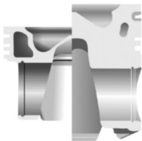
Rys. 3.7. Porównanie wysokości tłoka stalowego i aluminiowego [47]
