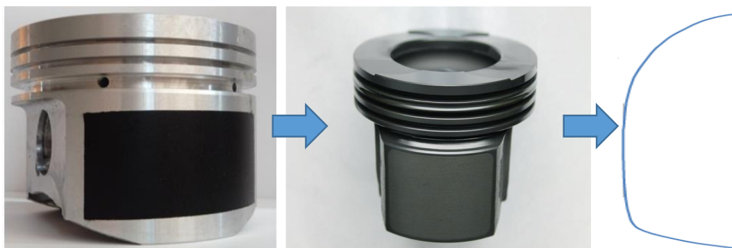
Rys. 7.2. Standardowe pokrycie powierzchni nośnej i profil tłoków stosowanych w silnikach spalinowych
