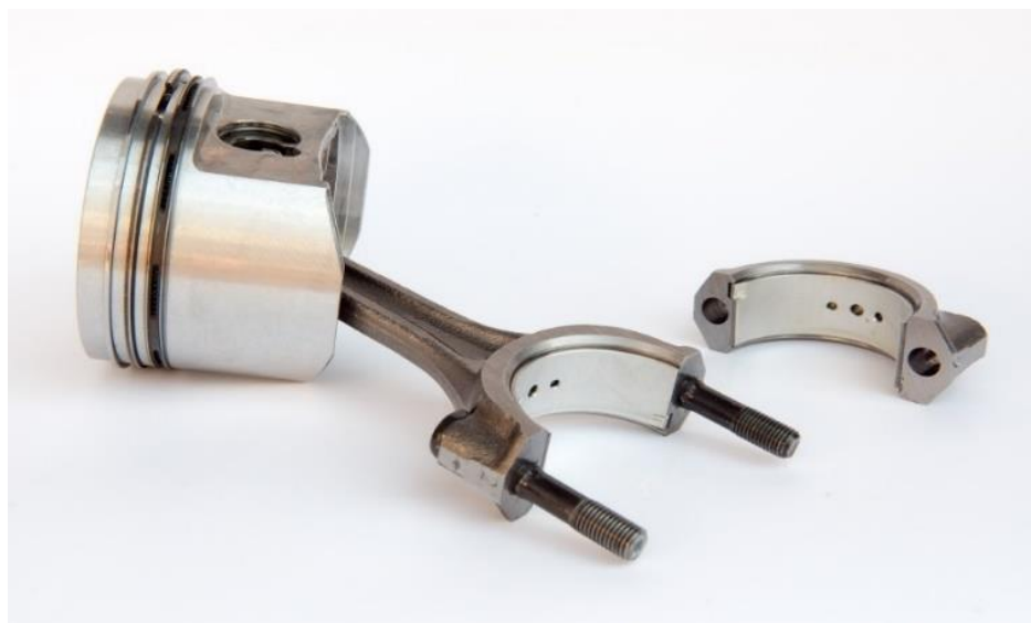
Rys. 9.3. Widok kompletnego tłoka silnika 170A.046
