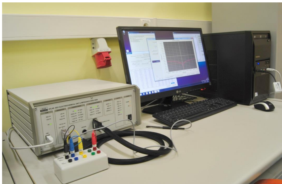
Rys. 43. Stanowisko badania odporności na korozję potencjostatu-galwanostatu ATLAS 0531 EU&IA firmy Atlas Solich.
