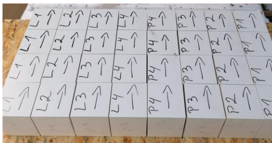
Rysunek 3.12. Próbkę przeznaczony do badań modułu sprężystości: a) schemat cięcia zgodny z rys. 3.11a, b) opis przykładowej próbki, c) schemat cięcia zgodny z rys. 3.11b.
