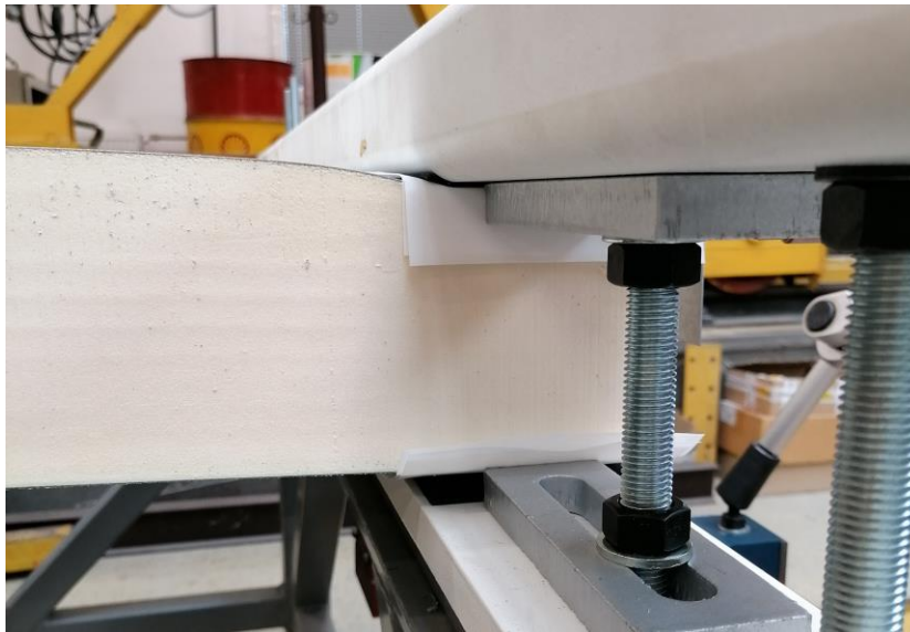
Rysunek 3.91. Wgniecenie na podporze próbki SP_1_1.
