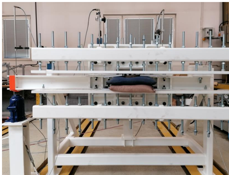
Rysunek 3.62. Badanie oporu ruchu stanowiska.
