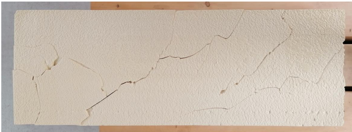
Rysunek 3.99. Schemat zniszczenia panelu warstwowego SP_120_4100_8_2 w próbie skręcania swobodnego: a), b) panel zamocowany w stanowisku, c) widok rdzenia z góry.
