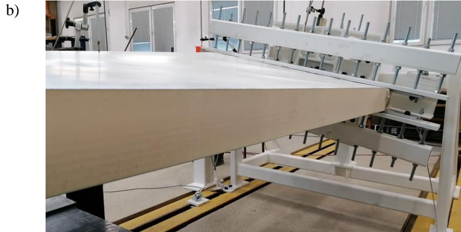
Rysunek 3.49. Stanowisko laboratoryjne do skręcania paneli warstwowych:
