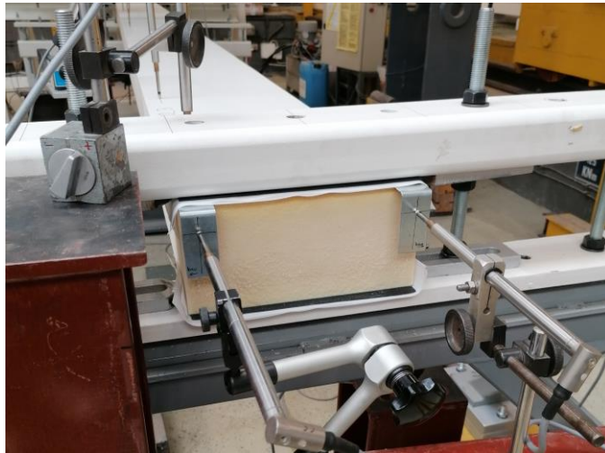
Rysunek 3.96. Pomiar deplanacji podporowego przekroju poprzecznego próbki SP_16_1.
