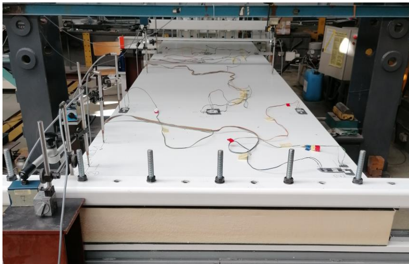
Rysunek 3.113. Badania paneli warstwowych z zastosowaniem tensometrów: próbka SP_120_4100_2_1.
