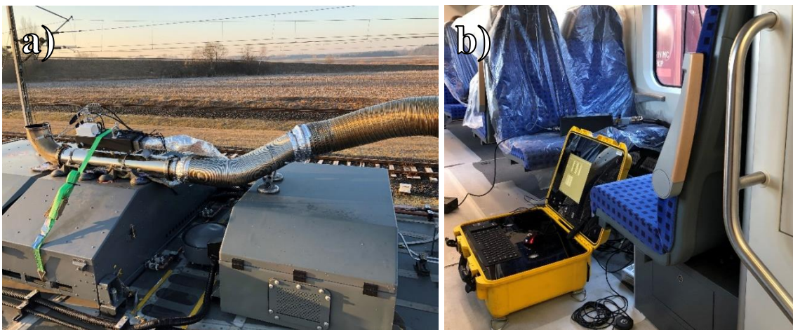
Rysunek 5.1. Przykładowy sposób montażu sprzętu pomiarowego: a) przepływomierz podłączony do rury wylotowej, b) urządzenie PEMS do pomiaru emisji spalin
