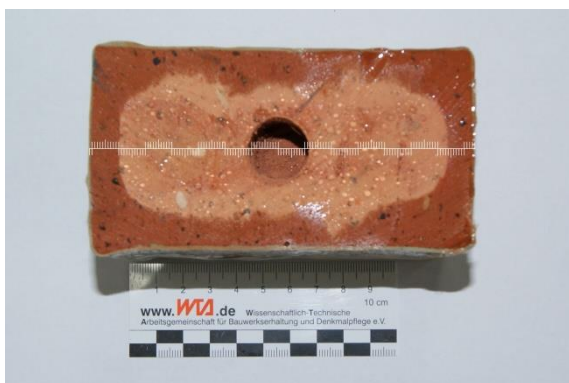
Fot. 5.7 Penetracja żywicy silikonowej przy S = 50% (fot.: autor)
