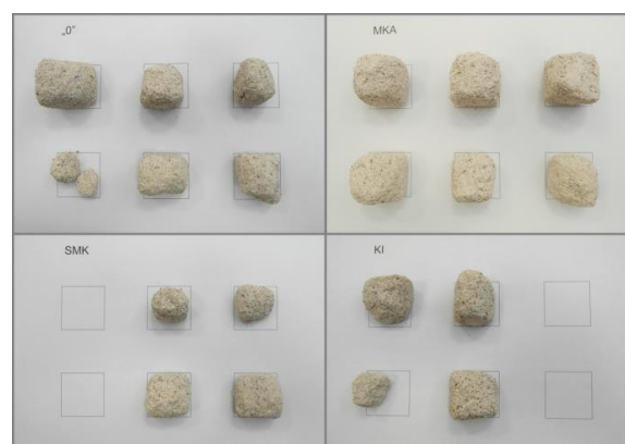
Fot. 5.11 Próbki zaprawy po cyklach badania odporności na zasolenie (fot.: autor)
