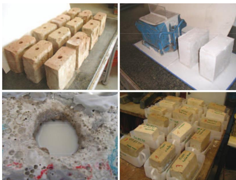
Fot. 5.2 Przygotowanie (na górze) oraz impregnacja (na dole) próbek (fot: [12])
