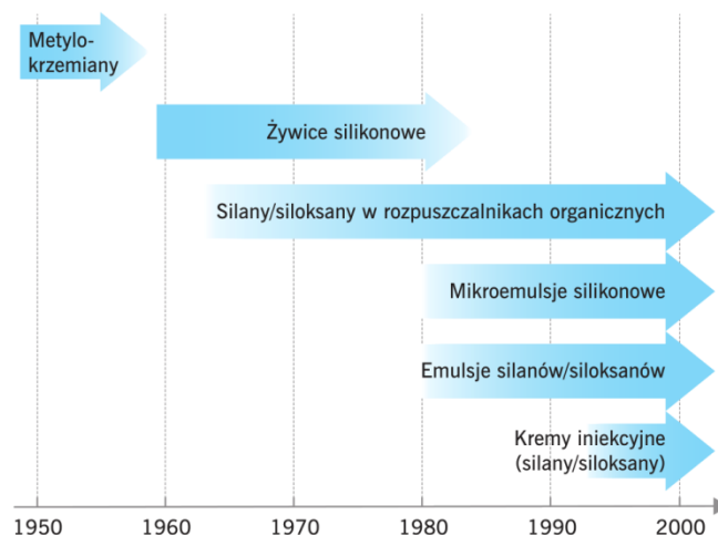
Rys. 4.13 Główne okresy stosowania hydrofobizujących preparatów iniekcyjnych (rys.: [64])
