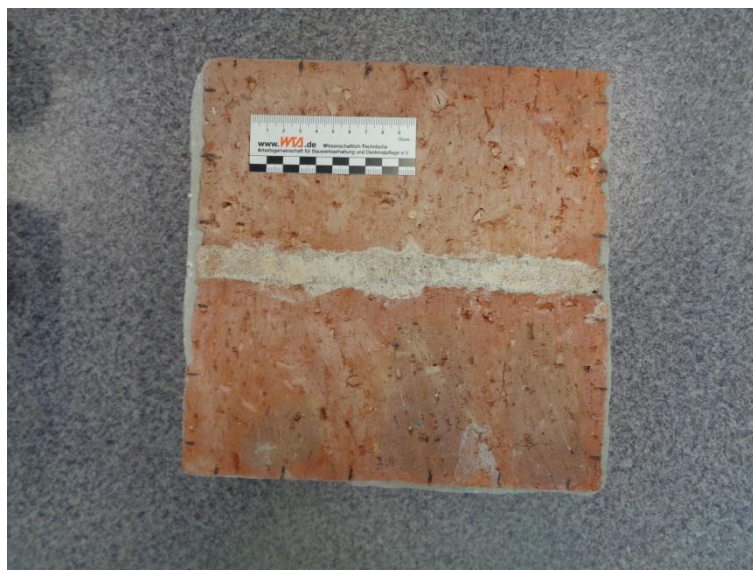
Fot. 6.5 Punkty pomiarowe na powierzchni czołowej próbki do badania absorpcji kapilarnej (fot.: autor)
