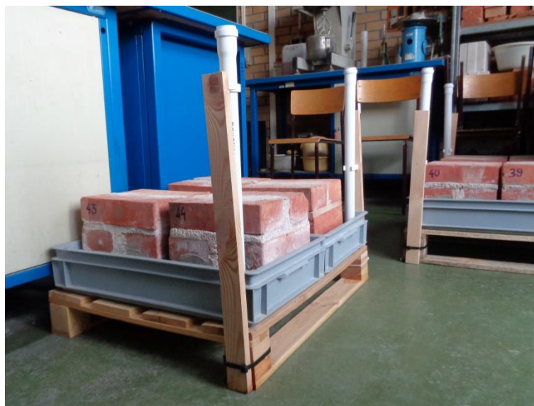
Fot. 6.6 Badanie absorpcji kapilarnej próbek poddanych iniekcji chemicznej (fot.: autor)
