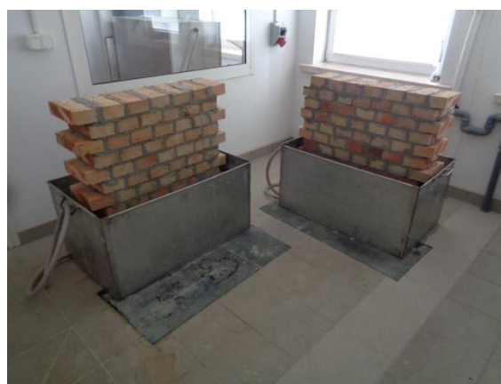
Fot. 4.7 Mury badawcze przygotowane do iniekcji w metodzie ITB (fot.: autor)
