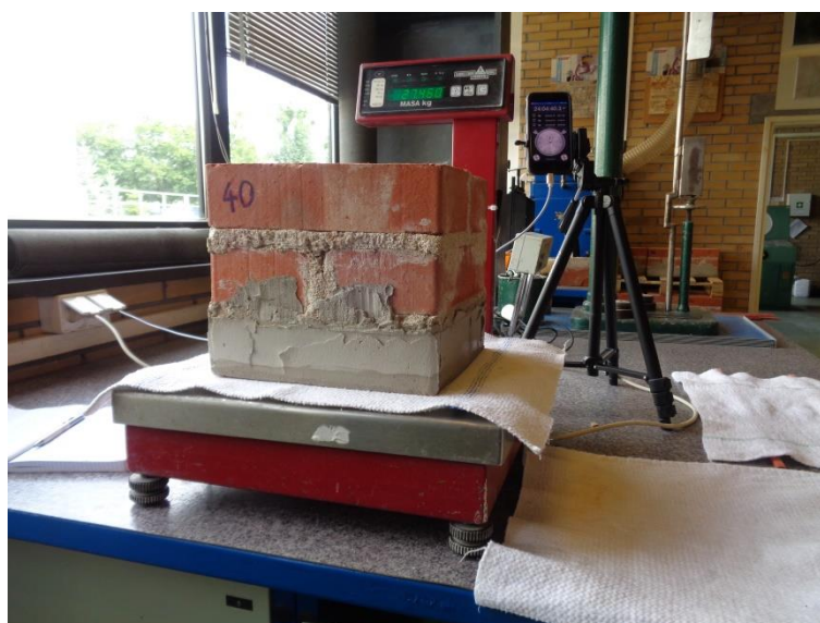
Fot. 6.7 Stanowisko badawcze – ważenie próbek z rejestracją czasu wyjęcia oraz ponownego zanurzenia próbki (fot.: autor)
