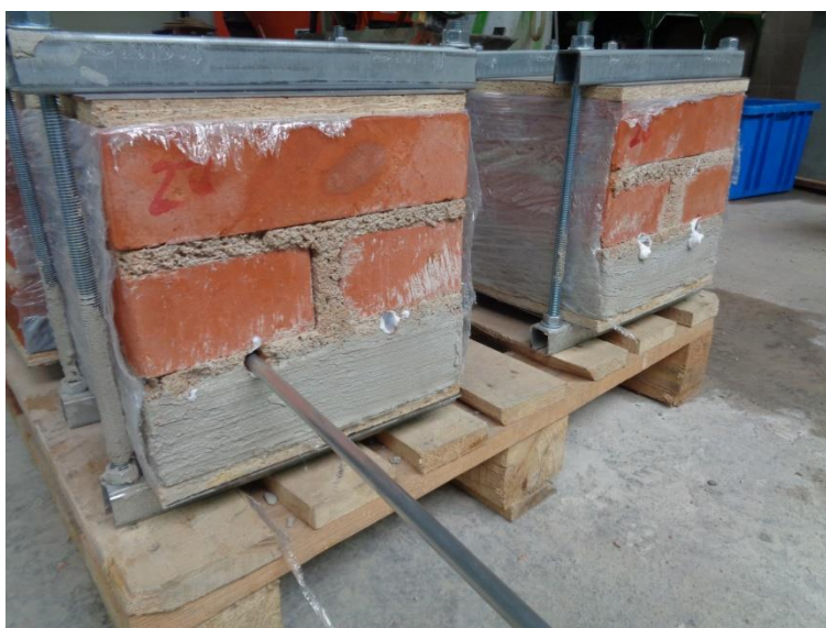
Fot. 6.4 Iniekcja w technologii kremów (fot.: autor)
