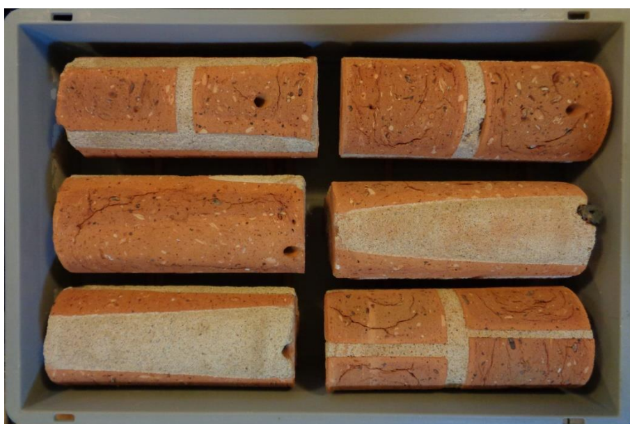
Fot. 5.15 Próbkki (rdzenie wiertnicze) podczas badania absorpcji kapilarnej (fot.: autor)
