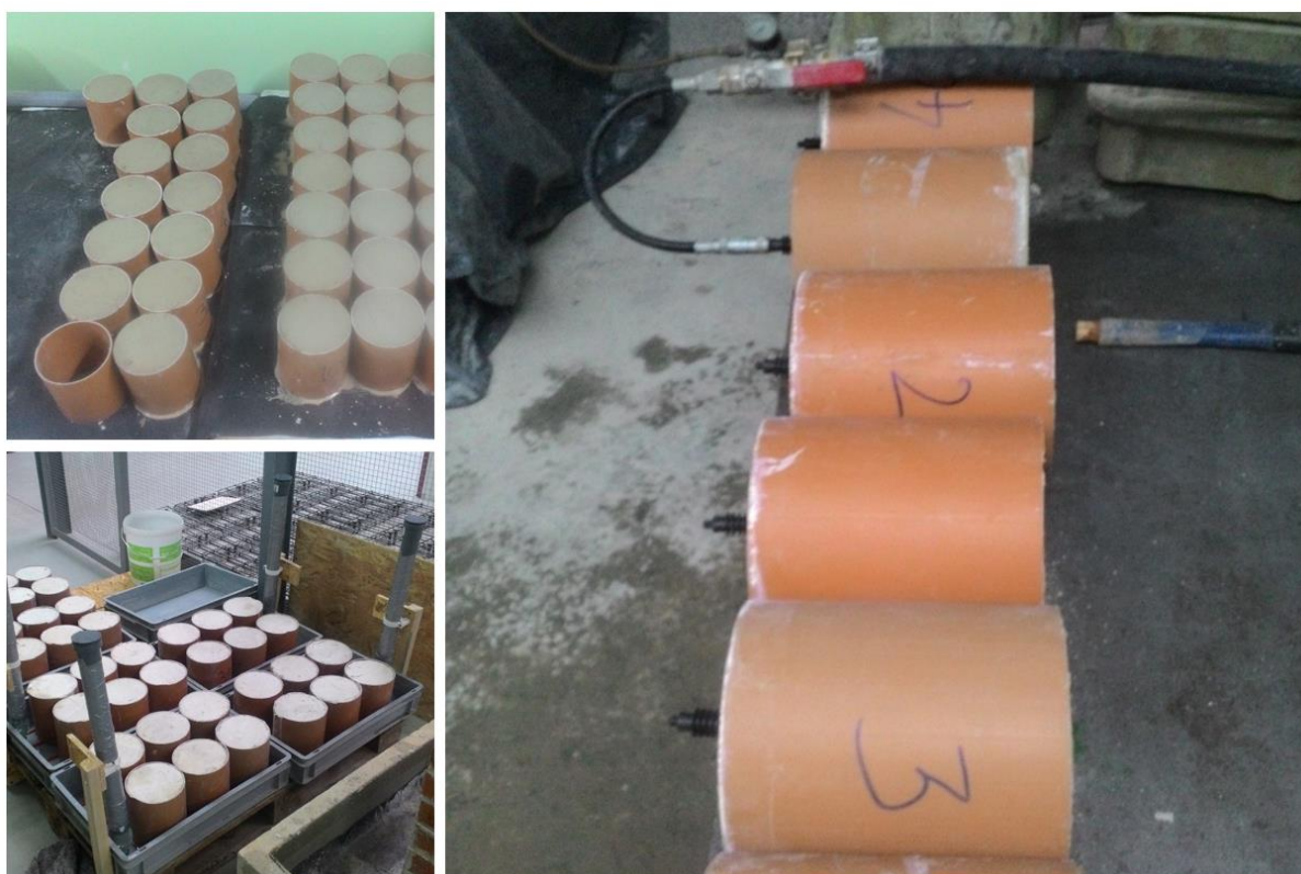
Fot. 5.9 Próbkę zaprawy podczas formowania, zawilgacania oraz przeprowadzania iniekcji (fot.: autor)
