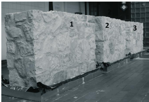
Fot. 5.5 Wzniesione do badań mury modelowe z opoki wapiennej (fot: [179])
