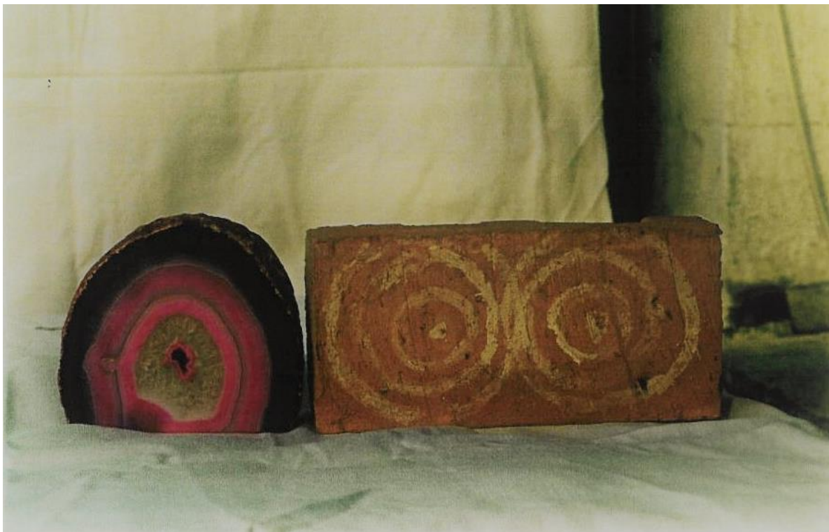
Fot. 4.1 Efekt iniekcji krystalicznej – współcentryczne pierścienie (fot.: [128])
