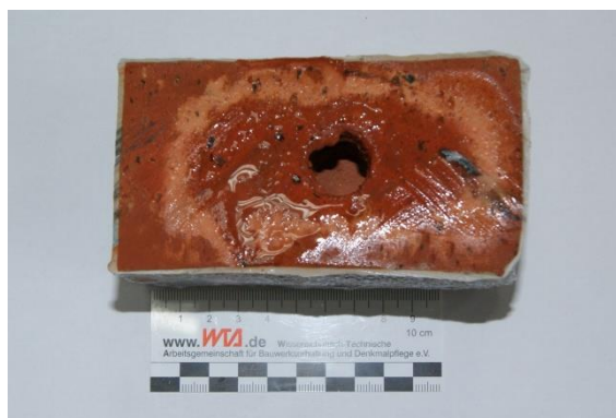
Fot. 5.8 Penetracja silanu (1:12 z wodą) przy S = 50% (fot.: autor)
