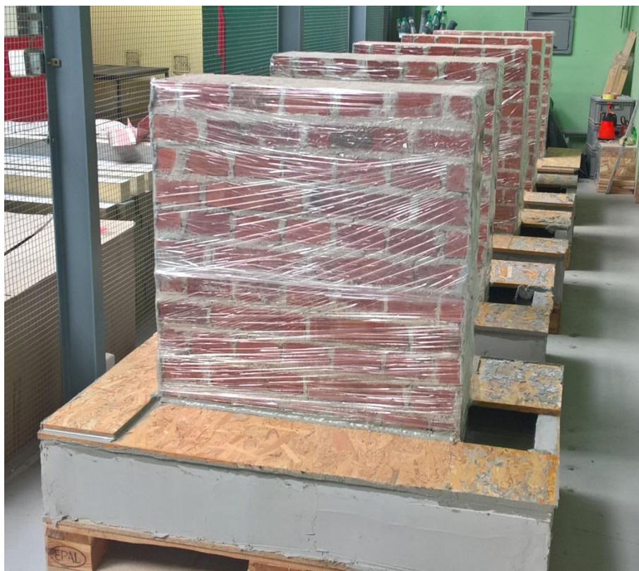
Fot. 5.12 Zawilgacanie kapilarne murów referencyjnych (fot.: autor)
