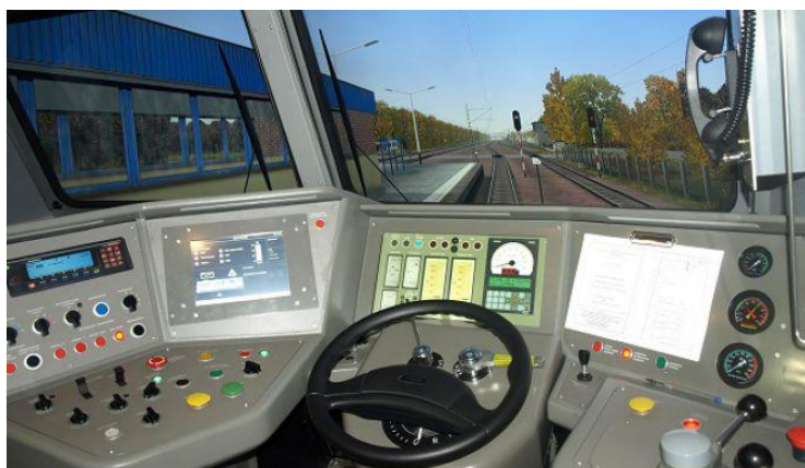
Rys. 1.7. Kokpit symulatora lokomotywy [96]
