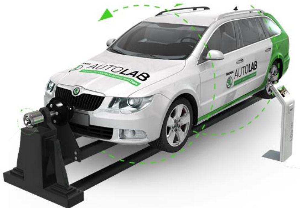
Rys. 1.6. Wizualizacja symulatora dachowania z ośrodka SKODA Auto Lab Poznań [107]
