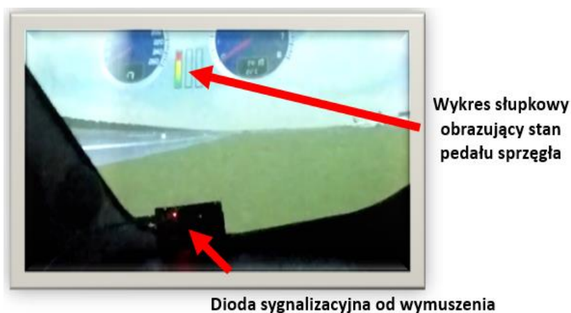
Rys. 5.60. Badanie opóźnienia zmiany ustawienia pedału sprzęgła z uwzględnieniem odpowiedzi wizualnego świata
