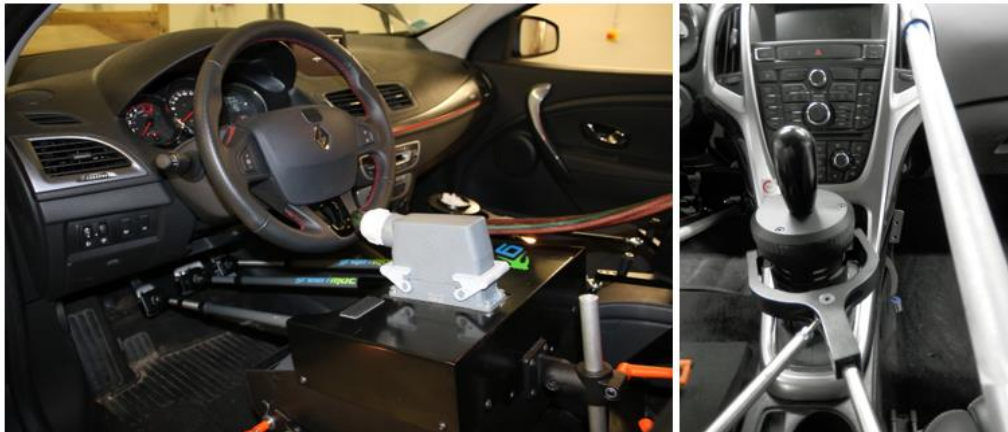
Rys. 4.1. Przykłady zamontowanego sztucznego kierowcy do realizacji badań [93]
