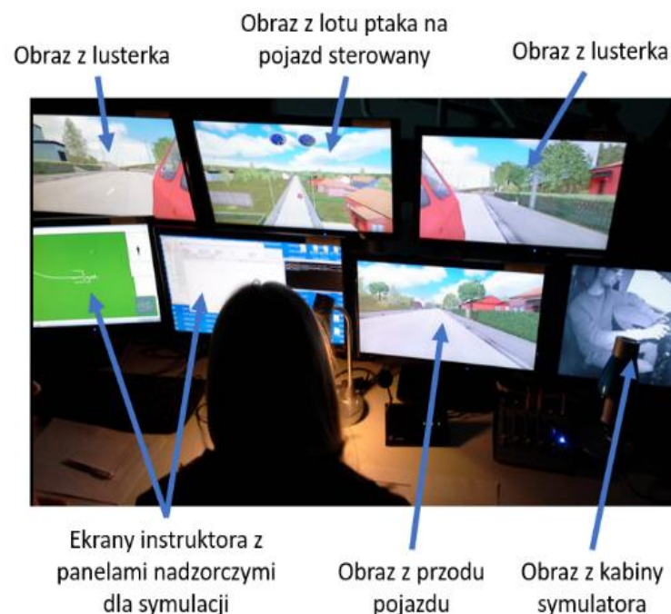
Rys. 3.3. Widok stanowiska sterującego symulatorem
