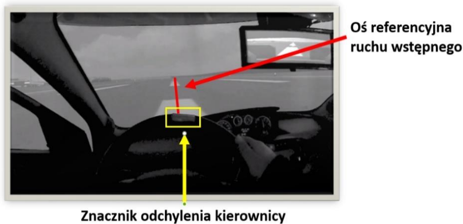
Rys. 5.58. Widok procedury badawczej wyznaczającej opóźnienie zmiany ustawienia kierownicy pojazdu wraz z odpowiedzią wizualnego świata
