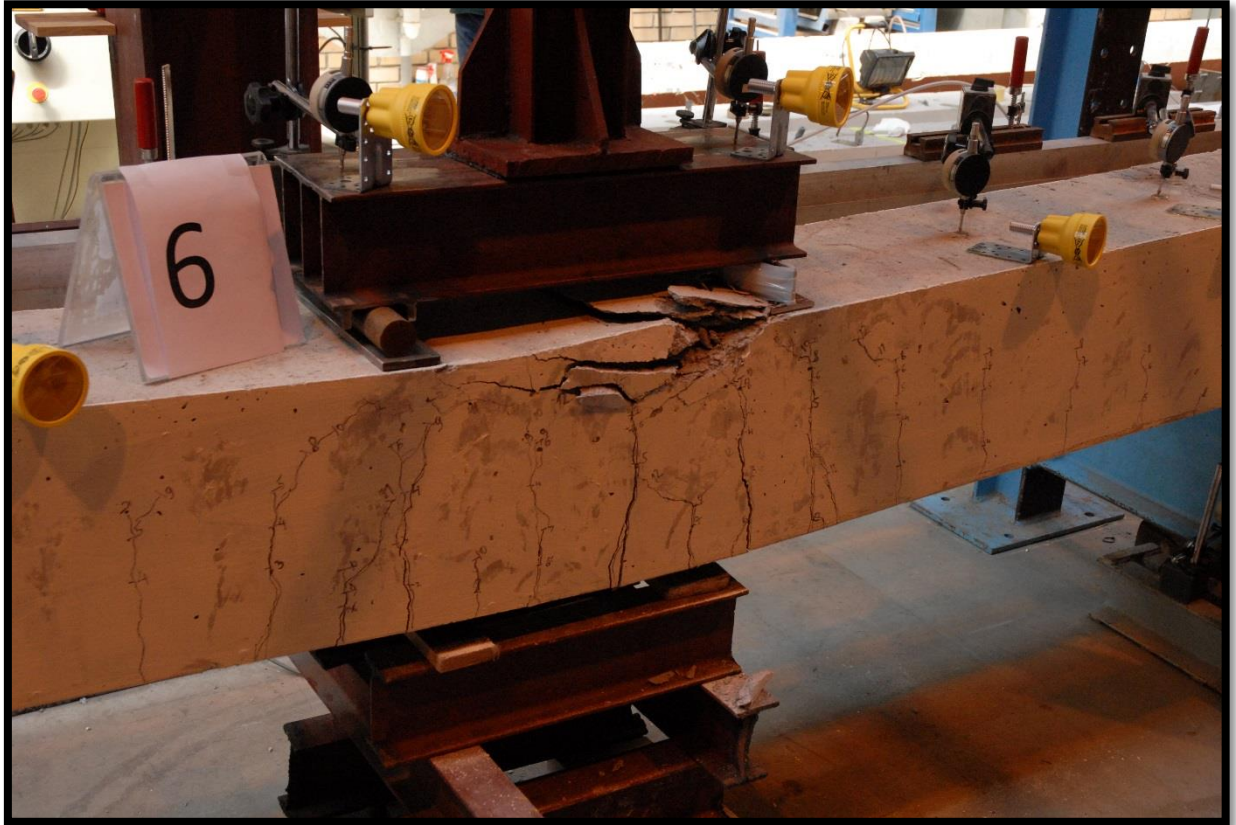
Fot. 5. 30 Belka nr 6 po osiągnięciu SGN
