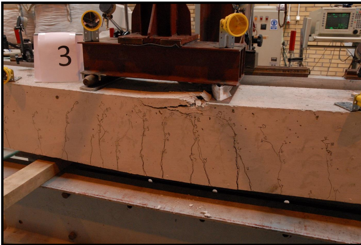
Fot. 5. 28 Belka nr 3 po osiągnięciu SGN
