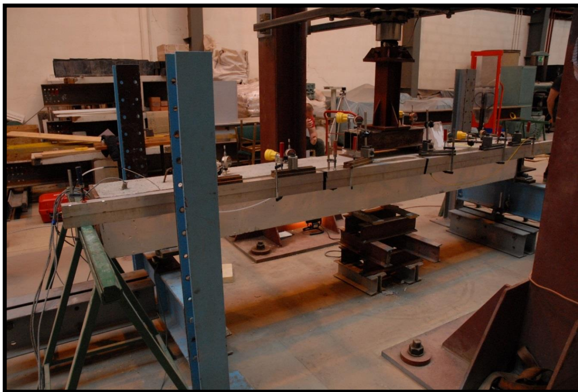
Fot. 5.10 Stanowisko podczas badania belek swobodnie podparych
