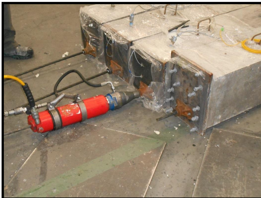
Fot. 5.9 Belki w czasie sprężania
