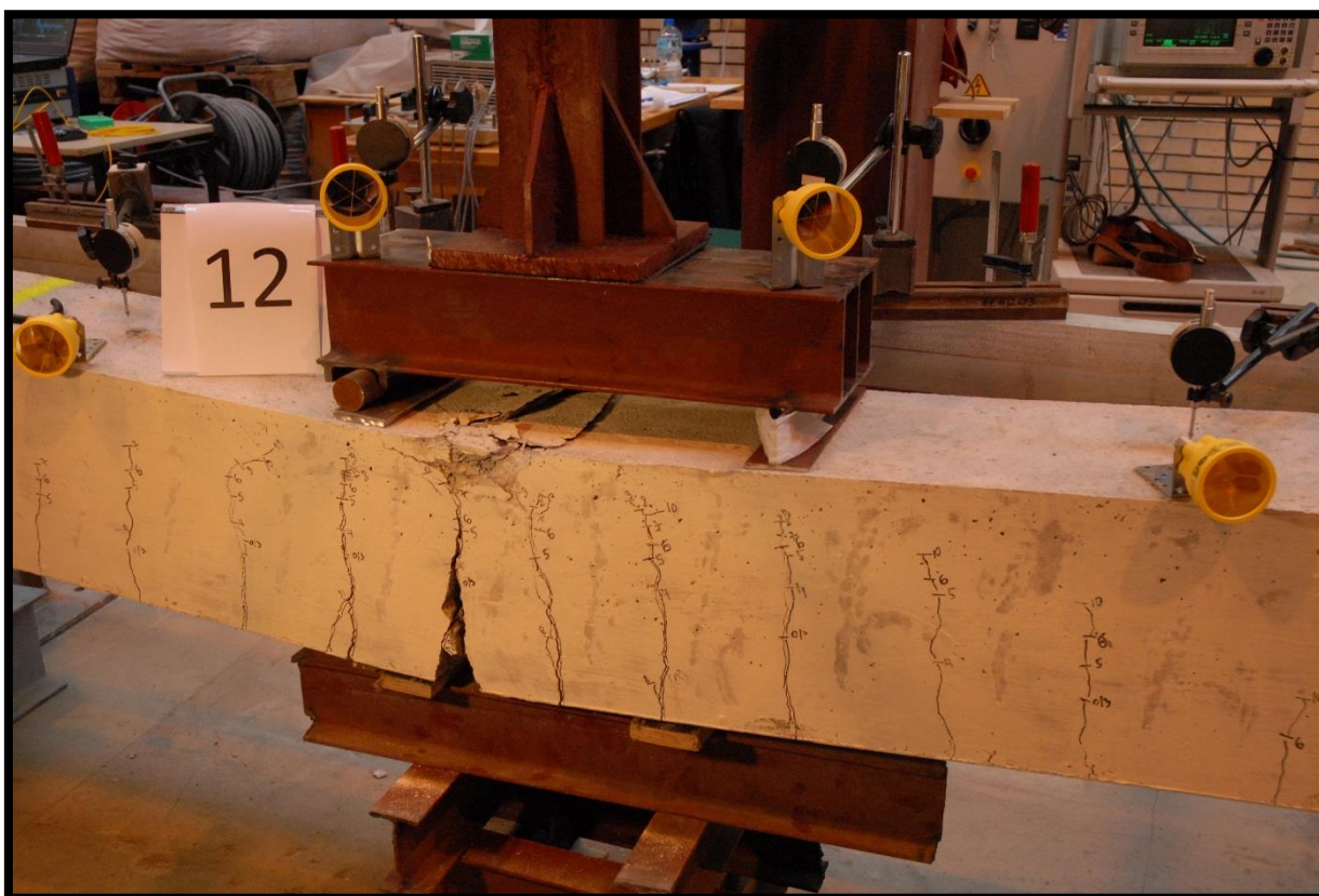
Fot. 5. 33 Belka nr 12 po osiągnięciu SGN
