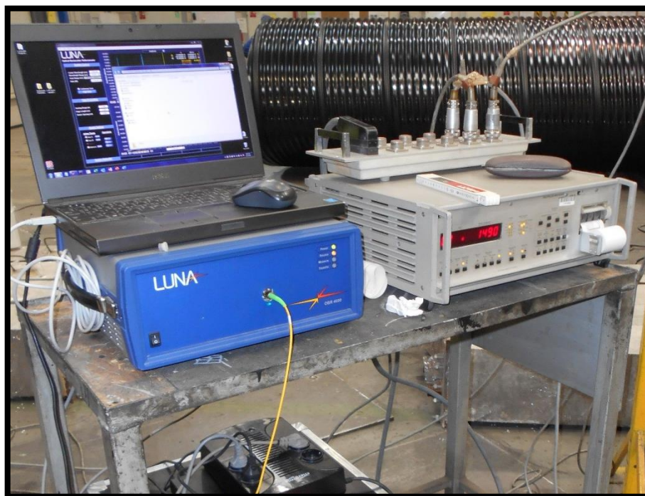
Fot. 5.21 Reflektometr optyczny LUNA oraz urządzenie HBM-UPM-60
