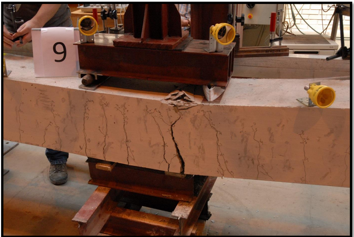
Fot. 5. 31 Belka nr 9 po osiągnięciu SGN
