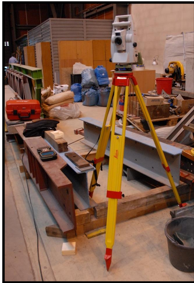
Fot. 5.25 Tachimetr do geodezyjnych pomiarów ugięć belek
