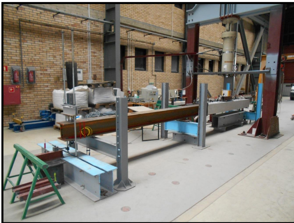
Fot. 5.11 Stanowisko podczas badania belek ciągłych
