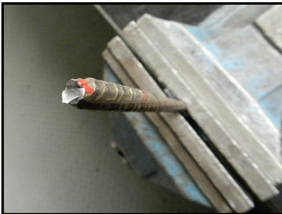
Fot. 5.7 Zerwany pręt zbrojeniowy
