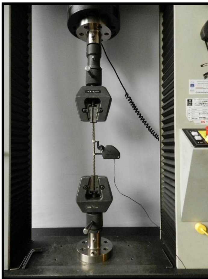
Fot. 5.6 Stal zbrojeniowa w czasie badania wytrzymałości na rozciąganie
