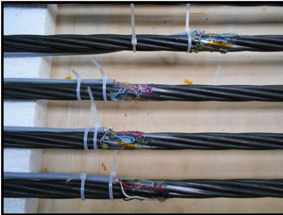
Fot. 5.17 Tensometry elektrooporowe umieszczone na splotach po zabezpieczeniu silikonem
