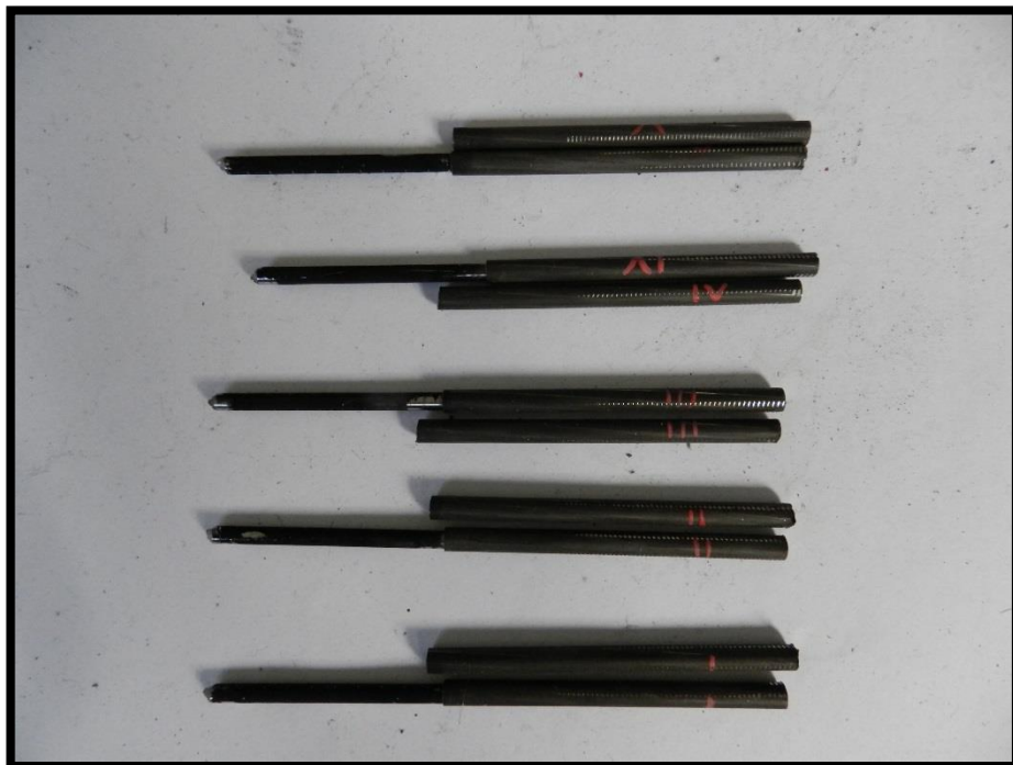
Fot. 5.8 Druty zerwane po badaniu
