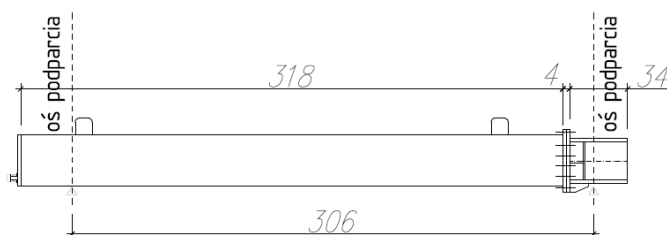
Rys. 5.2 Widok belki swobodnie podpartej
