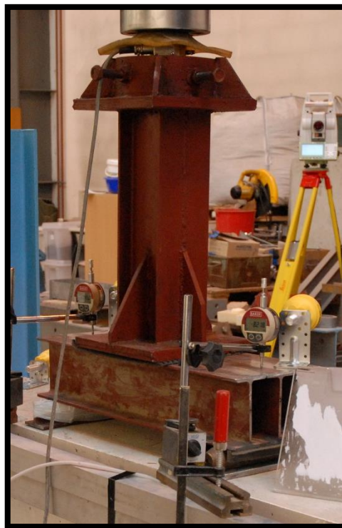
Fot. 5.13 Trawers do przekazywania siły z tłoka na belkę
