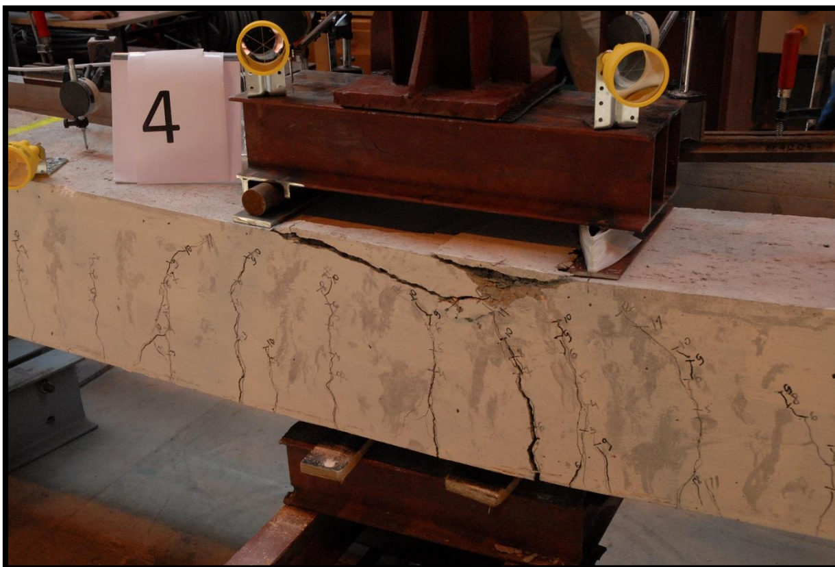
Fot. 5. 29 Belka nr 4 po osiągnięciu SGN
