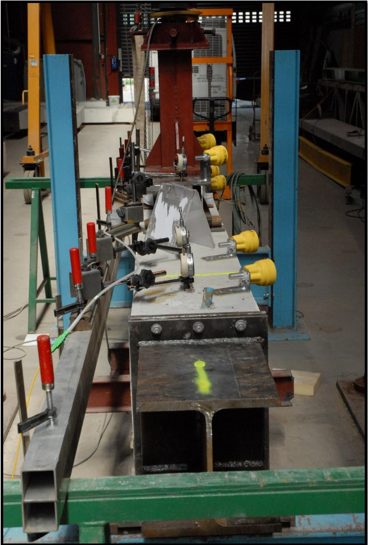
Fot. 5.26 Belka z zamontowanymi czujnikami do pomiarów ugięć
