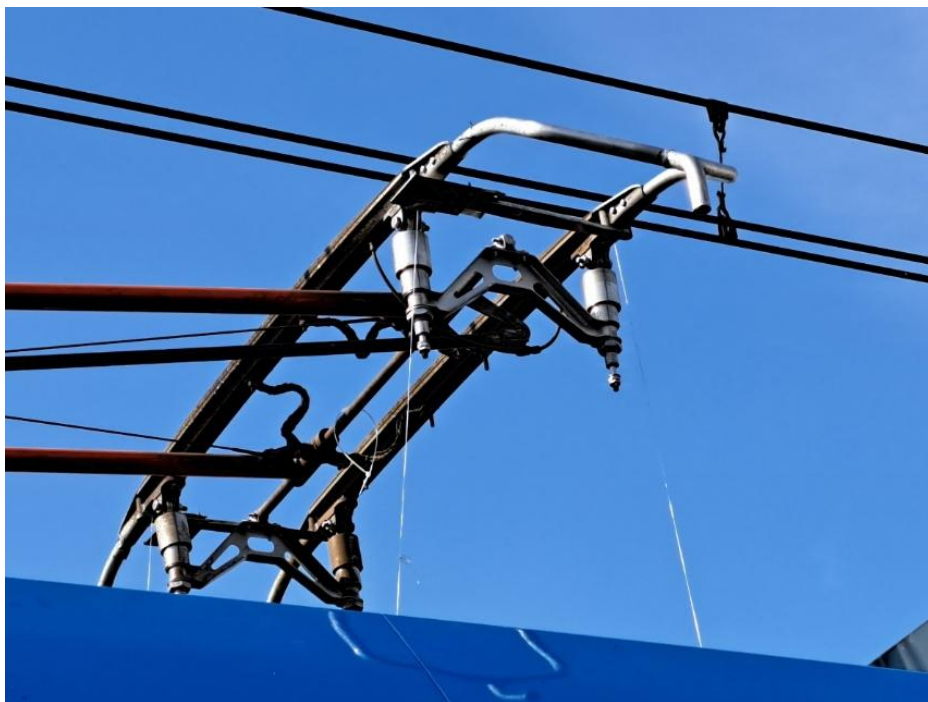
Rys. 10.5. Odbierak podczas pomiaru całkowitej średniej siły unoszącej F_s z widocznymi linkami uwiązującymi
