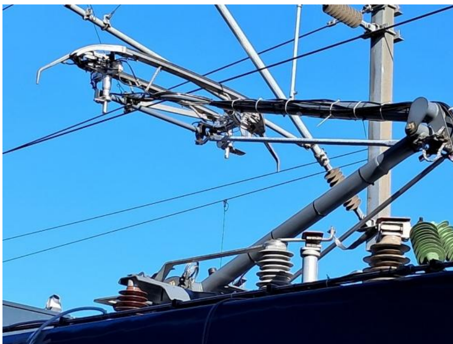
Rys. 10.6. Odbierak podczas jazdy – przykład konfiguracji obiektu objętego badaniami dynamicznymi
