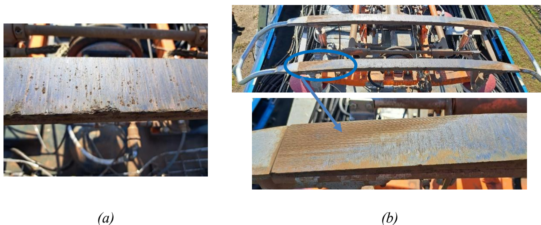
Rys. 2.4. Przykłady nierównomiernego zużycia nakładek ślizgowych: a) uszkodzenie związane z niewłaściwą siłą statyczną, b) miejscowe zużycie wynikające z nieprawidłowej integracji odbieraka z pojazdem
