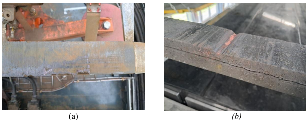
Rys. 2.5. Przykłady uszkodzeń nakładek związanych ze zjawiskami elektrycznymi: a) nadpalenia powierzchni wskutek występowania łuku elektrycznego, b) liniowe wypalenie nakładki
