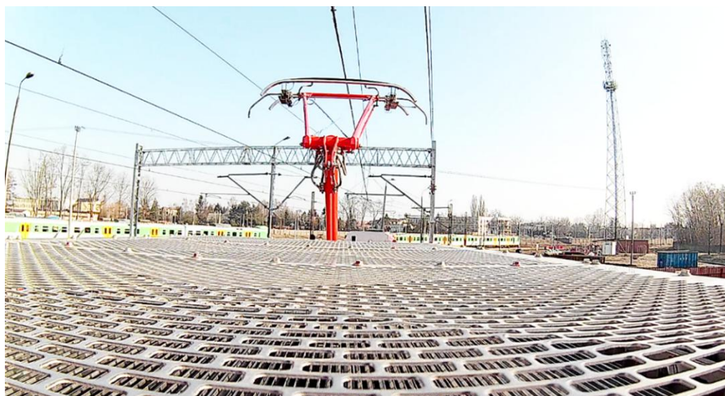
Rys. 11.2. Przykład obrazu z kamery dachowej podczas jazdy pojazdu z odbierakiem Panto300
