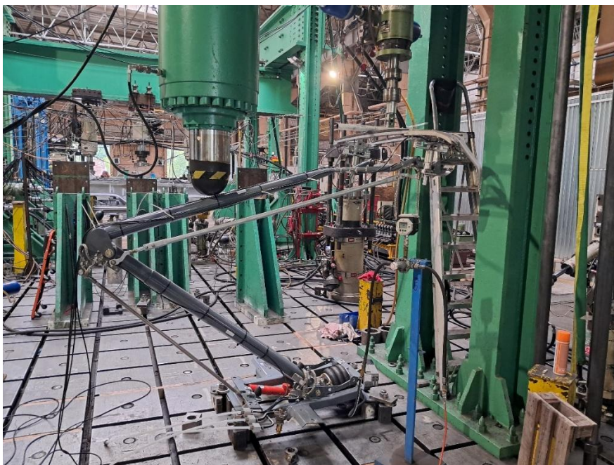
Rys. 10.2. Stanowisko laboratoryjne podczas badania właściwości dynamicznych oprzyrządowanego odbieraka
