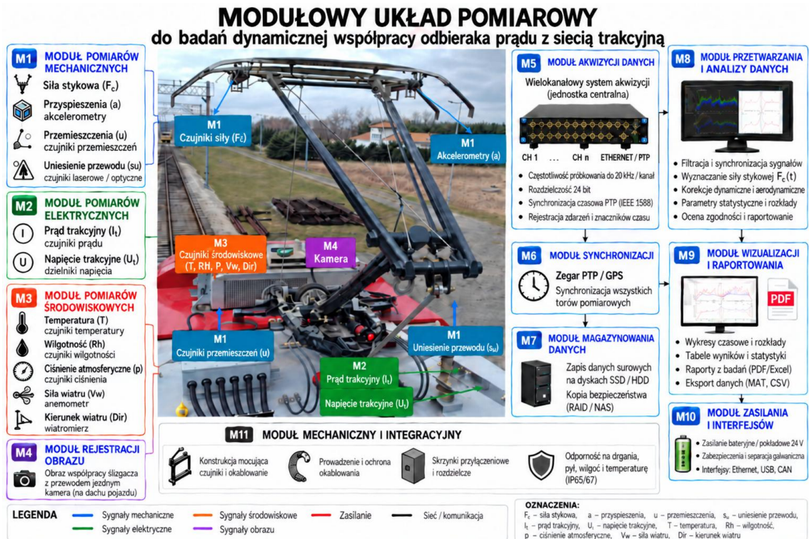
Rys. 4.1. Szczegółowa architektura modułowego układu pomiarowego
