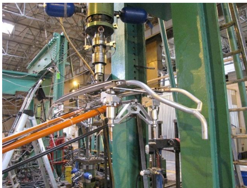
Rys. 10.3. Fragment głowicy odbieraka podczas laboratoryjnej realizacji wymuszenia
