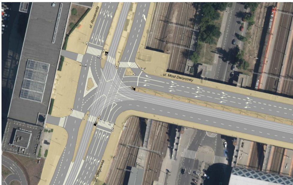
Rys. 62. Układ geometryczny skrzyżowania wraz z przyjętą organizacją ruchu – PDIII. Źródło: Opr. własne
