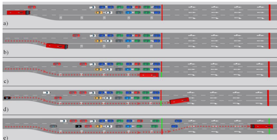
Rys. 7. Schemat działania służby autobusowej (przedsygnалу) na wlocie skrzyżowania. Źródło: Opr. własne
