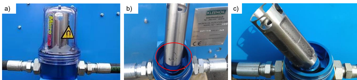
Rys. 2.8. Widok filtra magnetycznego z urządzenia MS2+MM5: a) przed filtracją w zamkniętej i przezroczystej obudowie, b) po filtracji z niewielkim zanieczyszczeniem, c) po filtracji z zanieczyszczeniem na większości powierzchni [62]
