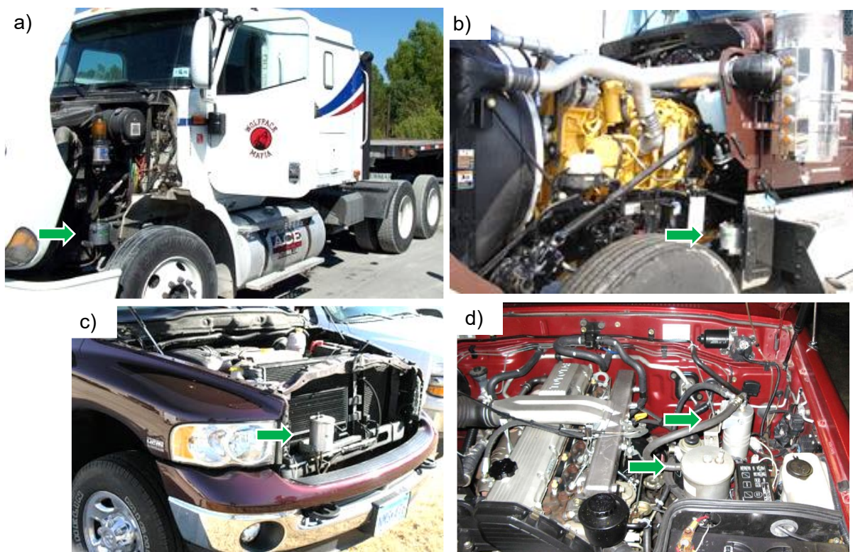
Rys. 7.2. Widok indywidualnie montowanych instalacji Kleenoil do bocznikowej mikrofiltracji a), b) oleju silnikowego w samochodzie ciężarowym, c) paliwa (Kleenfuel) w samochodzie pick-up, d) instalacji paliwa (Kleenfuel) i smarowania (Kleenoil) w Toyota Land Cruiser z silnikiem Diesla 4,2 l [96]
