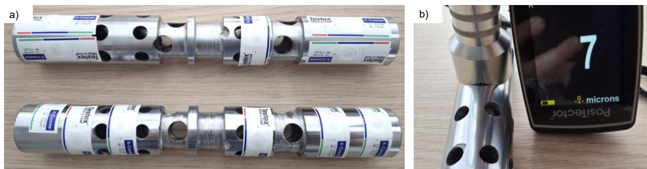
Rys. 6.4. Widok a) suwaków rozdzielaczy hydraulicznych z naklejonymi taśmami replikacyjnymi RTXC Testex, b) sondy profilu cylindrycznego PRBSPGOS-B podczas pomiaru
