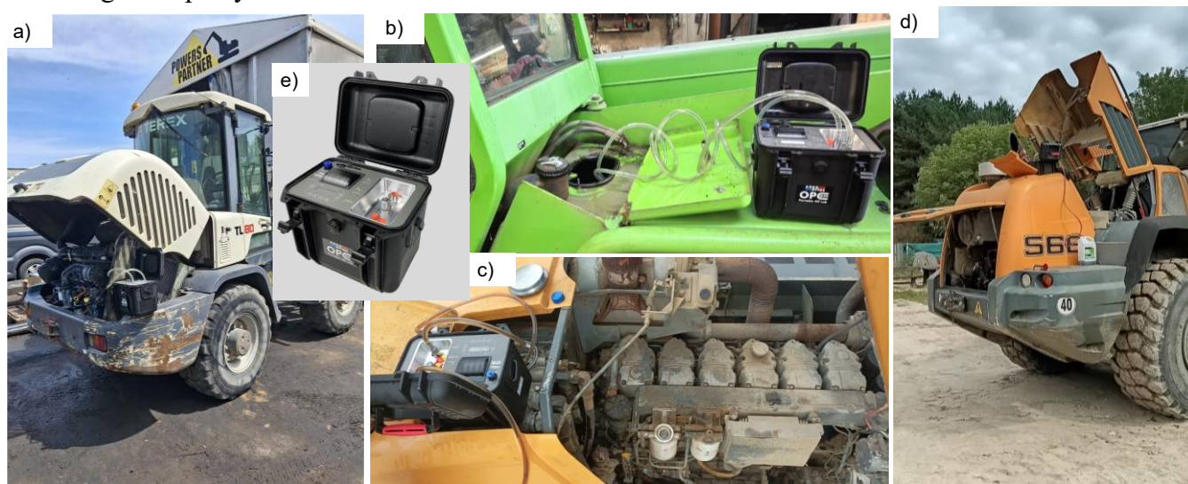
Rys. 7.8. Widok z badania okresowego oleju na klasę czystości i wilgotność względną na e) przenośnym laboratorium OPCOMII Portable Oil Lab PPCO 300-1000 firmy ArgoHytyos ładowarek kołowych: a) Terex TL80, b) Merlo EWVS 35/15, c), d) Liebherr L 566 [fot. S. Kołodziejski]
