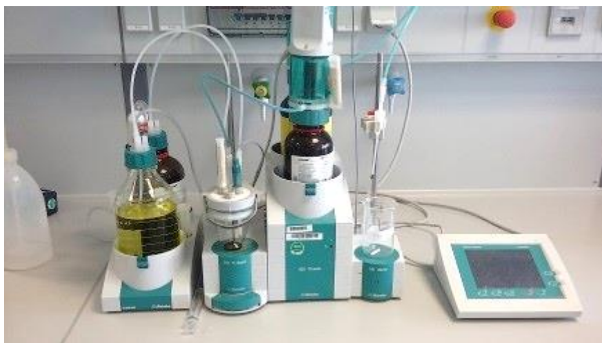
Rys. 2.15. Widok urządzenia do badania zawartości wody w oleju hydraulicznym metodą Karla Fischera [109]
