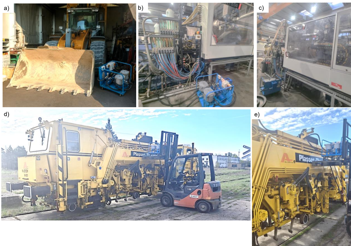
Rys. 7.1. Widok zastosowania stanowiska Kleenoil MS2+MM5 do mikrofiltracji oleju hydraulicznego w: a) ładowarce kołowej Liebherr 566, b), c) wtryskarce Billion H3500/550, d), e) podbijarce podbijarki torów i rozjazdów typu 08-275 ZW [fot. S. Kołodziejski]
