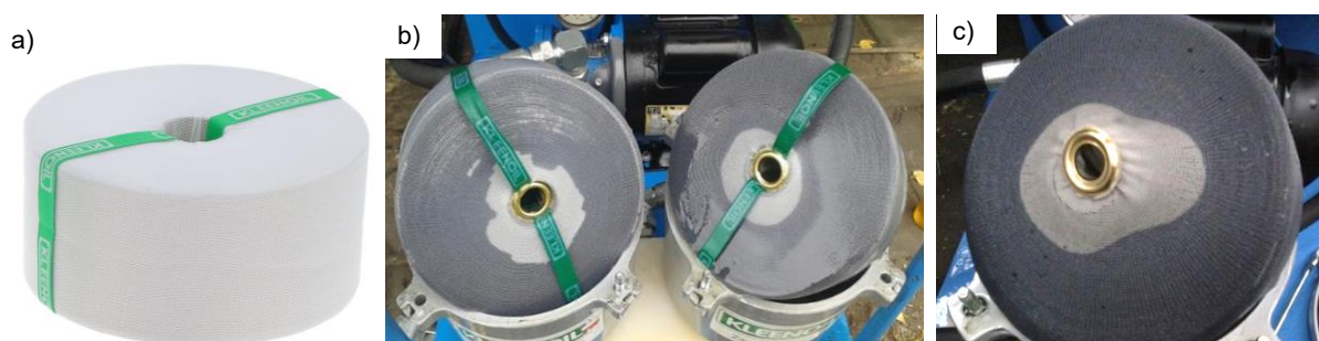
Rys. 2.7. Widok wkładów filtracyjnych firmy Kleenoil: a) nowy filtr [104], b), c) wkłady zanieczyszczone w różnym stopniu [105]
