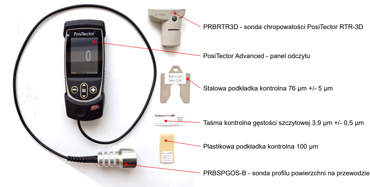
Rys. 6.2. Widok miernika profilu powierzchni PosiTector SPG wraz z wyposażeniem [fot. S. Kołodziejski]
