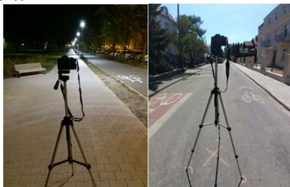
Ryc.58. Wykonywanie pomiarów: zdjęć porównawczych w dzień i w nocy oraz pomiarów luminancji za pomocą miernika matrycowego LMK. Fot. P. Ratajkiewicz.
