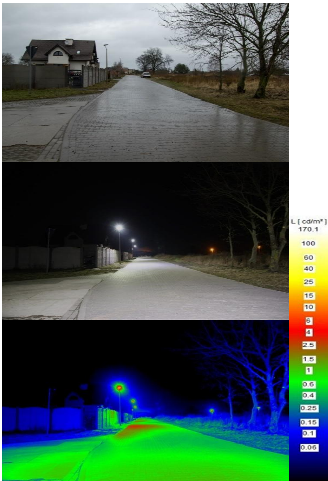
Ryc.60. Przykładowy zapis tej samej lokalizacji w ujęciu dziennym, nocnym i pomiarem luminancji. Na zdjęciu: ul. Ogrodowa w Świnoujście. Fot. P. Ratajkiewicz. Opracowanie własne.
