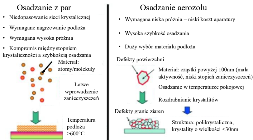
Rysunek 10: Porównanie metod wytwarzania cienkich warstw metodą osadzania z par i metodą osadzania aerozolu [46]
