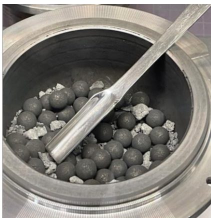
Rysunek 21: Wnętrze misy mielącej po reakcji egzotermicznej
