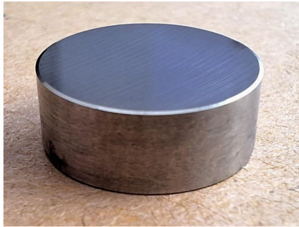
Rys. 52. Prototyp płytki skrawającej typu RNGN1204T01220 wykonanej z opracowanego materiału WC-Ti
