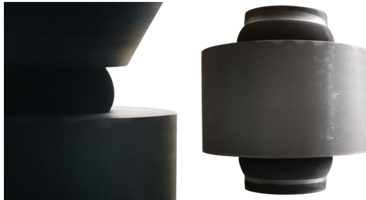
Rys. 32. Przykładowe spęczenie stempli na skutek lokalnego przegrzania podczas procesu prowadzonego z maksymalną szybkością nagrzewania
