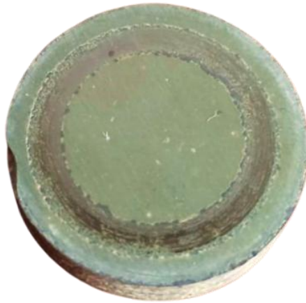
Rys. 51. Powierzchnia próbki WC-5Ti po teście tribologicznym przeprowadzonym w temperaturze 700^{\circ}C
