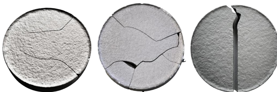
Rys. 36. Przykłady próbek pękniętych podczas procesu spiekania
