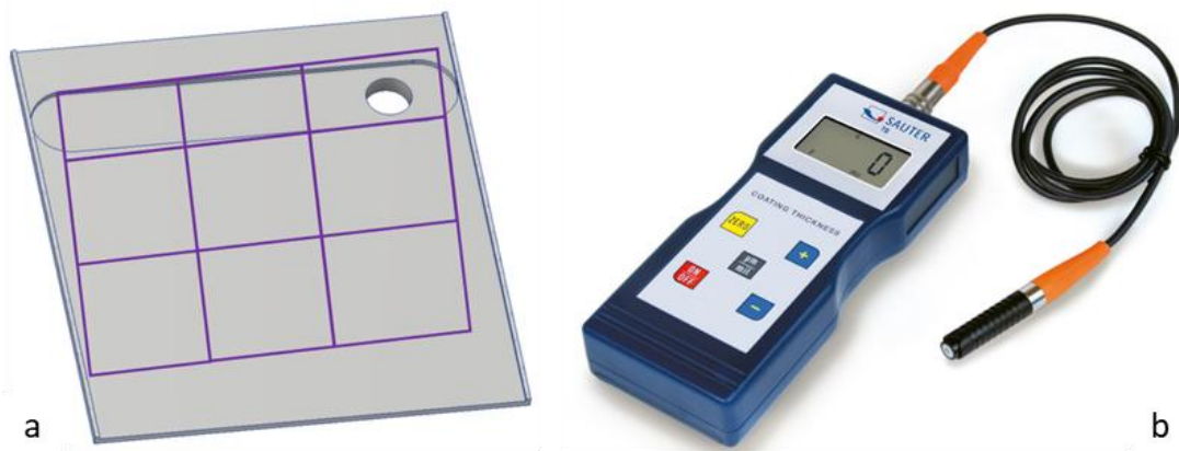
Rysunek 4.6. a) obszary pomiaru grubości warstwy topnika na pokrywie (opracowanie własne), b) warstwowierz TB 1000-0.1 FN [139]
