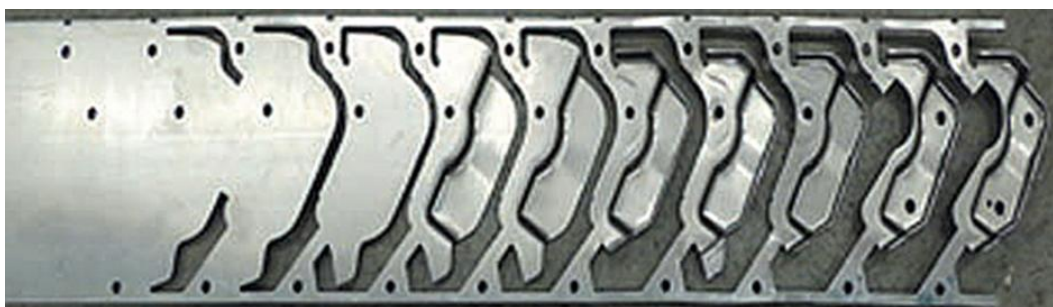
Rysunek 2.3. Wytłoczka 12 kształtowana w tłoczniiki progresywnej [50]
