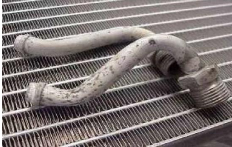
Rysunek 2.21. Korozja na komponentach aluminiowych po procesie lutowania (opracowanie własne)
