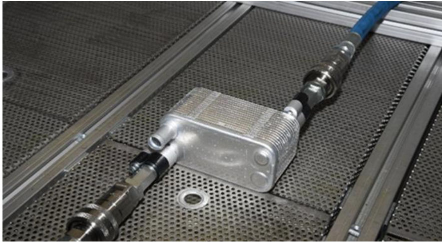
Rysunek 2.25. Test rozrywania aluminiowej chłodnicy w komorze rozrywającej [111]
