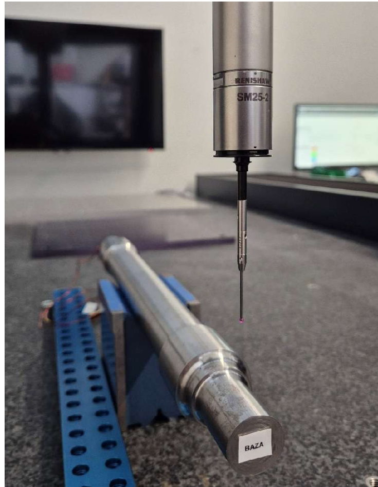
Rys.8.20. Pomiary na maszynie współrzędnościowej Wenzel
