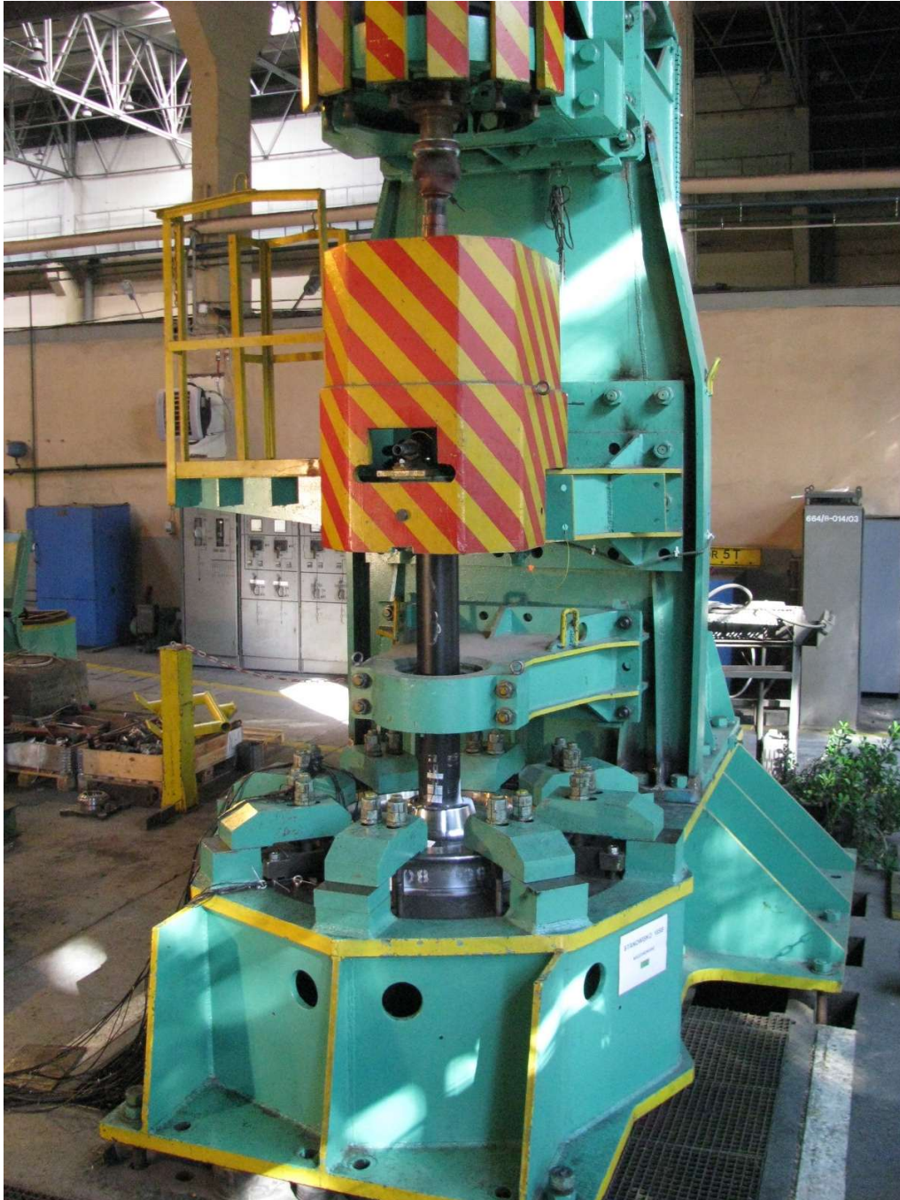
Rys.6.1. Widok maszyny zmęczeniowej do badań osi i kół zestawów kołowych
