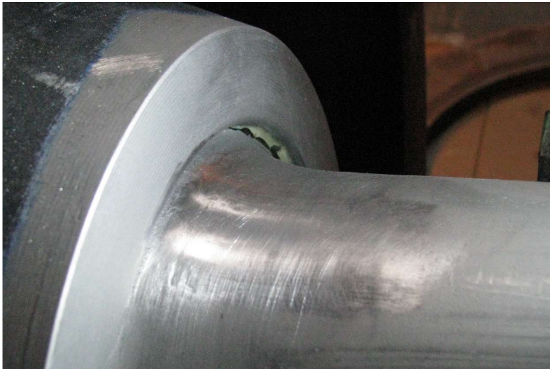
Rys. 6.9. Zdjęcie przedstawiające luz powstały w piastce koła na skutek wykręcania się osi.
