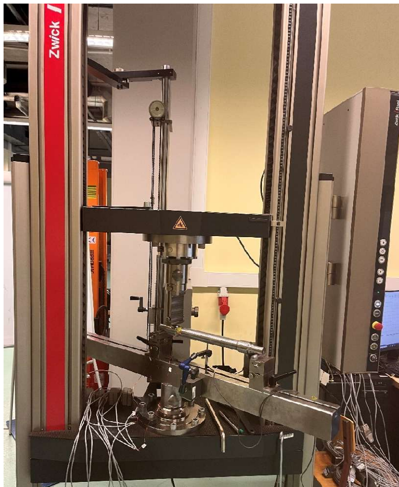
Rys.8.2. Maszyna wytrzymałościowa ZWICK/Roell Z100
