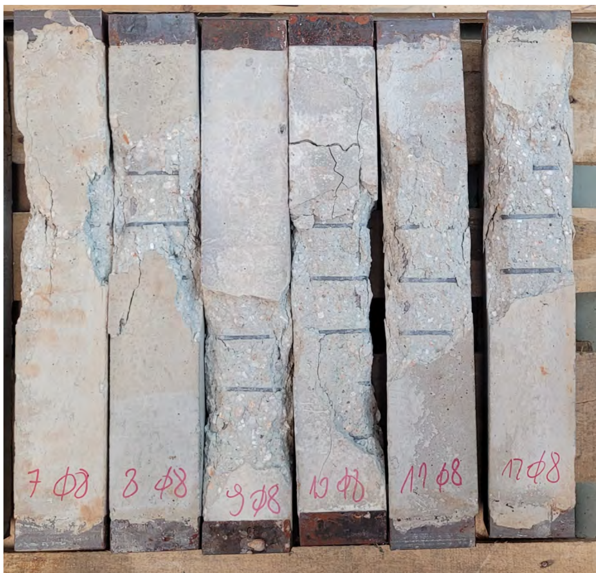
Rysunek 5.5: Próbkki zniszczone po wcześniejszym ich ogrzaniu bez obciążenia, ustawione do zdjęcia zniszczonymi stronami. Źródło własne.
