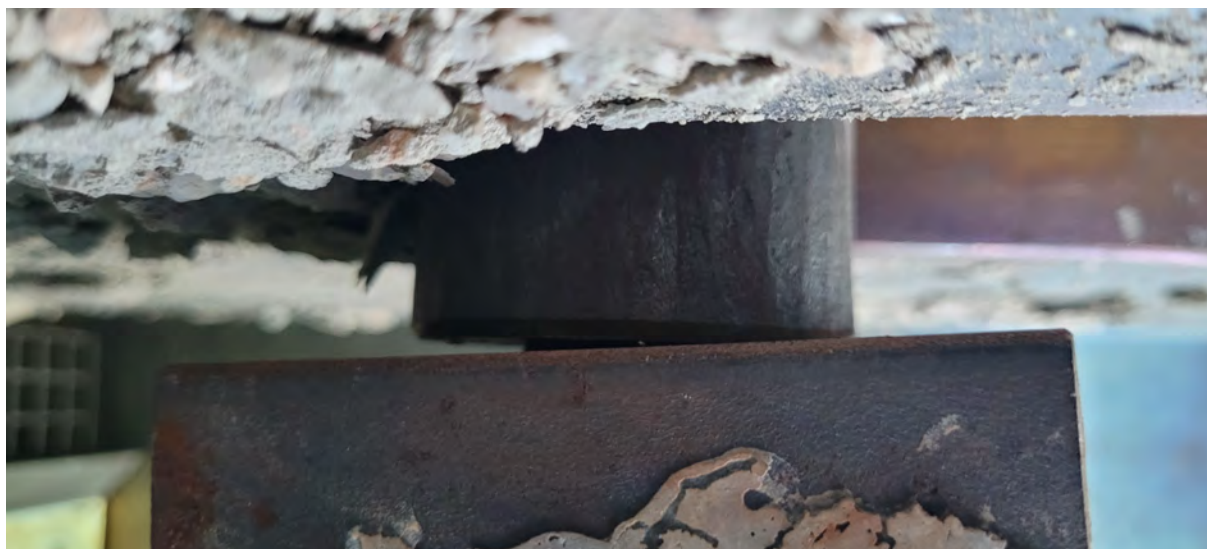
Rysunek 5.19: Próbką 25.8 w warunkach chłodzenia - widoczna zmiana schematu statycznego poprzez oparcie próbki na walcu. Źródło własne.
