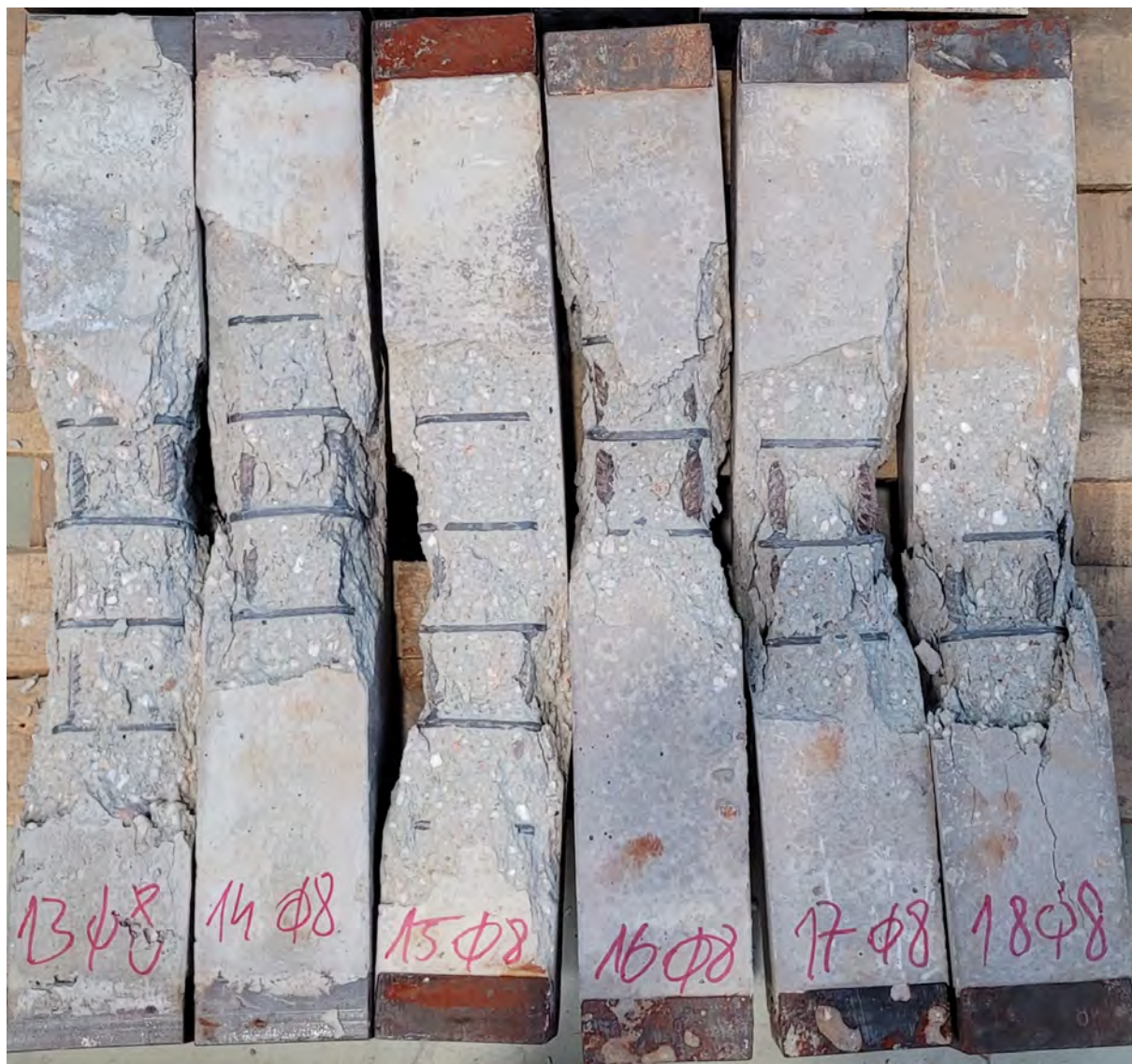
Rysunek 5.8: Próbki zniszczone po wcześniejszym ich obciążeniu a następnie ogrzaniu, ustawione do zdjęcia zniszczonymi stronami. Źródło własne.
