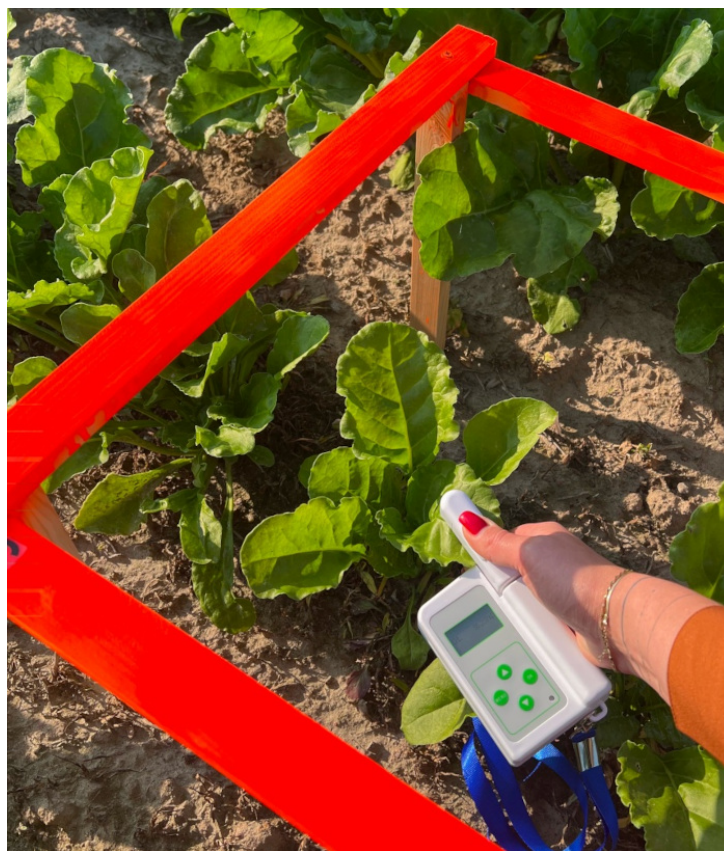
Rys. 22. Fotografia przedstawiająca wykonywany pomiar na obszarze badawczym nr 2 przy wykorzystaniu miernika SPAD
