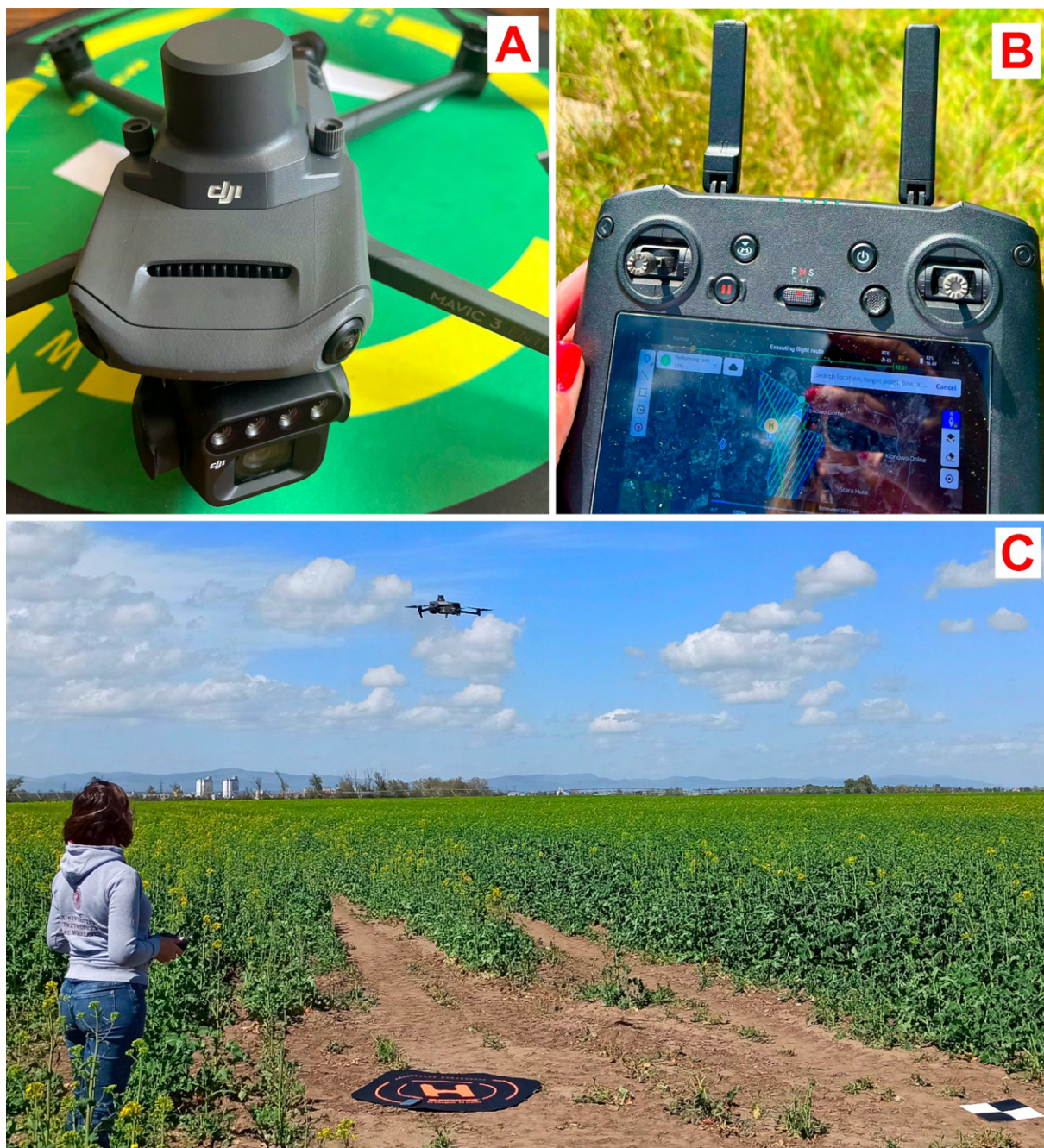
Rys. 20. Fotografia przedstawiająca wykorzystany w badaniach BSP - DJI Mavic 3 Multi-spectral (A - widok na sensory optyczne oraz moduł RTK; B - widok na kontroler w trakcie wykonywania misji pomiarowej, C - widok w trakcie nalotów badawczych na Słowacji)
