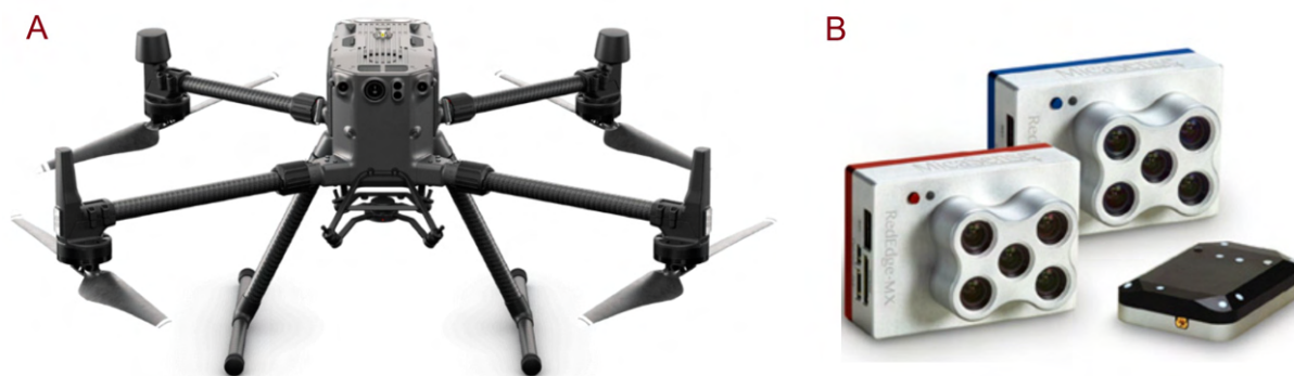
Rys. 19. Fotografia przedstawiająca BSP - DJI Matrice 300 RTK (A) oraz system multispektralny z dwoma kamerami wraz z czujnikiem światła skierowanym w dół - Micasense RedEdge-MX (B) [159]
