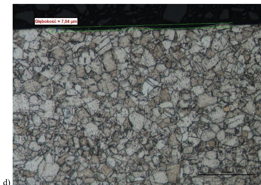
Rys. 6.61. Mikrostruktura warstwy wierzchniej powierzchni uzyskanych w wyniku obróbki ostrzem: a) KCS10B, b) WSM01, c) MP9005, d) S205, e) IC804 w oprawce o wysięgu 700 mm w początkowym etapie obróbki
