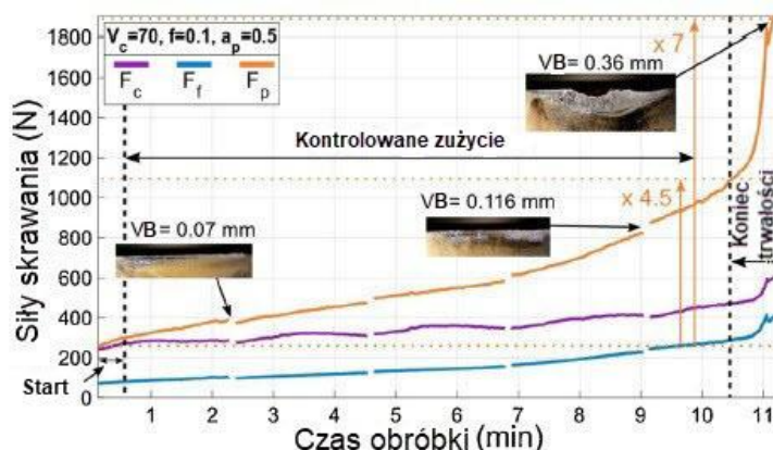
Rys. 2.40. Ewolucja składowych siły skrawania w czasie trwałości narzędzia przy v_c = 70 m/min, f = 0,1 mm/obr, a_p = 0,5 mm [49]
