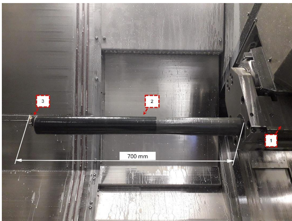
Rys. 4.3. Zestaw narzędziowy przeznaczony do obróbki powierzchni wewnętrznych, podczepiony pod głowicą narzędziową: 1 – adapter pryzmatyczny, 2 – trzonek wytaczaka z tłumikiem drgań, 3 – głowiczka narzędziowa ze złączem SL
