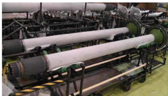
Rys. 2.10. Wał główny silnika i turbiny niskiego ciśnienia [34].
