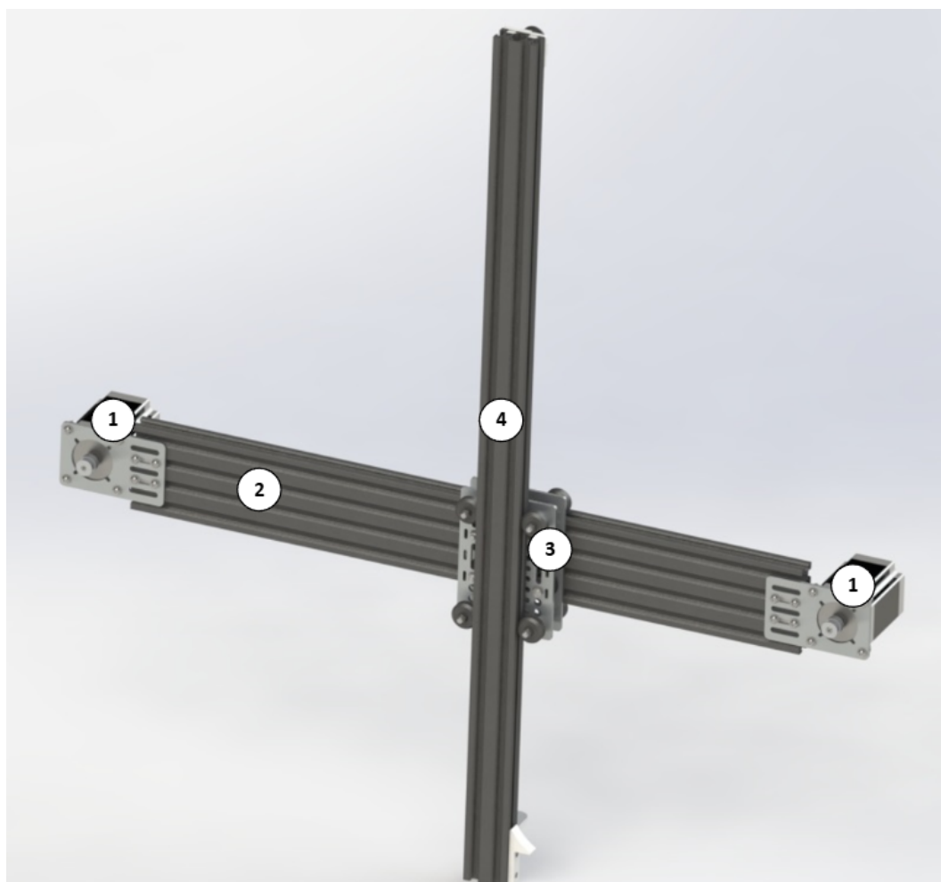
Rysunek 4.5: Model CAD 3D układu pracującego w międzyrzędziu. 1 – silnik krokowy, 2 – oś pozioma, 3 – wózek, 4 – oś pionowa
