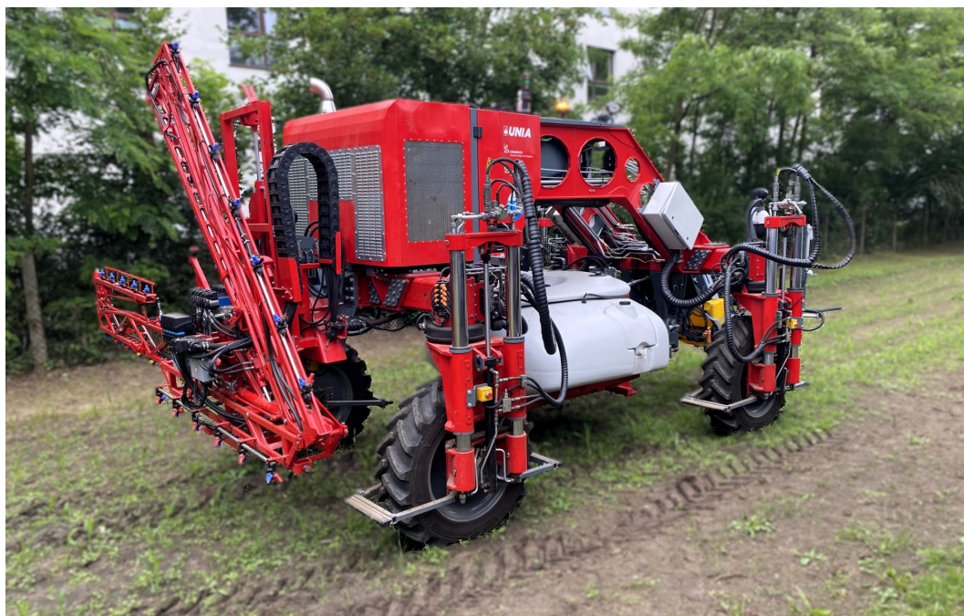
Rysunek 5.18: Robot z zamontowanym standardowym opryskiwaczem rolniczym przystosowany do montażu na robocie rolniczym
