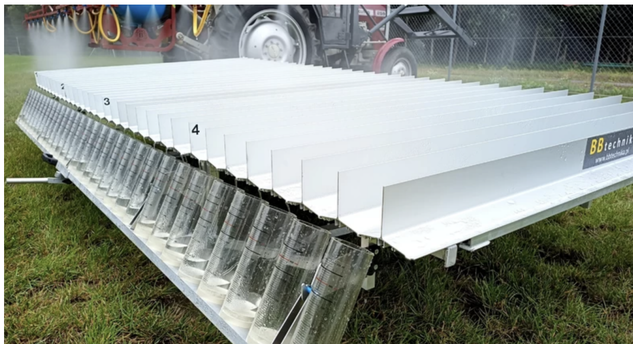
Rysunek 2.5: Stół rowkowy do pomiaru jednorodności rozkładu cieczy [69]
