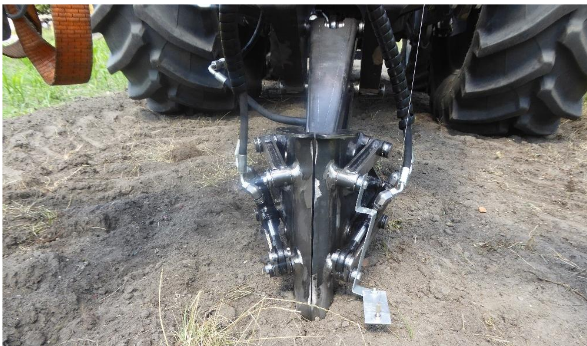
Rys. 7.6. Narzędzie z ostrzem klinowym zagłębione w glebie z zamkniętymi szczękami [opracowanie własne]
