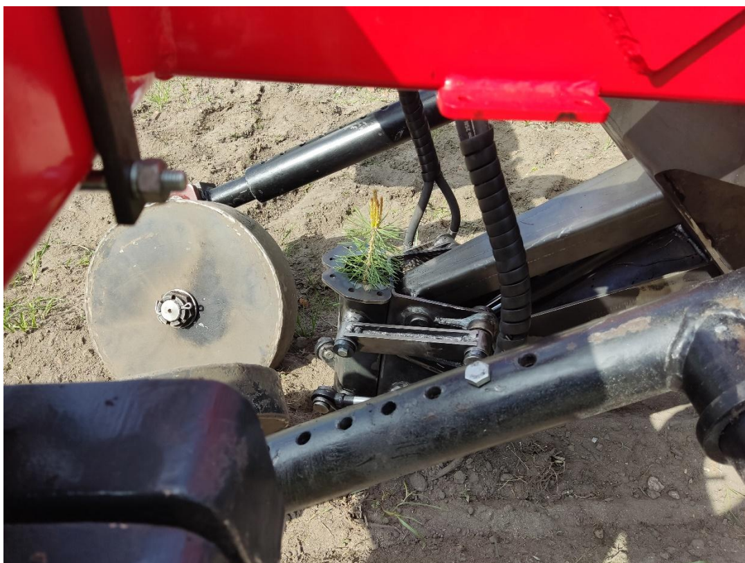
Rys. 7.28. Narzędzie z ostrzem klinowym zagłębione w glebie wraz z sadzonką sosnową umieszczoną wewnątrz, widok z boku [opracowanie własne]
