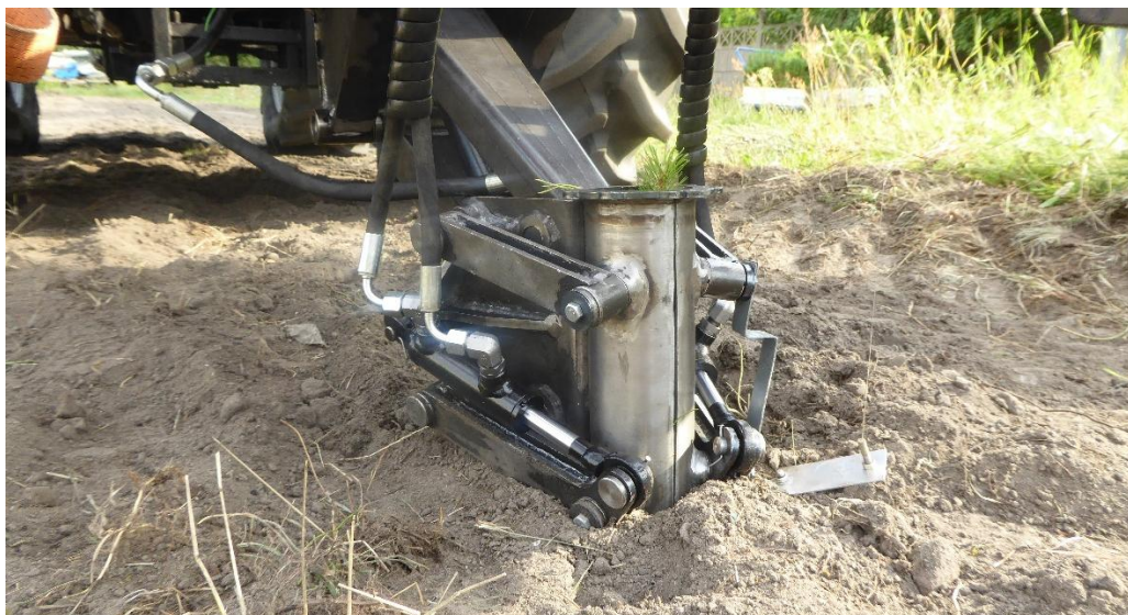
Rys. 7.10. Narzędzie z ostrzem stożkowym zagłębione w gruncie z zamkniętymi szczękami [opracowanie własne]
