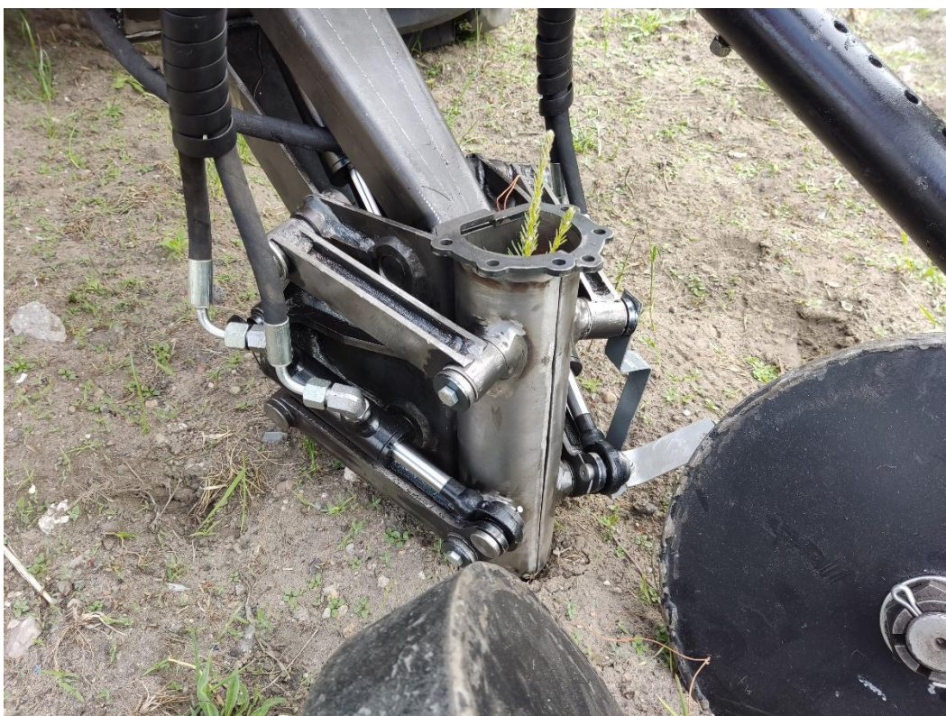
Rys. 7.20. Narzędzie sadzące z ostrzem stożkowym zagłębione w glebie, widok z profilu z sadzonką sosnową wewnątrz narzędzia [opracowanie własne]
