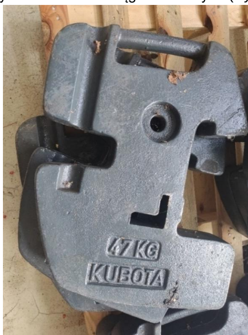
Rys. 4.28. Obciążenie ciągnika marki Kubota o masie 47 kg zastosowane podczas prowadzenia badań [opracowanie własne]
