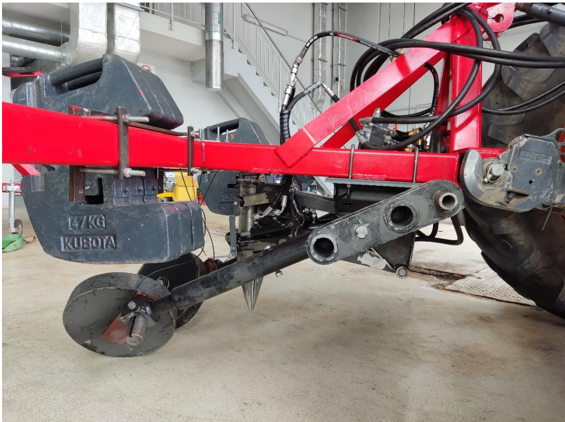
Rys. 7.17. Narzędzie sadzące zamontowane na ramie pośredniej wraz z kołami dociskowymi, widok z profilu [opracowanie własne]
