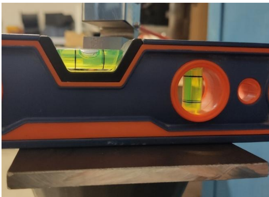
Rys. 7.2. Wypoziomowana płyta dociskowa przyłożona do kołnierza narzędzia sadzącego [opracowanie własne]
