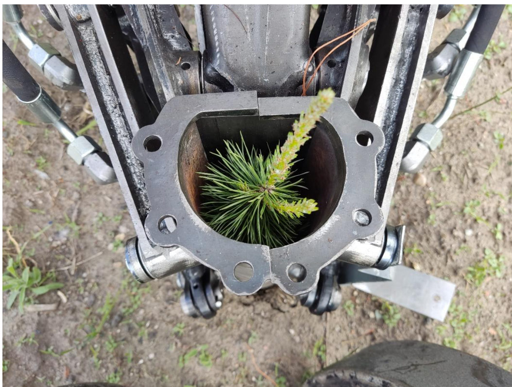
Rys. 7.21. Narzędzie sadzące z ostrzem stożkowym zagłębione w glebie, widok z góry z sadzonką sosnową wewnątrz narzędzia [opracowanie własne]
