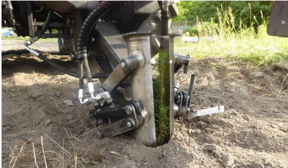
Rys. 7.11. Narzędzie z ostrzem stożkowym w momencie otwierania szczęk i wysadzania sadzonki sosnowej, widok od frontu [opracowanie własne]
