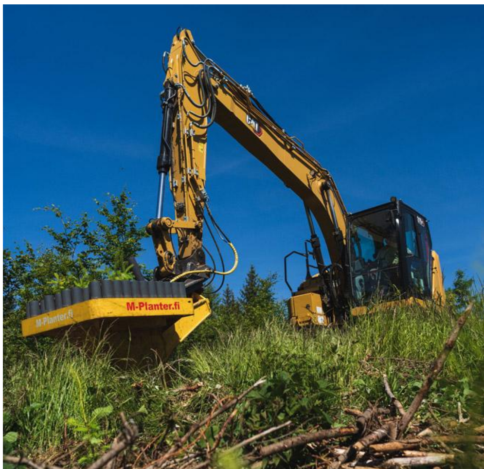
Rys. 2.29. Sadzarka M-Planter zamocowana na wysięgniku koparki w chwili sadzenia sadzonki w ziemi [129]
