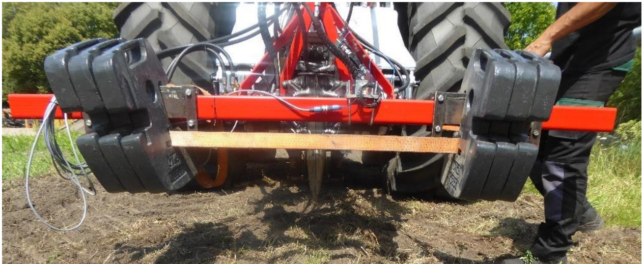
Rys. 7.4. Narzędzie z ostrzem klinowym zamocowane na ramie pośredniej wraz z obciążnikami [opracowanie własne]
