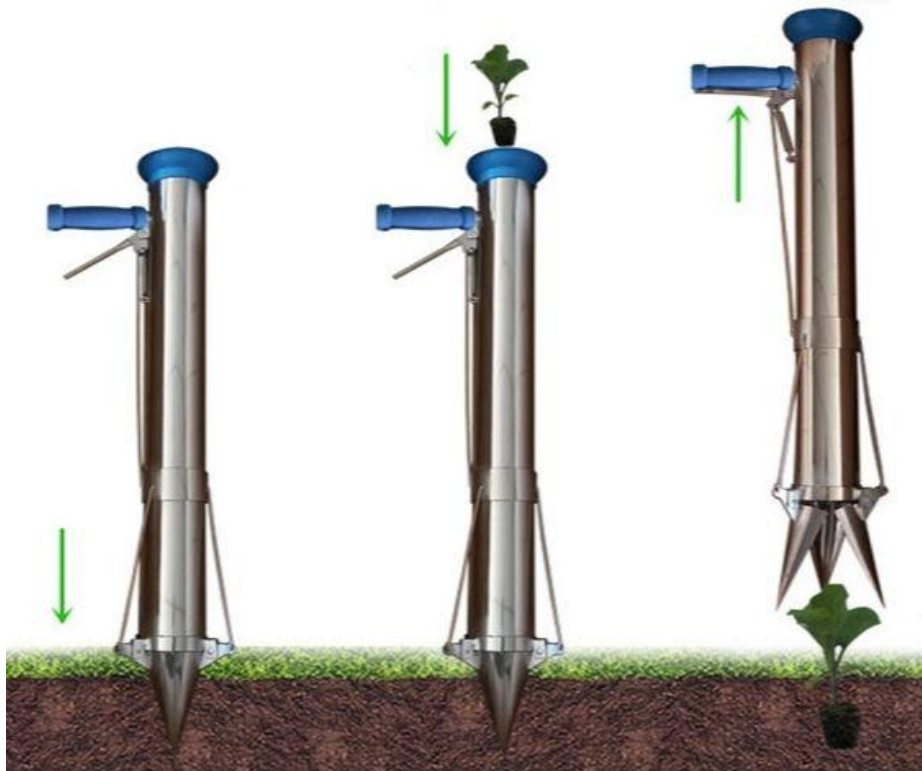
Rys. 2.3. Przykład ręcznego kostura stosowanego do sadzenia drzewek Błąd! Nie można odnaleźć źródła odwołania.
