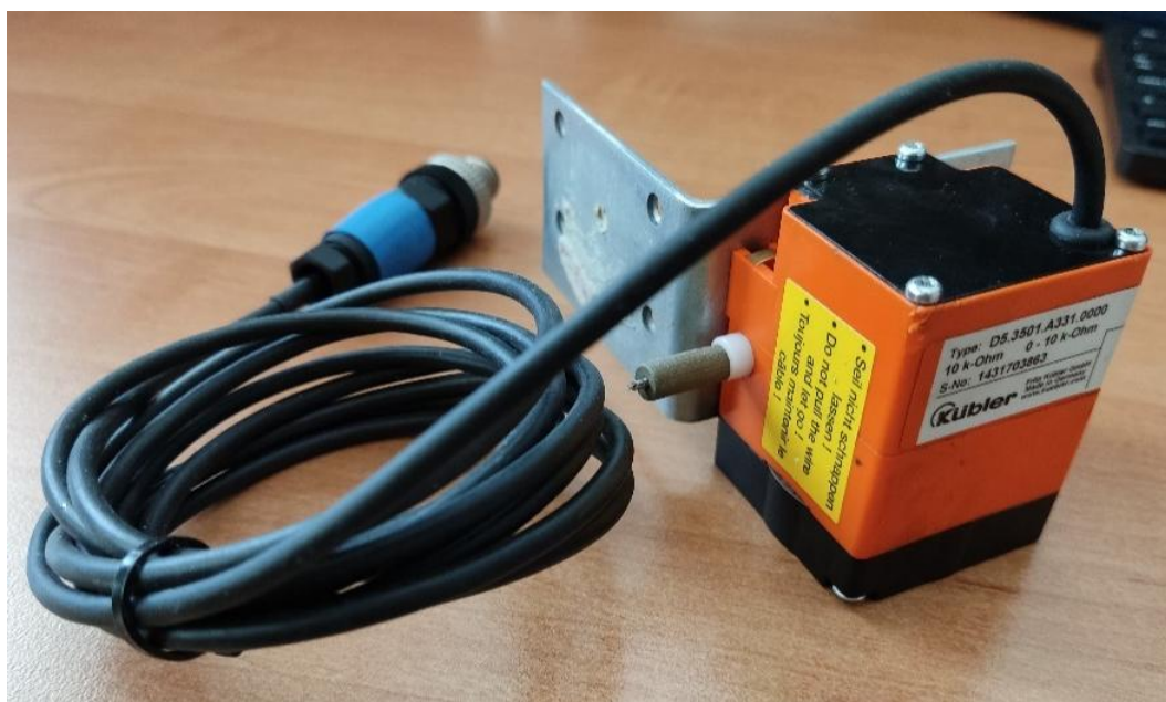
Rys. 4.22. Czujnik linkowy, model Kubler D5.3501.A331.0000
