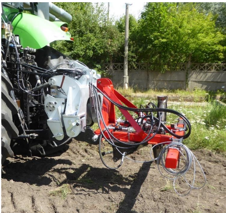
Rys. 4.16. Rama z narzędziem sadzącym połączona pośrednio z ciągnikiem z użyciem ramy pomiarowej [opracowanie własne]
