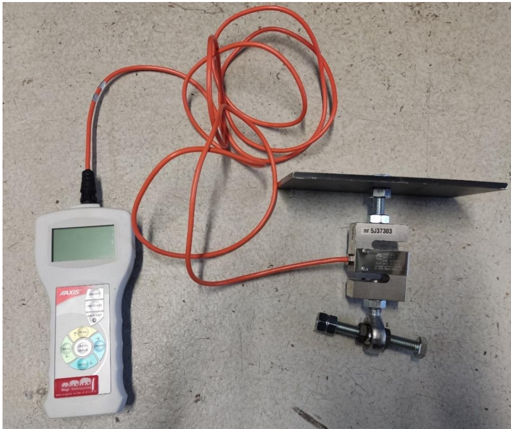
Rys. 4.13. Zestaw pomiarowy miernika oraz czujnika z dołączoną płytką dociskową. [opracowanie własne]
