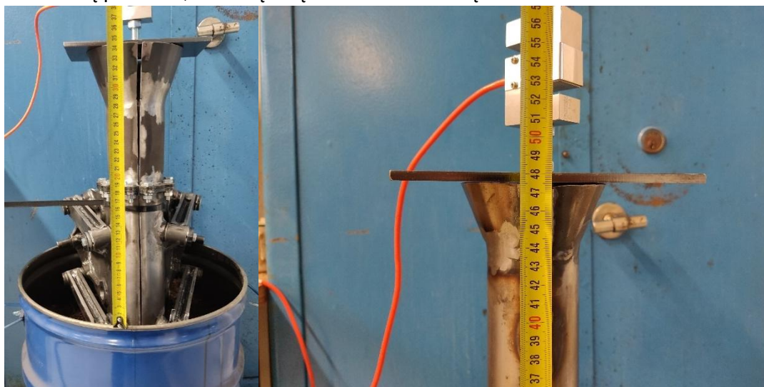
Rys. 7.3. Dokonywanie pomiaru zagłębienia narzędzia sadzącego po zagłębieniu zadaną wartością siły [opracowanie własne]
