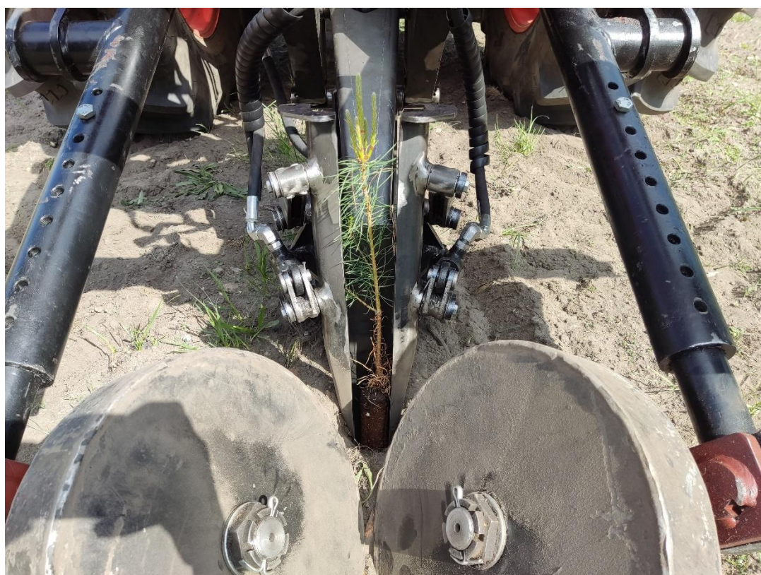
Rys. 7.29. Narzędzie z ostrzem klinowym z otwartymi szczękami w momencie wysadzania sadzonki sosnowej w ziemi [opracowanie własne]
