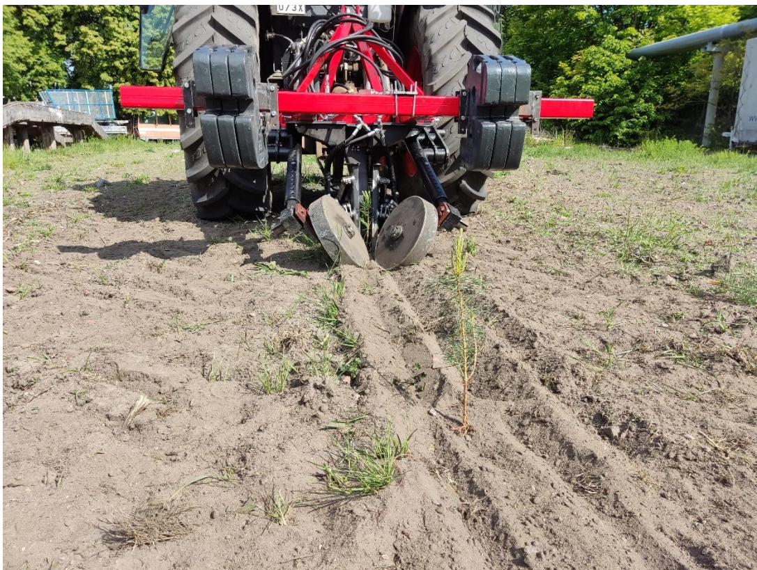
Rys. 7.32. Sadzonki sosnowe osadzone w ziemi w szyku z użyciem narzędzia wyposażonego w ostrze klinowe [opracowanie własne]
