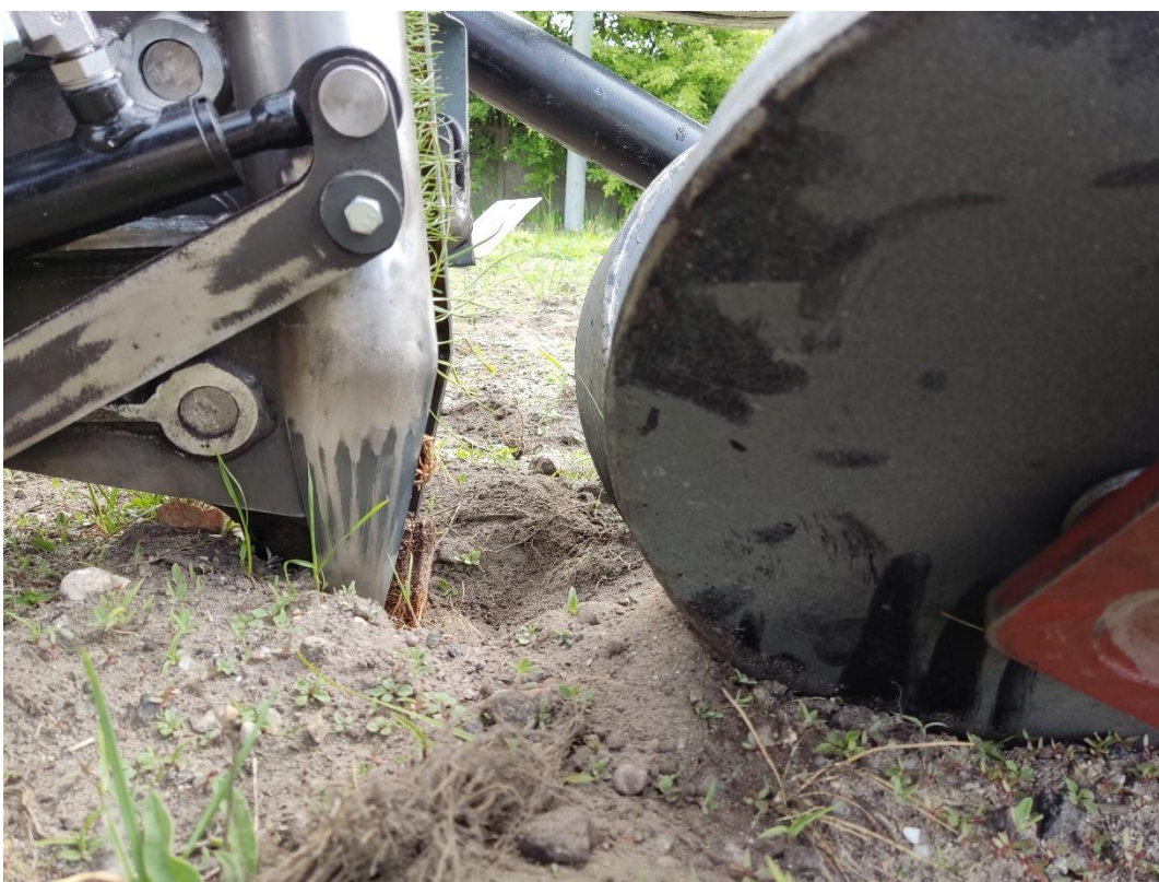
Rys. 7.23. Narzędzie sadzące z ostrzem stożkowym, z otwartymi szczękami, widok z profilu z sadzonką sosnową wewnątrz narzędzia [opracowanie własne]
