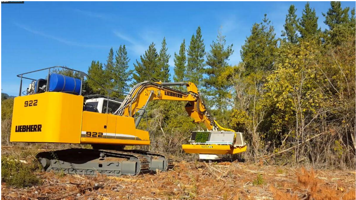
Rys. 2.23. Sadzarka Risutec ASP-720 zamontowana na koparce gąsienicowej, podczas pracy [83]
