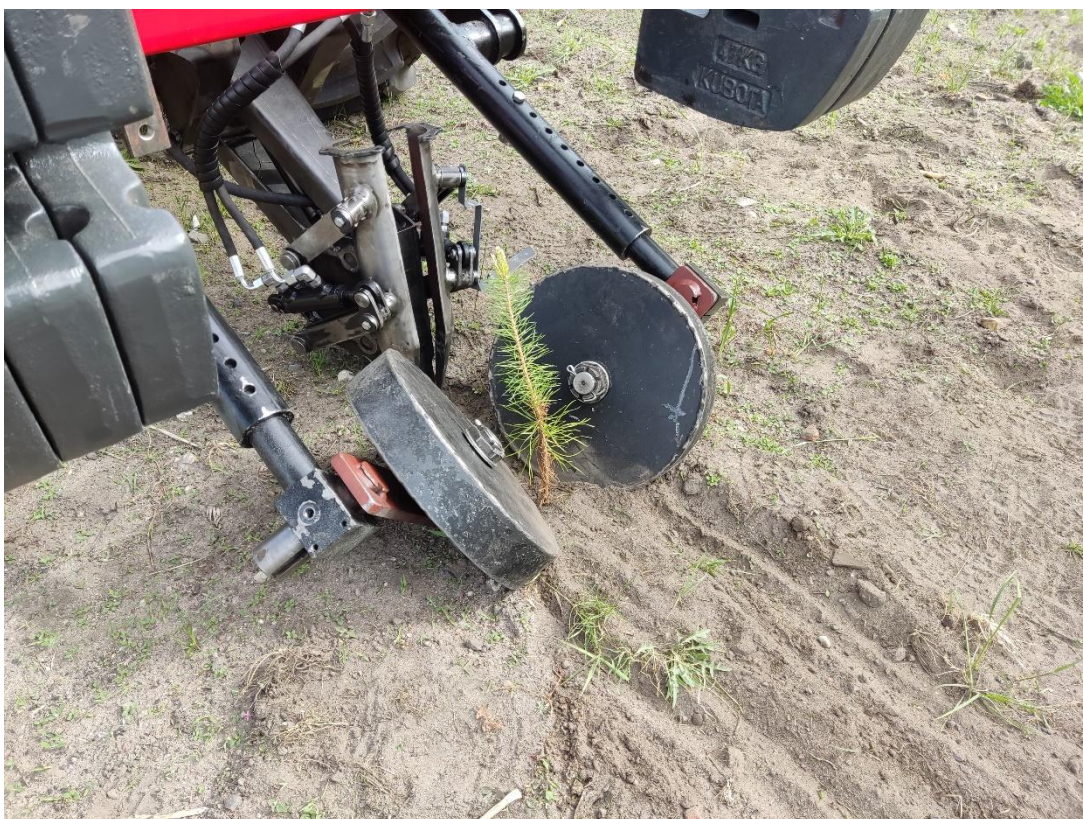
Rys. 7.24. Narzędzie sadzące z ostrzem stożkowym z otwartymi szczękami zaraz po wysadzeniu sadzonki w ziemi i dognieceniu kołami dociskowymi [opracowanie własne]
