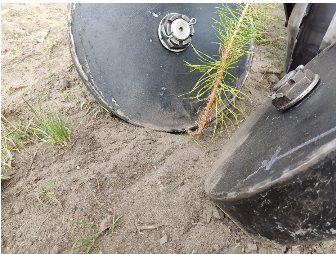
Rys. 7.25. Sadzonka sosnowa zaraz po wysadzeniu narzędziem z ostrzem stożkowym i dognieceniu kołami dociskowymi [opracowanie własne]
