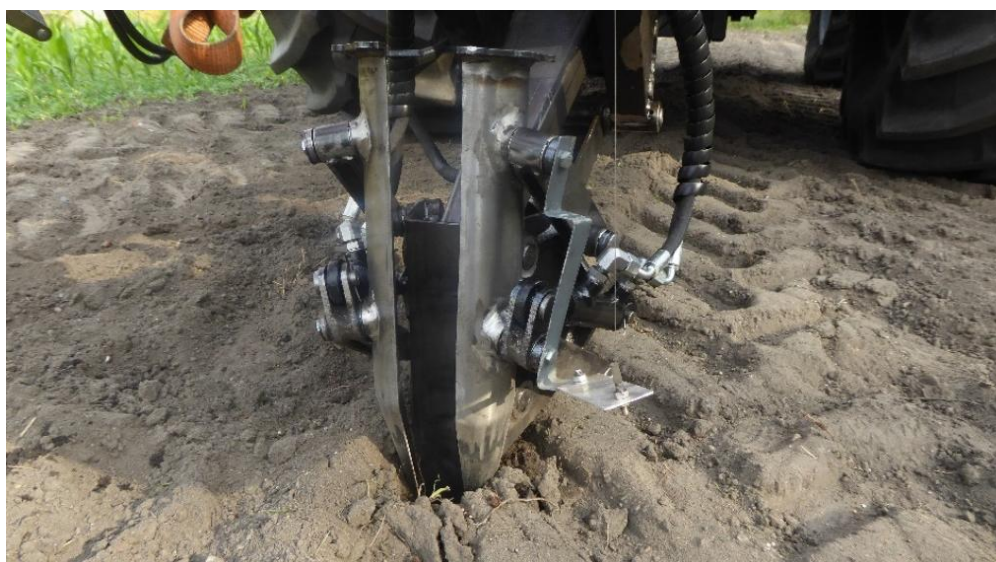
Rys. 7.7. Narzędzie z ostrzem stożkowym zagłębione w glebie podczas otwierania szczęk [opracowanie własne]
