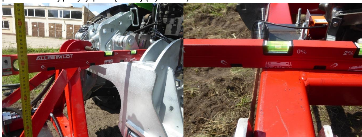
Rys. 4.37. Ustawianie ramy pomiarowej oraz ramy pośredniej równoległe do podłoża w punkcie startowym [opracowanie własne]
