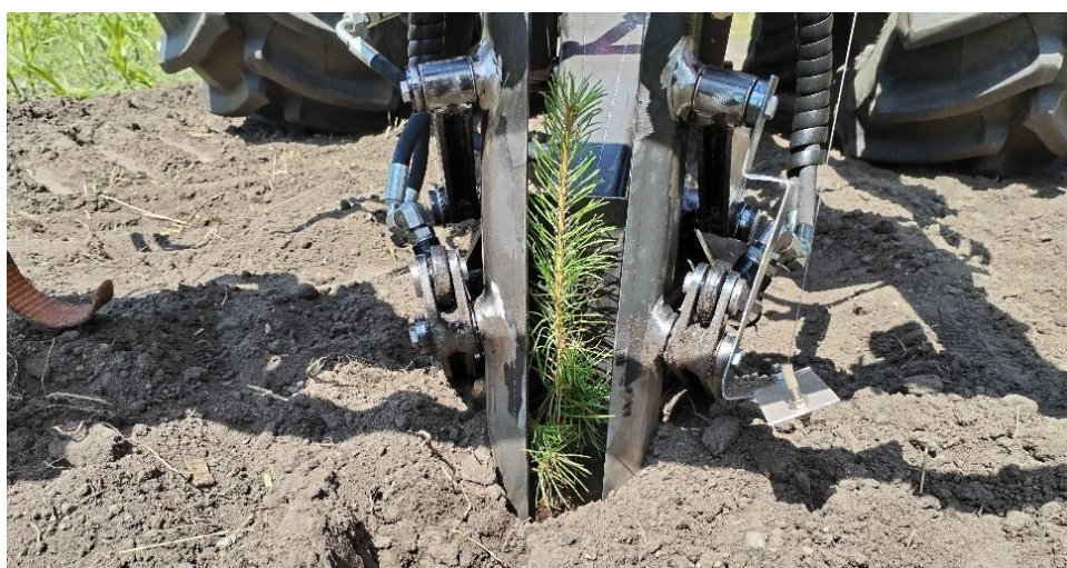
Rys. 7.15. Narzędzie z ostrzem klinowym w momencie otwierania szczęk i wysadzania sadzonki sosnowej [opracowanie własne]
