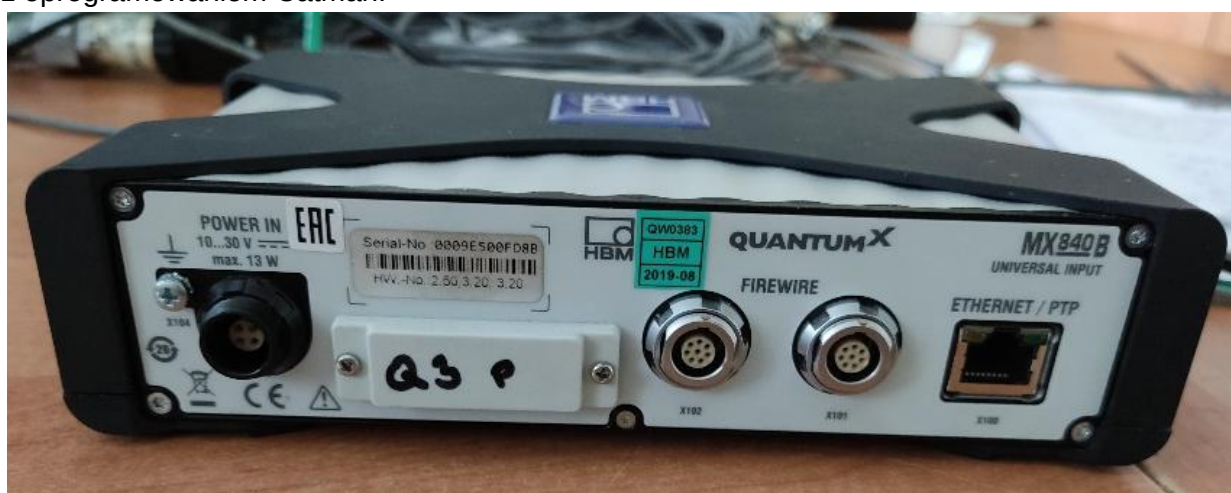
Rys. 4.24. Skrzynka pomiarowa HBM QuantumX MX840B (widok części zasilającej) [opracowanie własne]
