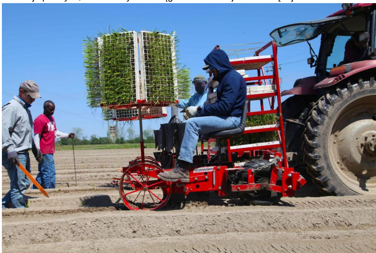
Rys. 2.17. Eksperymentalna sadzarka dwustanowiskowa podczas próby polowej [119]
