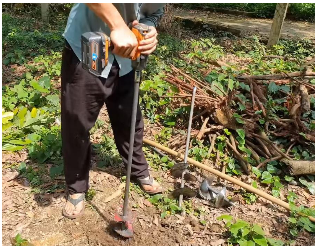
Rys. 2.26. Ręczny świder zamocowany do wkrętarki podczas wykonywania otworu w glebie [126]
