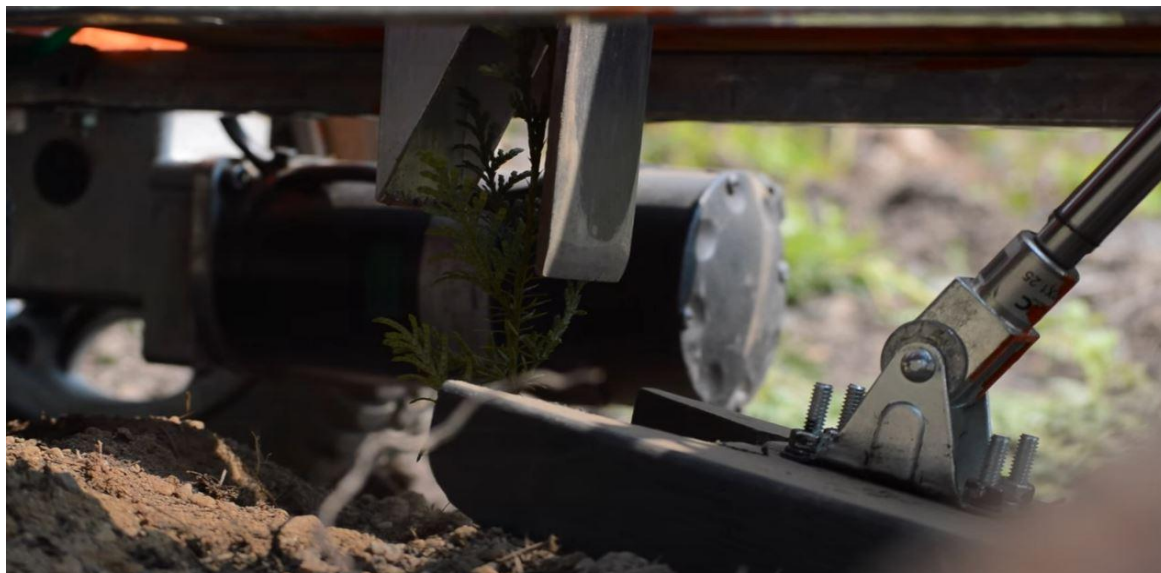
Rys. 2.25. Widok stopki dogniatającej miejsce sadzenia [125]
