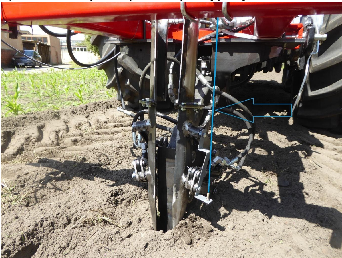
Rys. 4.23. Czujnik typu linkowego zamontowany do ramy podczas prowadzenia badań w warunkach rzeczywistych (linia niebieska) [opracowanie własne]
