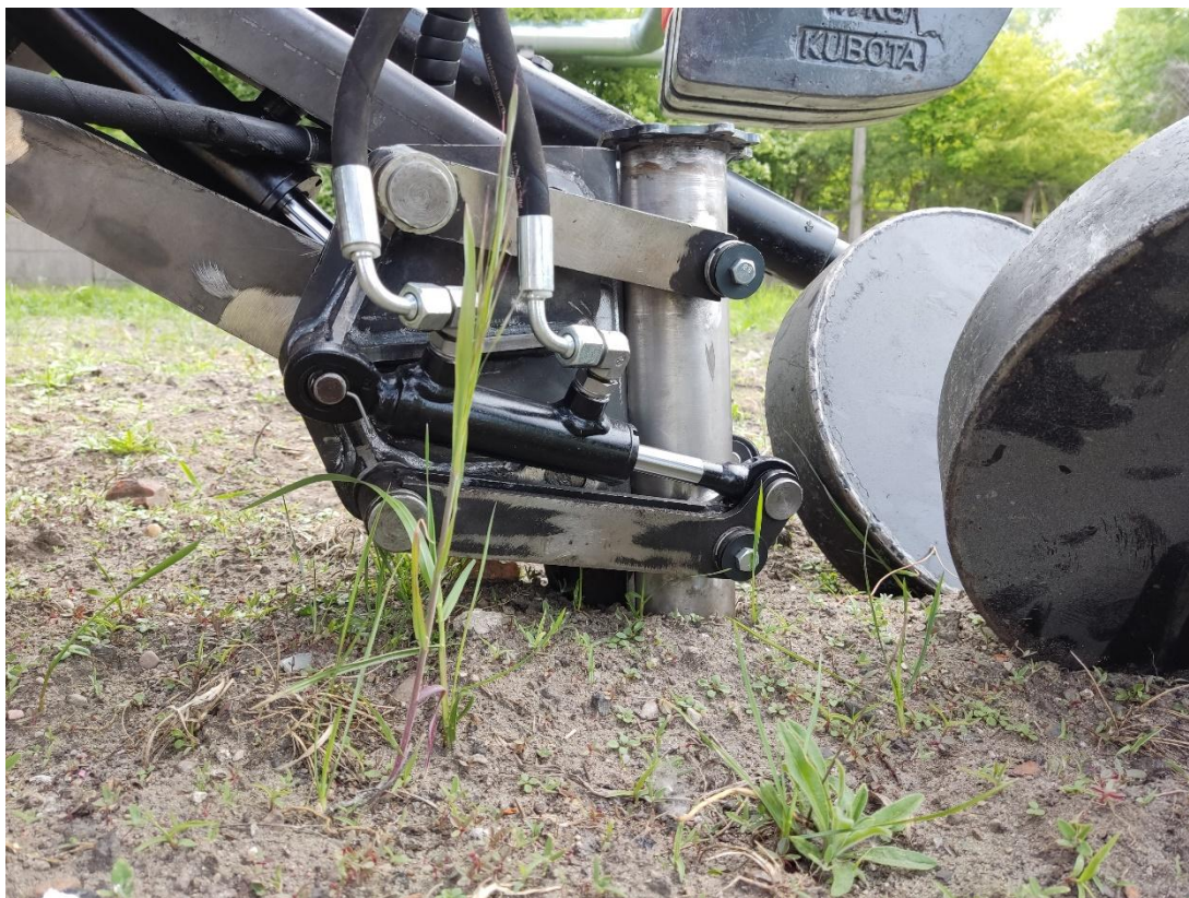
Rys. 7.19. Narzędzie sadzące z ostrzem stożkowym zagłębione w glebie, widok z profilu [opracowanie własne]
