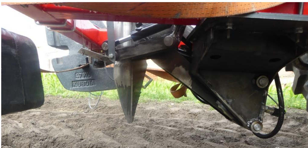
Rys. 7.9. Narzędzie z ostrzem stożkowym podczas zagłębiania, widok od prawej strony [opracowanie własne]
