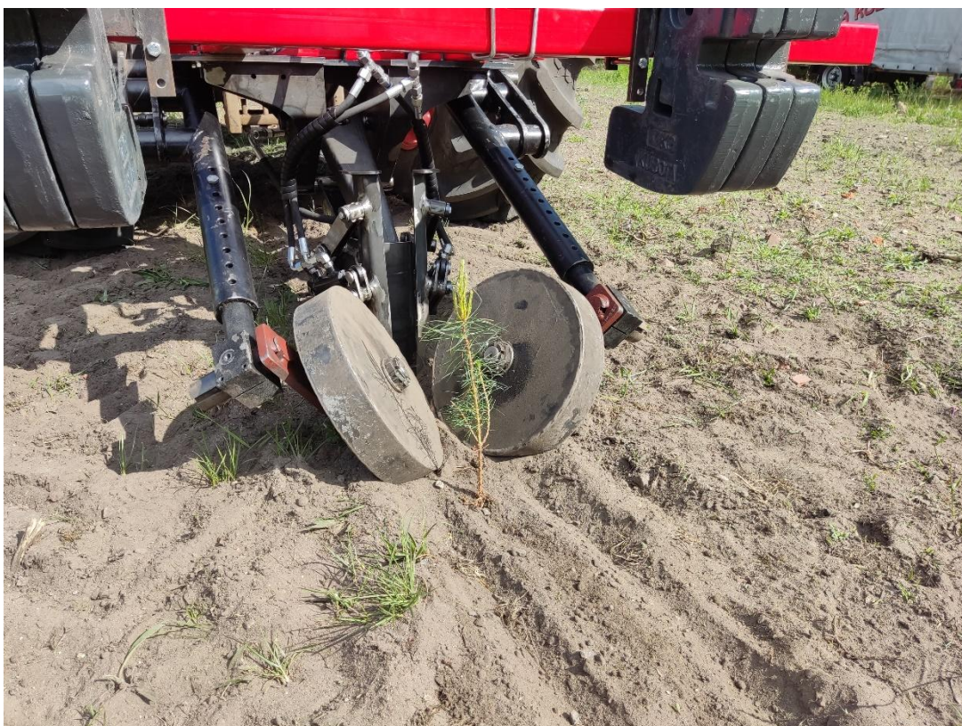
Rys. 7.30. Sadzonka sosnowa po wysadzeniu w glebie narzędziem wyposażonym w ostrze klinowe i dognieciona kołami dociskowymi [opracowanie własne]
