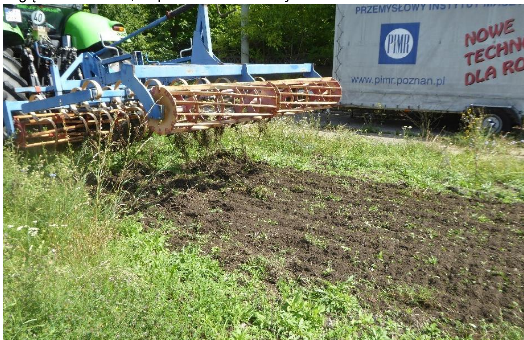
Rys. 4.36. Przejazd z zawieszonym agregatem uprawowym celem spulchnienia i ujednolicenia gleby [opracowanie własne]
