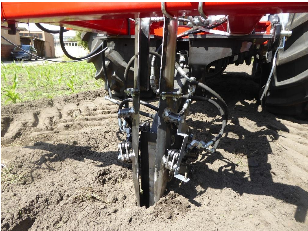
Rys. 7.5. Narzędzie z ostrzem klinowym zagłębione w glebie podczas otwierania szczęk [opracowanie własne]
