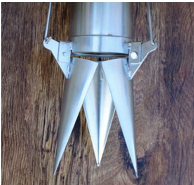
Rys. 2.16. Stożkowa końcówka ręcznego urządzenia sadzącego z otwartymi za pomocą cięgieł trzema szczękami [115]
