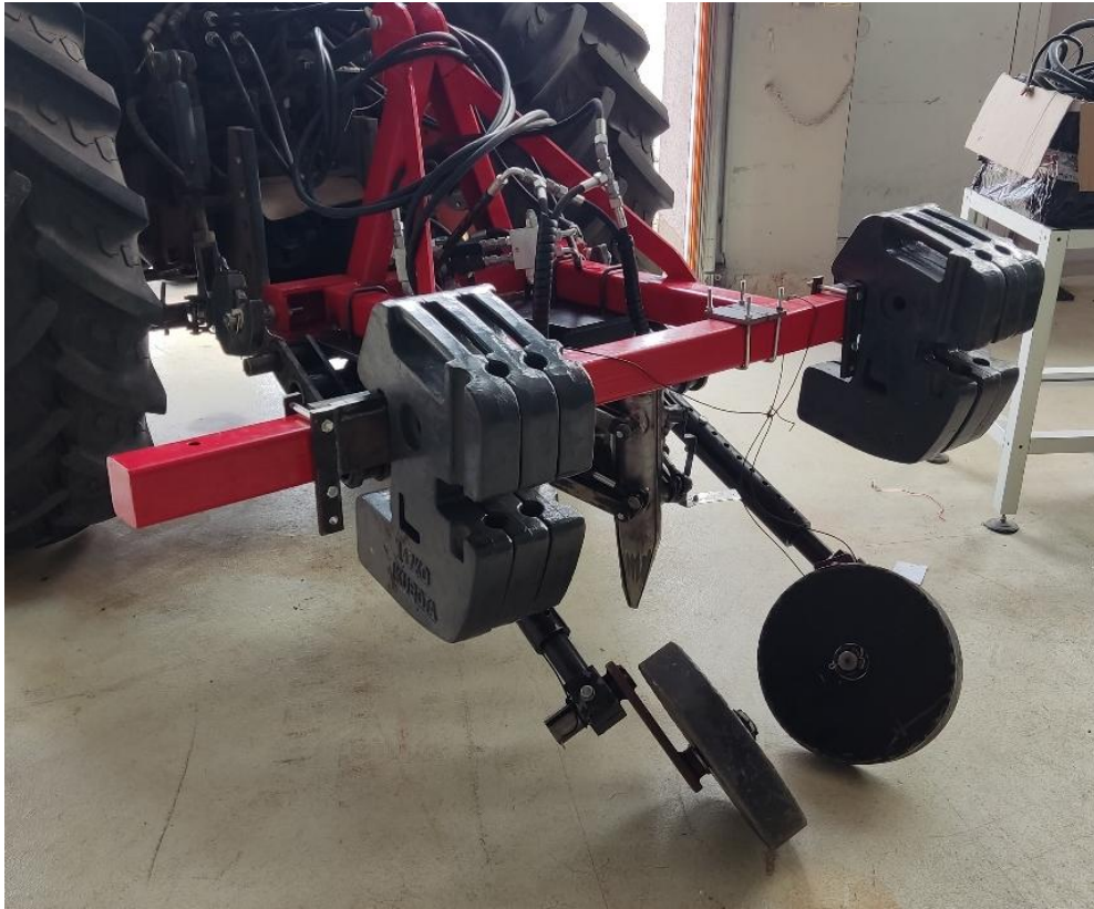
Rys. 7.16. Narzędzie sadzące zamontowane na ramie pośredniej wraz z kołami dociskowymi [opracowanie własne]
