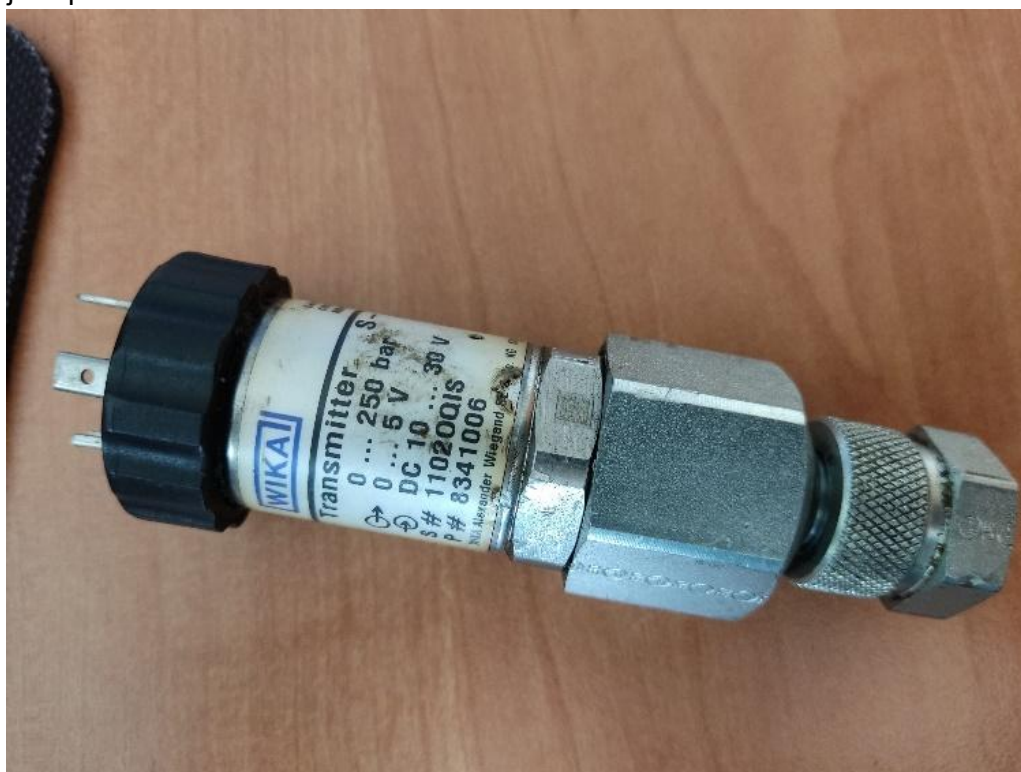
Rys. 4.20. Czujnik ciśnienia Wika o zakresie pomiarowym od 0 do 250 barów
