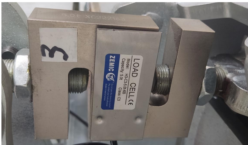
Rys. 4.19. Czujnik typu S o oznaczeniu H3-C3-5.0t-6B, o zakresie pomiarowym do 5t, który wchodzi w skład oprzyrządowania ramy pomiarowej [133]
