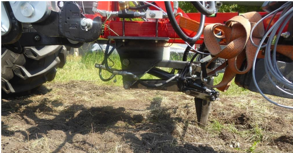
Rys. 7.8. Narzędzie z ostrzem klinowym podczas zagłębiania, widok od lewej strony [opracowanie własne]
