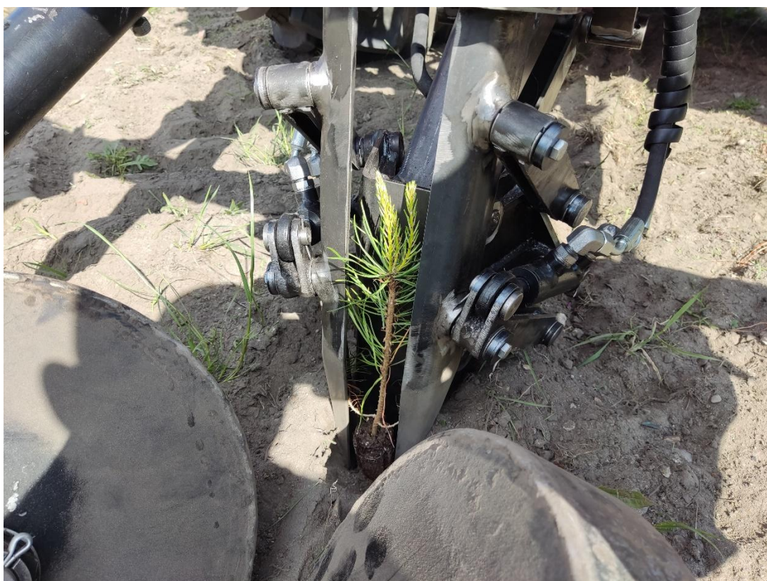
Rys. 7.33. Sadzonka sosnowa w momencie otwierania szczęk narzędzia z ostrzem klinowym [opracowanie własne]
