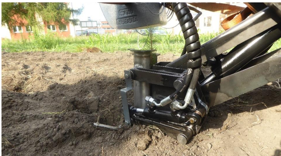
Rys. 7.12. Narzędzie z ostrzem stożkowym w momencie otwierania szczęk i wysadzania sadzonki sosnowej, widok od prawej strony [opracowanie własne]
