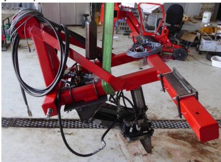
Rys. 4.15. Model funkcjonalny narzędzia sadzącego zamocowany do ramy pośredniej umożliwiającej zagregowanie z ciągnikiem rolniczym [opracowanie własne]
