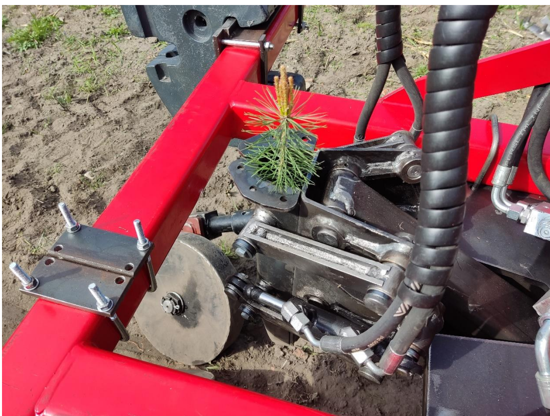
Rys. 7.27. Narzędzie z ostrzem klinowym zagłębione w ziemi wraz z sadzonką sosnową umieszczoną wewnątrz [opracowanie własne]
