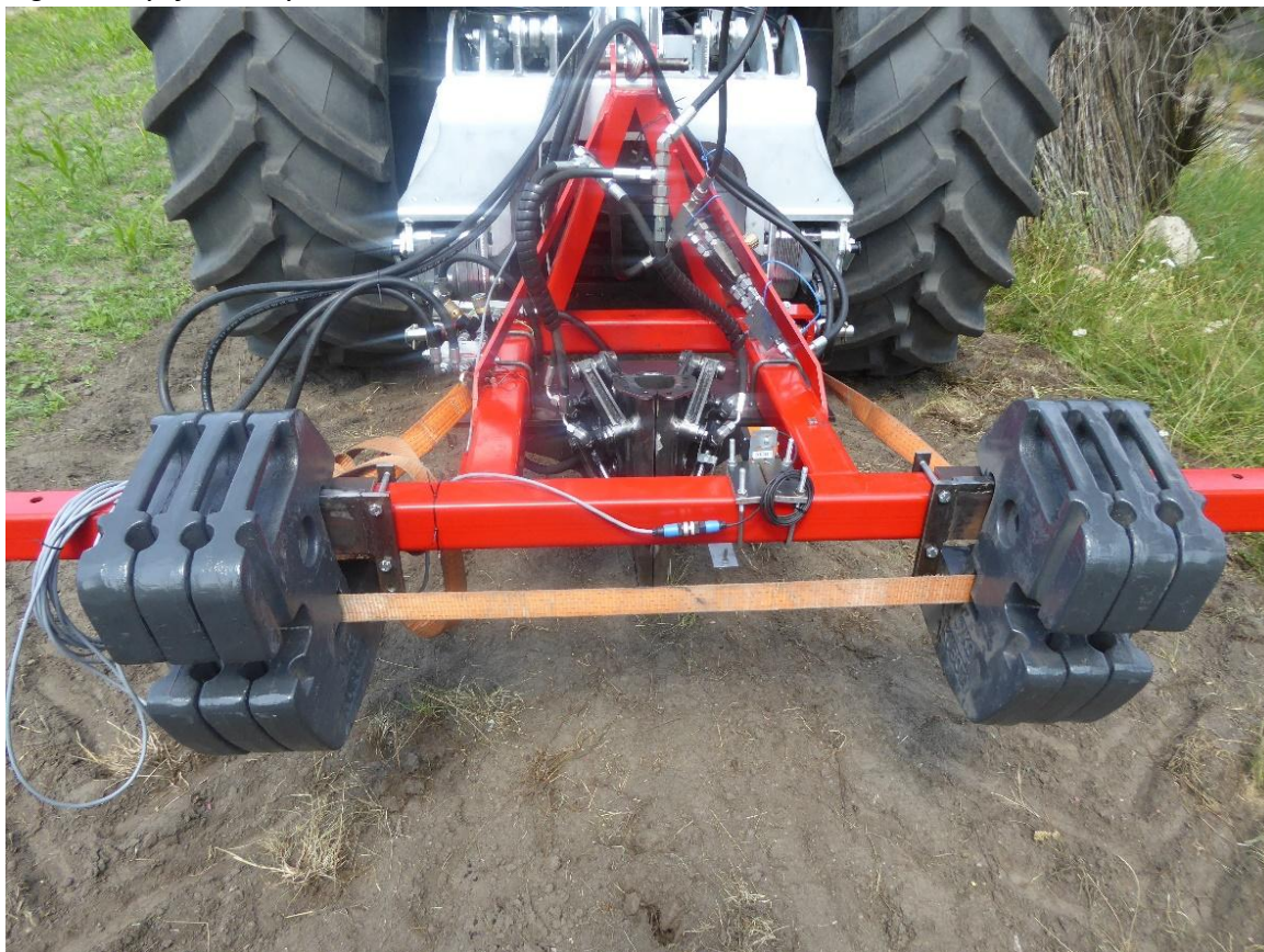
Rys. 4.29. Obciążniki ciągnika marki Kubota o masie jednostkowej 47 kg w liczbie sześciu sztuk, po 3 sztuki na stronę ramy [opracowanie własne]
