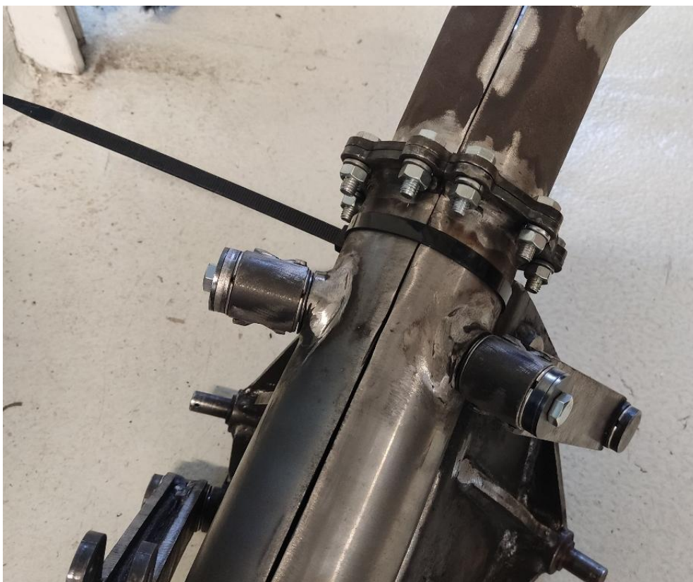
Rys. 4.14. Narzędzie sadzące z ostrzem zabezpieczonym przed otwarciem podczas zagłębiania [opracowanie własne]
