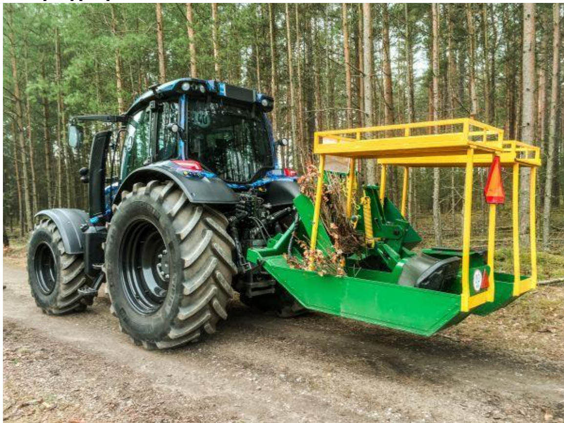
Rys. 2.13. Sadzarka dwurzędowa o oznaczeniu RZS-2 zawieszona na ciągniku podczas przygotowania do pracy [117]
