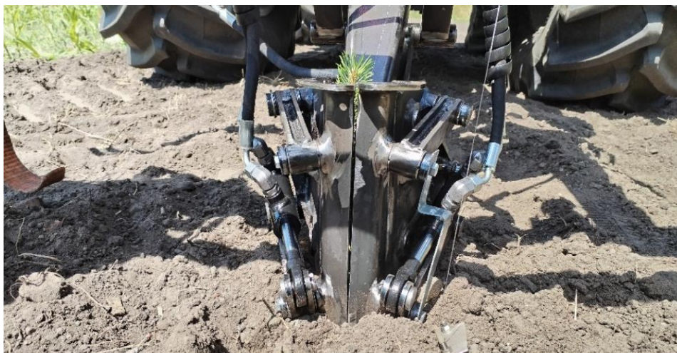
Rys. 7.14. Narzędzie z ostrzem klinowym w momencie pełnego zagłębienia [opracowanie własne]
