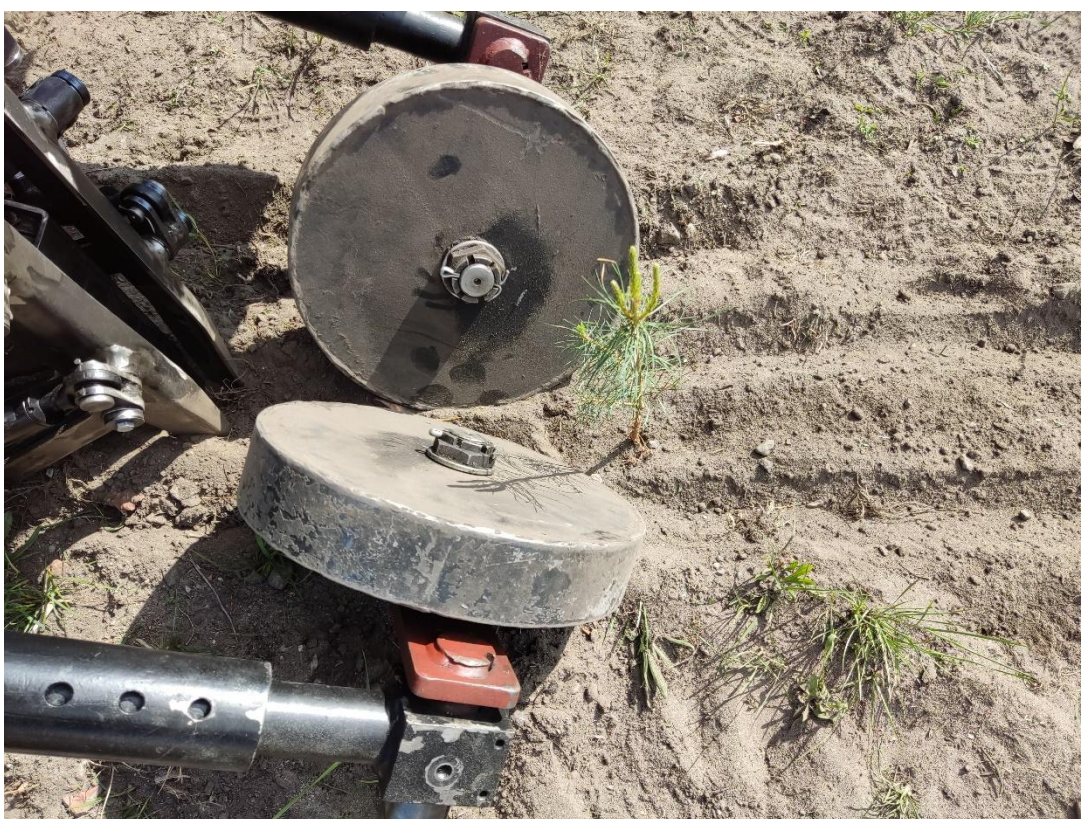
Rys. 7.31. Sadzonka sosnowa po wysadzeniu w ziemi narzędziem wyposażonym w ostrze klinowe i dognieciona kołami dociskowymi, widok z góry [opracowanie własne]
