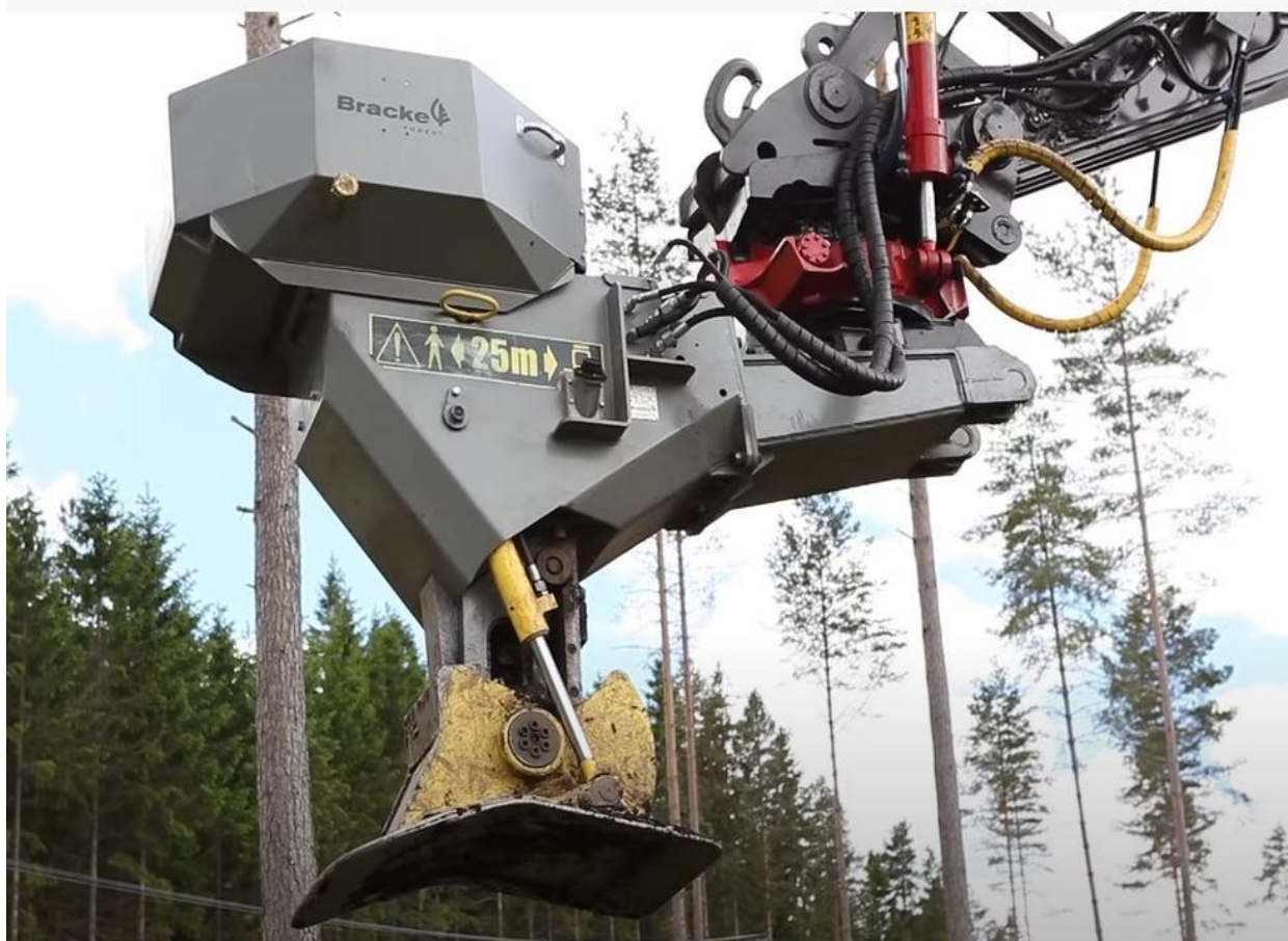
Rys. 2.27. Sadzarka Bracke P11.a zamontowana na wysięgniku koparki podczas wykonywania operacji sadzenia [127]
