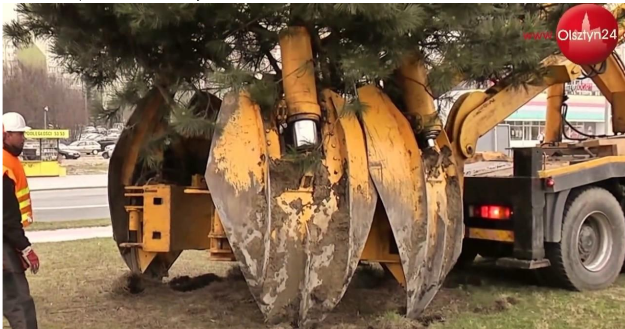
Rys. 2.6. Przykład sadzarki przeznaczonej do przesadzania dużych, wieloletnich drzew, zamontowanej na samochodzie ciężarowym [7]
