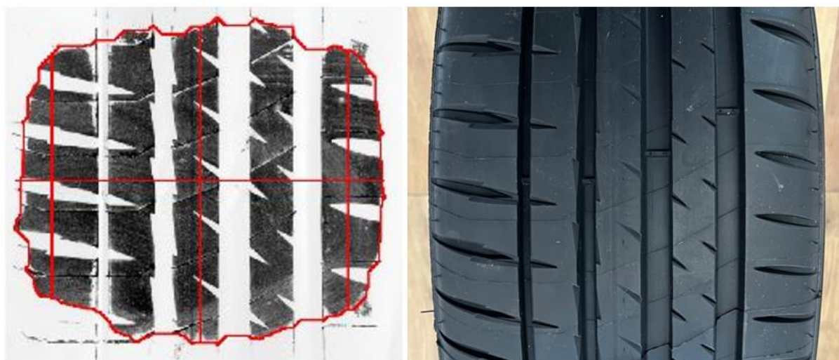
Rysunek 4.40. Odcisk oraz fotografia rzeźby bieżnika opony 205/55 ZR16 (94Y) XL Michelin PILOT SPORT 4 (opracowanie własne)
