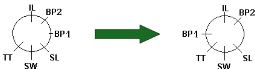
Rysunek 4.12. Rozkład złącz poprawiony na podstawie przeprowadzonej analizy fali RFV (opracowanie własne)
