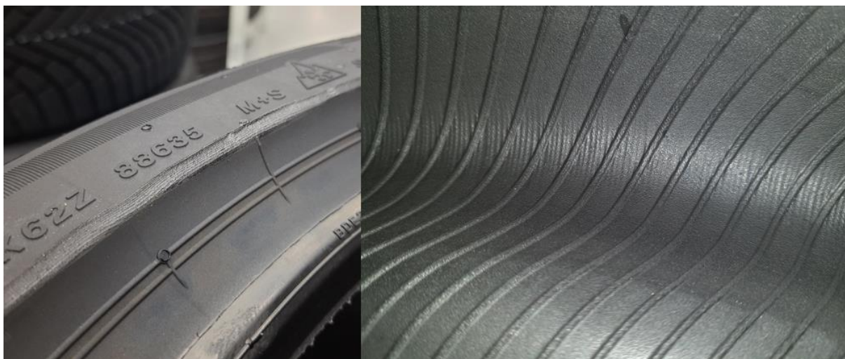
Rysunek 4.4. Ubytek boku (po lewej) oraz wypłynięcie osnowy (po prawej) (opracowanie własne)
