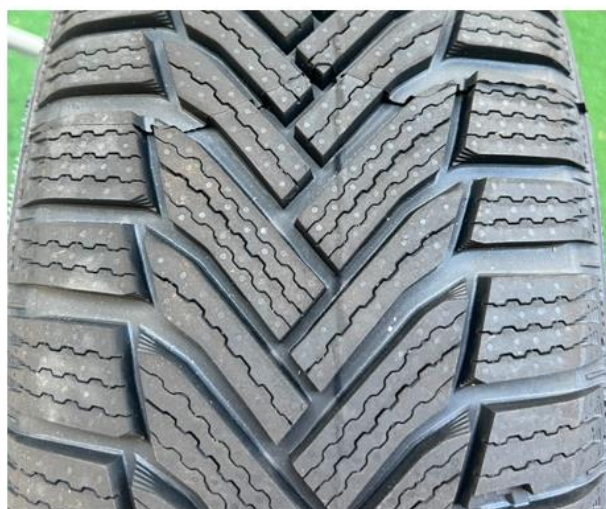
Rysunek 4.39. Odcisk oraz fotografia rzeźby bieżnika opony 205/55 R16 91H Michelin ALPIN 6 (opracowanie własne)
