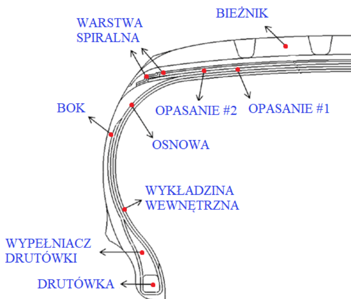
Rysunek 2.4. Komponenty składowe opony (opracowanie własne)
