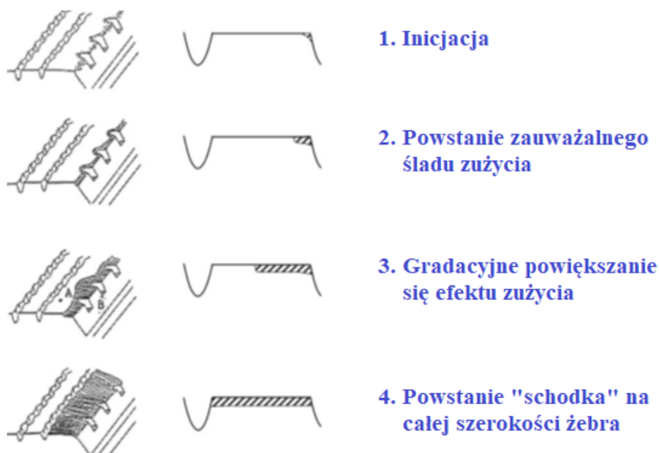
Rysunek 4.14. Mechanizm powstawania zużycia schodkowego wywołanego działaniem siły bocznej (opracowanie własne na podstawie Nakajima, 2019)
