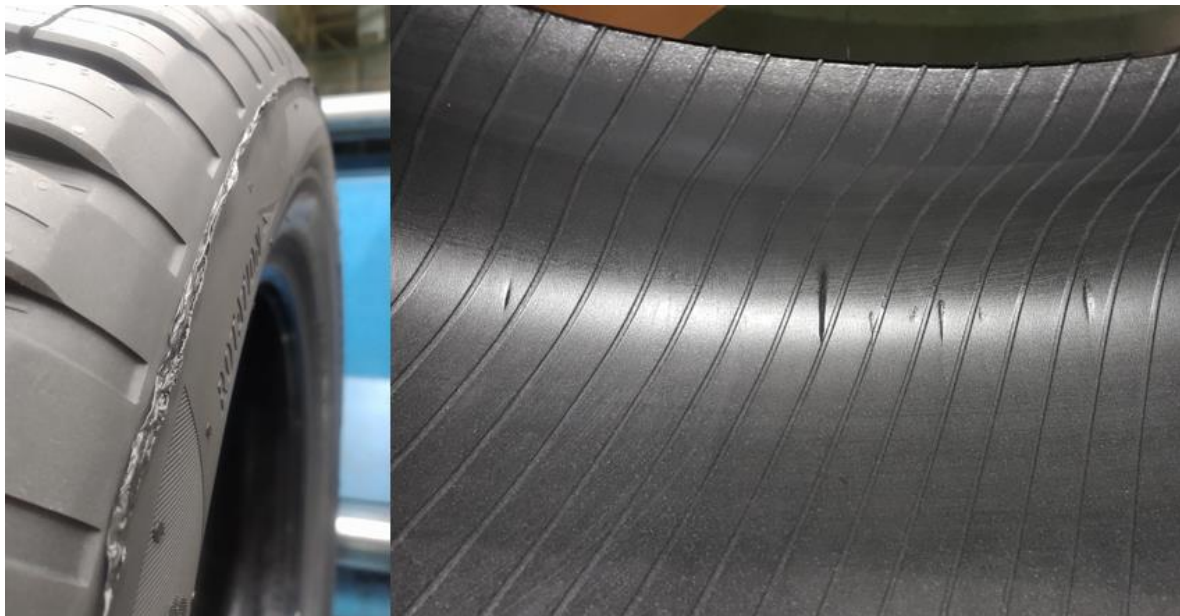
Rysunek 4.2. Nadlewka na linii podziału formy (po lewej) oraz przemieszczenie nitek osnowy (po prawej) (opracowanie własne)
