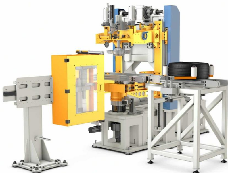
Rysunek 3.9. Maszyna TUO do pomiaru jednorodności opon (materiały własne przedsiębiorstwa)
