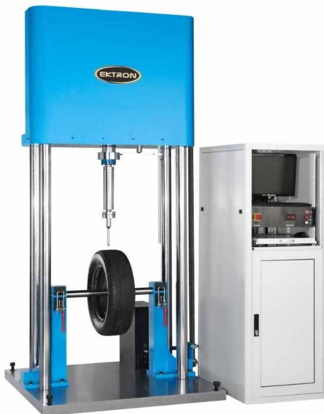
Rysunek 4.46. Maszyna do przeprowadzania testu przebicia opony (materiały własne przedsiębiorstwa)
