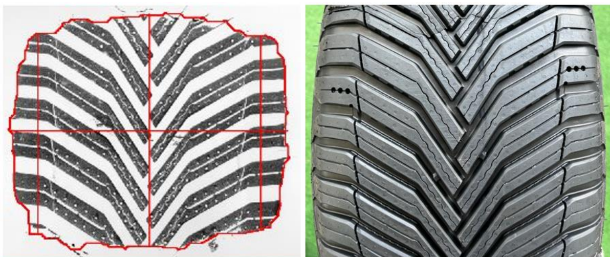
Rysunek 4.43. Odcisk oraz fotografia rzeźby bieżnika opony 235/45 R18 98Y XL FR Michelin CrossClimate 2 (opracowanie własne)
