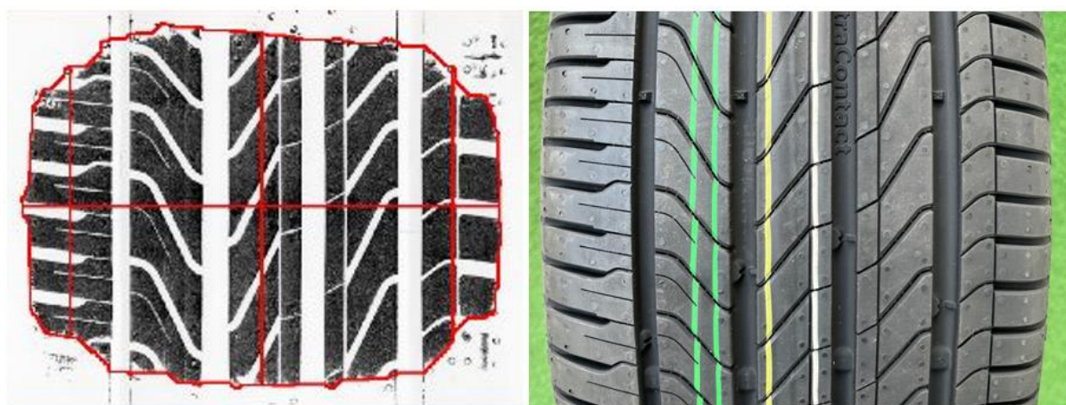
Rysunek 4.42. Odcisk oraz fotografia rzeźby bieżnika opony 225/50 R18 99W Continental UltraContact NXT (opracowanie własne)
