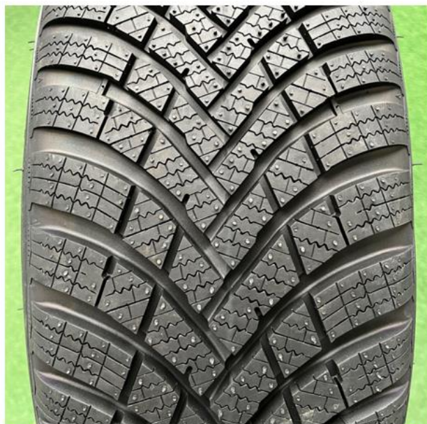
Rysunek 4.38. Odcisk oraz fotografia rzeźby bieżnika opony 195/55 R16 87H Hankook Winter i*cept RS3 W462 (opracowanie własne)
