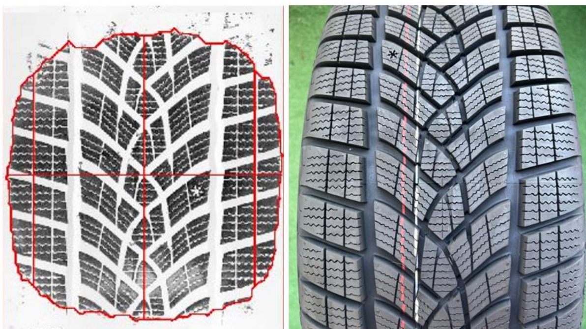
Rysunek 4.44. Odcisk oraz fotografia rzeźby bieżnika opony 235/55 R18 104H XL Goodyear UltraGrip Performance+ SUV (opracowanie własne)
