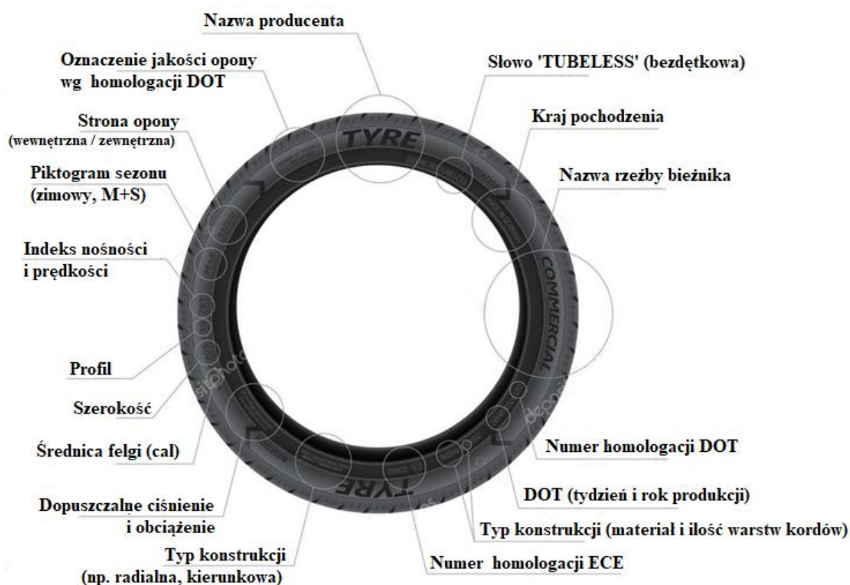
Rysunek 4.5. Oznaczenia ( stamping ) na boku opony (opracowanie własne)
