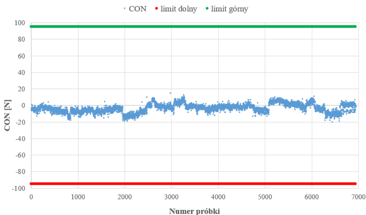
Rysunek 7.19. Wyniki pomiarów stożkowatości dla przebiegu procesu produkcji opon ze zbioru V (opracowanie własne)
