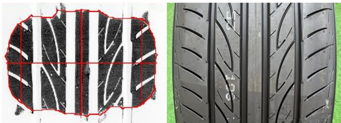
Rysunek 4.41. Odcisk oraz fotografia rzeźby bieżnika opony 225/50 R17 98W XL Yokohama Advan Fleva V701 (opracowanie własne)
