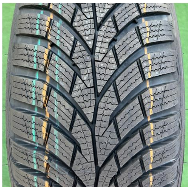
Rysunek 4.37. Odcisk oraz fotografia rzeźby bieżnika opony 185/55 R16 87T Continental WinterContact TS 870 (opracowanie własne)
