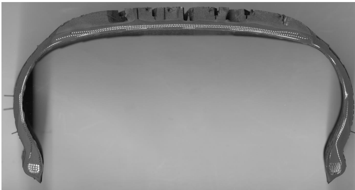
Rysunek 4.28. Przekrój poprzeczny opony 185/55 R16 87T Continental WinterContact TS 870 (opracowanie własne)
