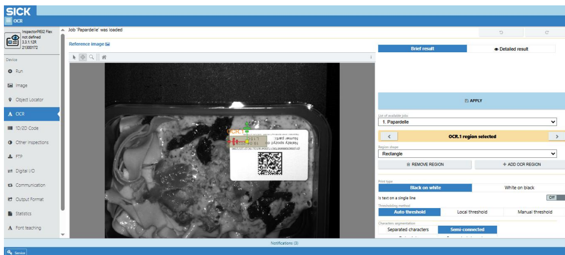
Rysunek 4.37. Interfejs konfiguracji narzędzia OCR do odczytu oznaczeń alfanumerycznych z etykiety wyrobu (opracowanie własne).
