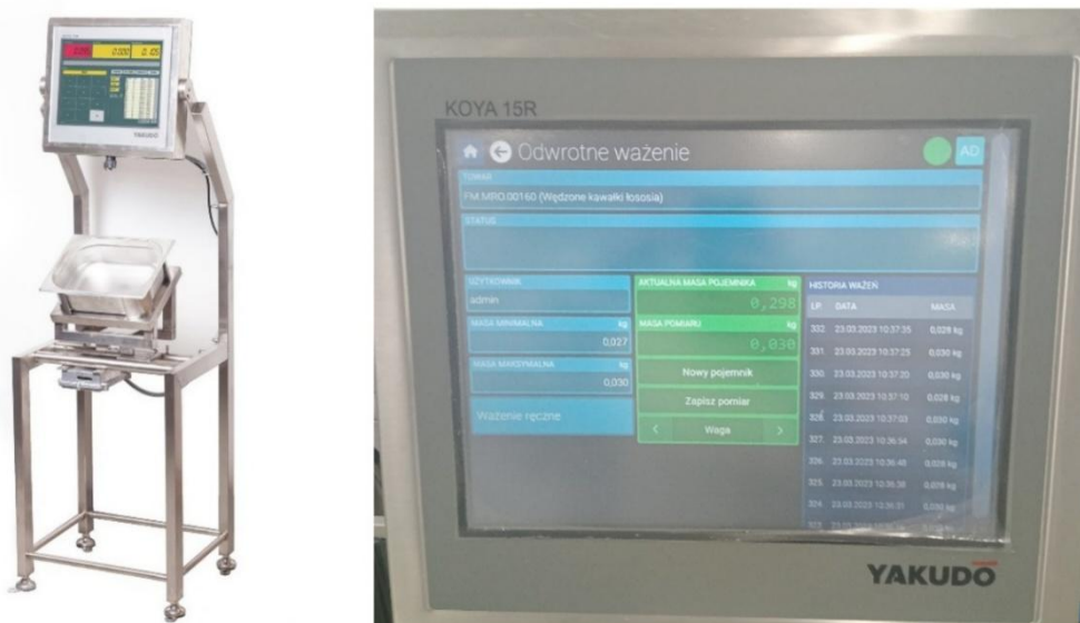
Rysunek 4.1. Stanowisko wagowe z panelem operatorskim HMI (opracowanie własne na podstawie danych udostępnionych przez przedsiębiorstwo).
