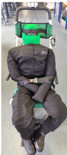
Rysunek 39. Manekin o masie 80 kg użyty do badań trwałości pasów jezdnych i układu jezdnego (źródło: opracowanie własne).
