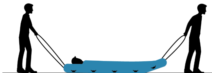
Rysunek 25. Ewakuacja w poziomie na materacu ewakuacyjnym (PRIME) z dwoma ratownikami (operatorami) (EnSafe.One FALCON evacuation chair, 2024) (źródło: EnSafe.One).
