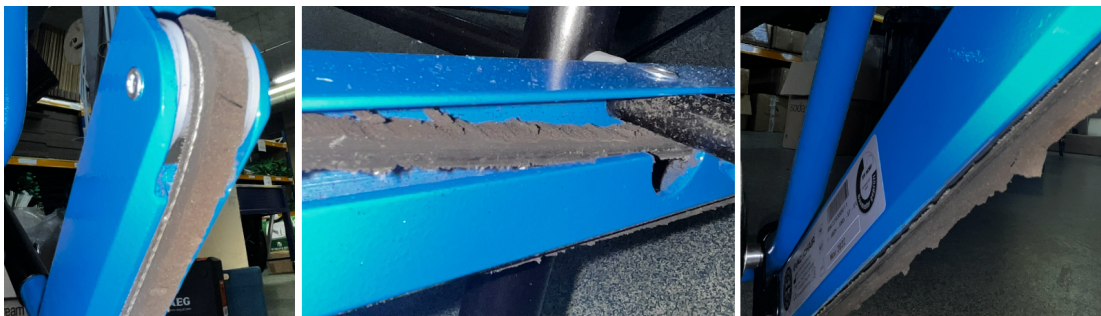
Rysunek 46. Pas jezdny krzesła ewakuacyjnego B po wykonaniu testu (źródło: opracowanie własne).
