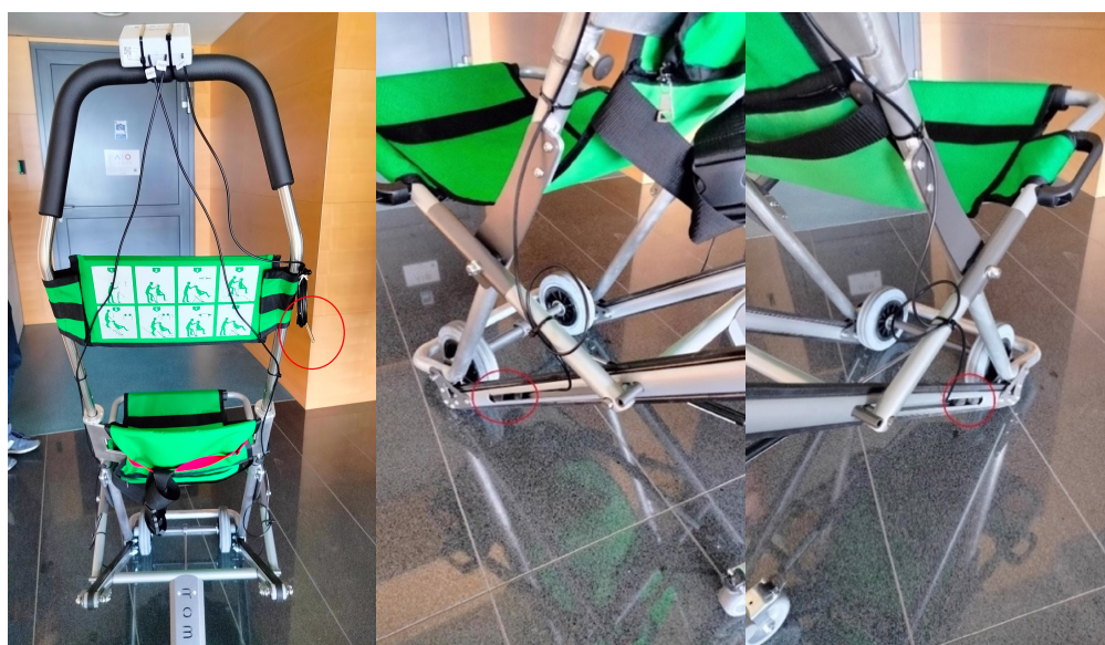
Rysunek 40. Metoda pomiaru temperatury płóz jezdnych testowanych krzeseł ewakuacyjnych (źródło: opracowanie własne).
