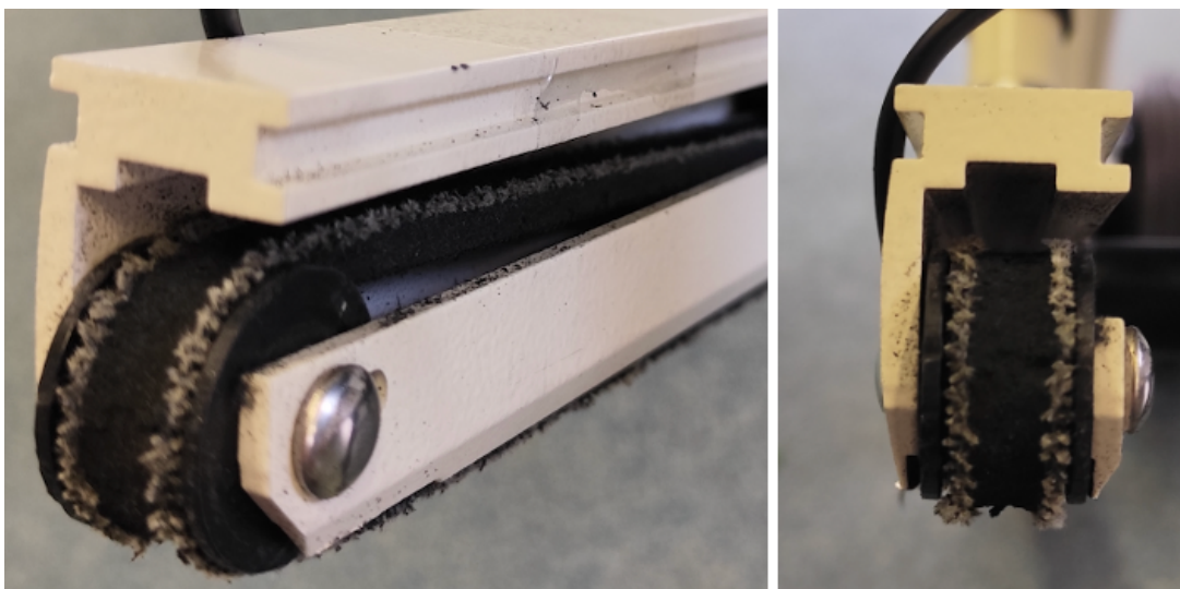
Rysunek 44. Pas jezdny krzesła ewakuacyjnego A po wykonaniu testu i zjazdu przez 94 kondygnacje (źródło: opracowanie własne).
