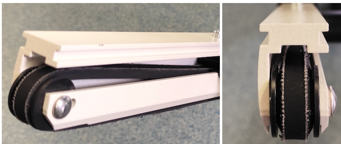
Rysunek 43. Pas jezdny krzesła A przed wykonaniem testu (źródło: opracowanie własne).
