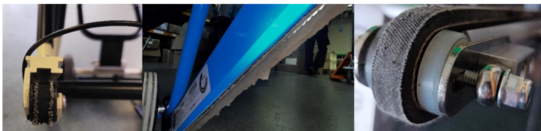
Rysunek 49. Zużycie pasów jezdnych po testach: a - krzesło ewakuacyjne A (Escape Mobility) – po 94 kondygnacjach, b – Krzesło ewakuacyjne B (Evac+Chair) po 98 kondygnacjach, c – krzesło ewakuacyjne C (EnSafe.One) po 300 kondygnacjach (źródło: opracowanie własne).
