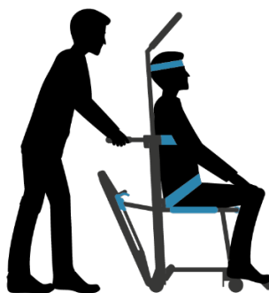
Rysunek 23. Ewakuacja w poziomie na krześle ewakuacyjnym (EnSafe.One FALCON evacuation chair, 2024) (źródło: EnSafe.One).
