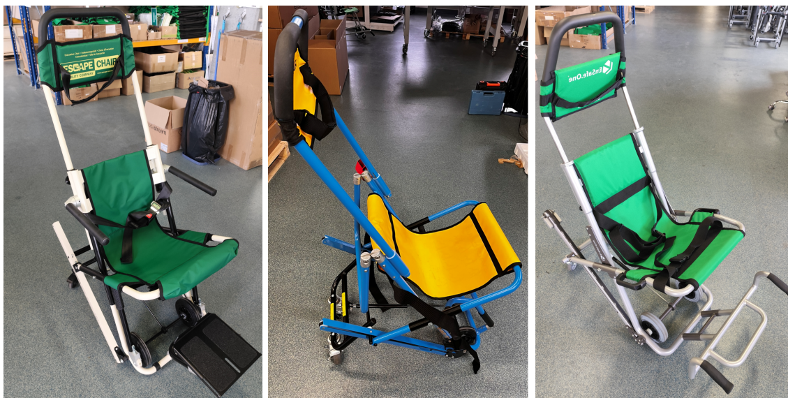
Rysunek 38. Testowane krzesła ewakuacyjne na dwóch stałych kołach: A (Escape Mobility), B (Evac Chair 600H), C (EnSafe.One Robin 2.0) (źródło: opracowanie własne).
