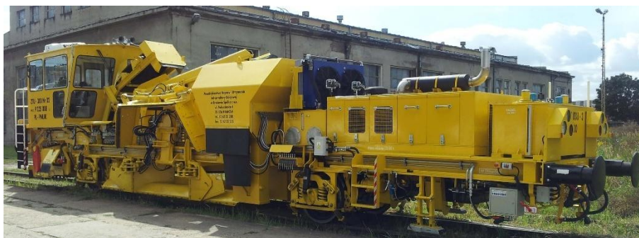
Rys. 16. Widok zgarniarki tłucznia uniwersalnej typu ZTU-300.02. Źródło: https://www.mtrmps.com.pl/zps/galeria/p28.jpg (dostęp: 26.09.2025)
