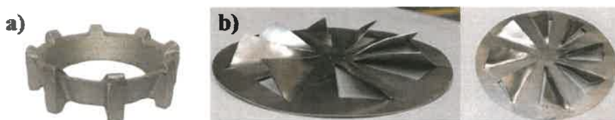
Ryc. 3. System pozycjonowania kanałów napowietrzających palników retortowych.
