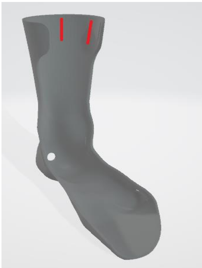
Rysunek 4.31. Oznaczenie miejsca badania chropowatości ortez stawu skokowego
