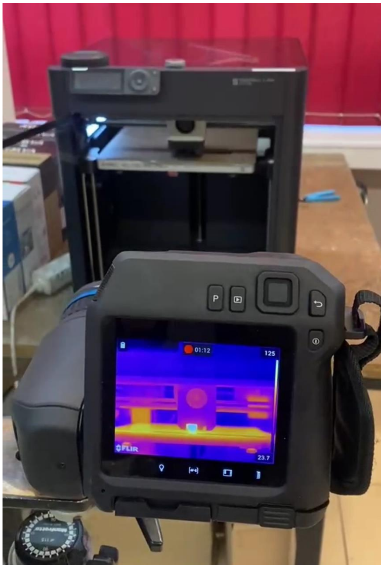
Rysunek 4.20. Stanowisko pracy do wytwarzania próbek na rozciąganie z wykorzystaniem kamery termowizyjnej
