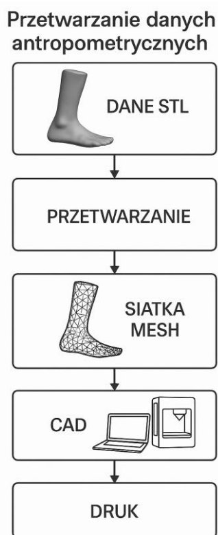
Rysunek 2.7. Schemat przetwarzania danych antropometrycznych – od pliku STL do wydruku 3D
