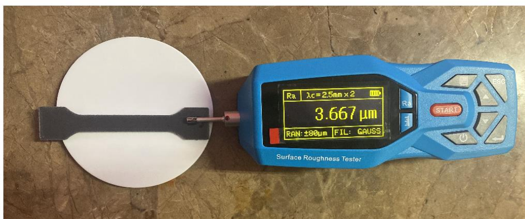
Rysunek 4.19 Miejsca, w których przeprowadzono pomiar chropowatości, typ próbki:
