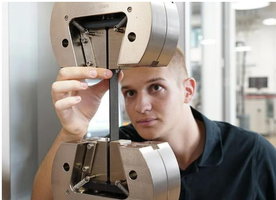
Rysunek 2.14. Przykładowy pomiar rozciągania próbki typu 1B zgodnej z ISO 527 [124]
