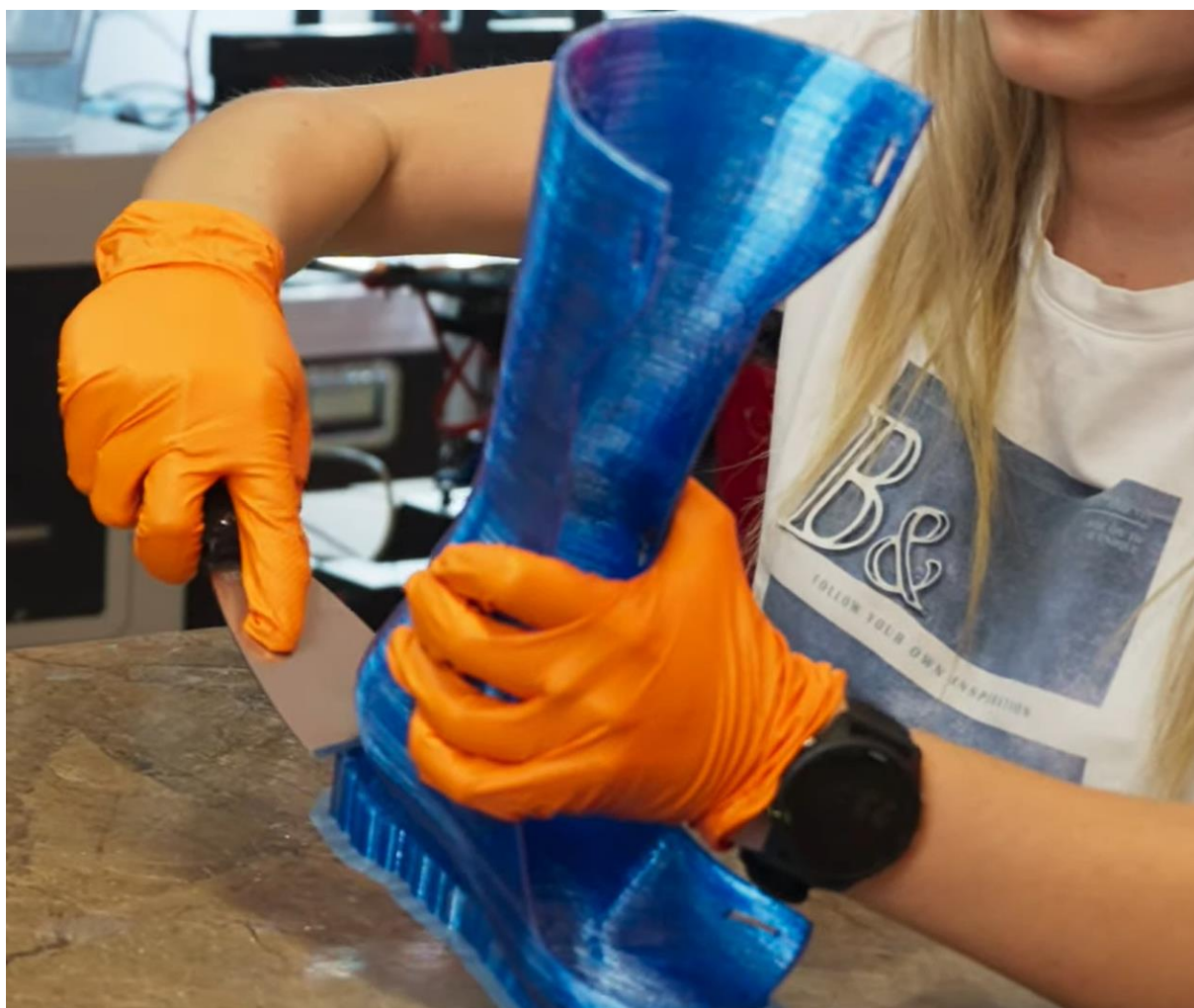
Rysunek 4.15. Ręczne usuwanie podpór z ortozy stawu skokowego w laboratorium Szybkiego Wytwarzania na Politechnice Poznańskiej [157]
