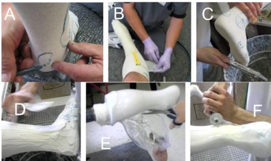
Rysunek 2.13. Formowanie ręczne ortez stawu skokowego [63]
