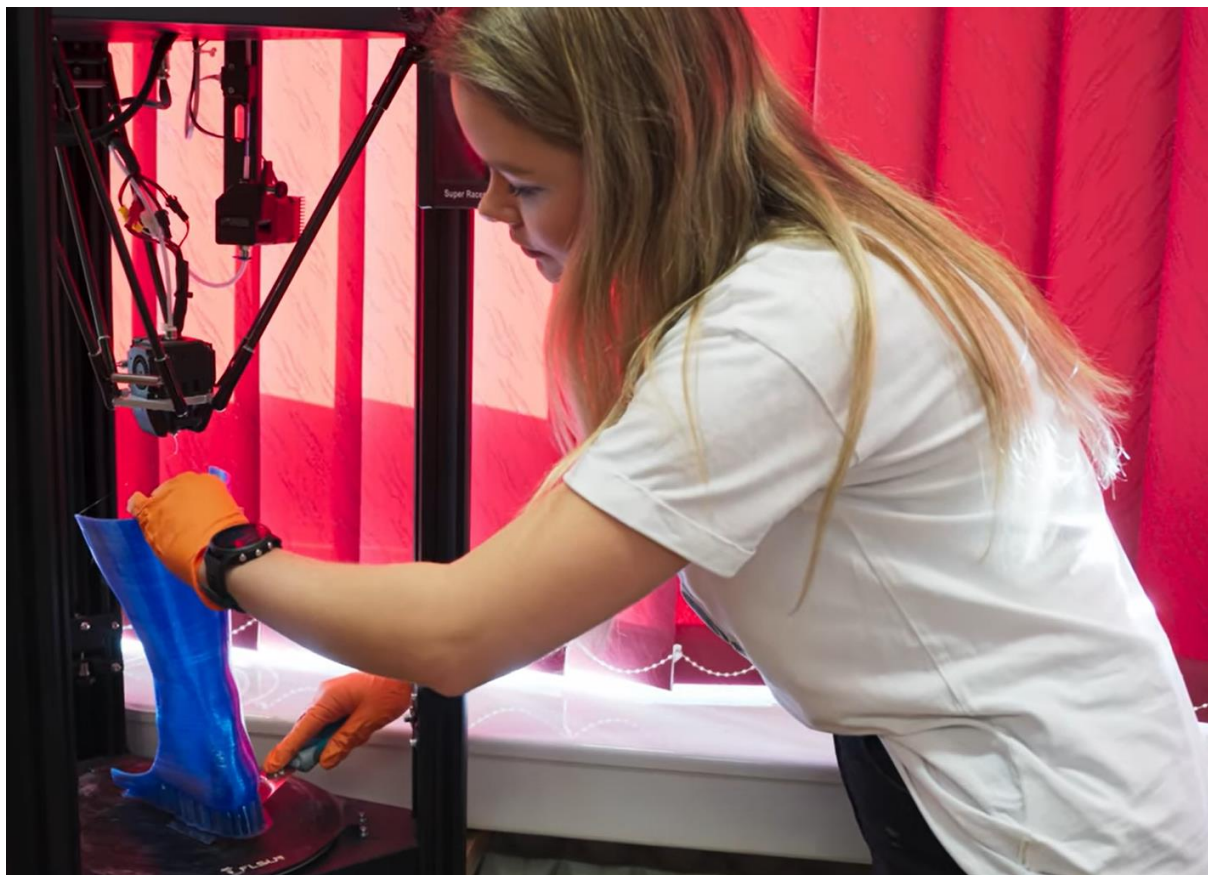
Rysunek 5.16. Orteza stawu skokowego po wydruku [157]
