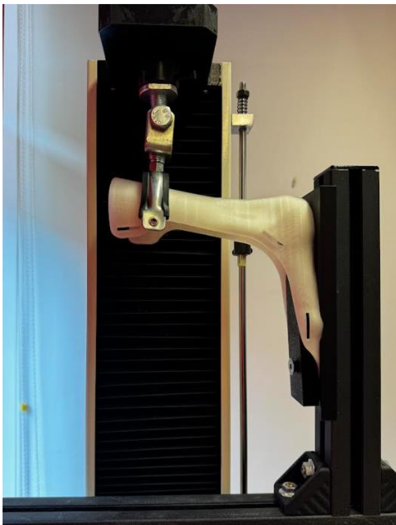
Rysunek 4.25. Stanowisko do badań niszczących dla AFO
