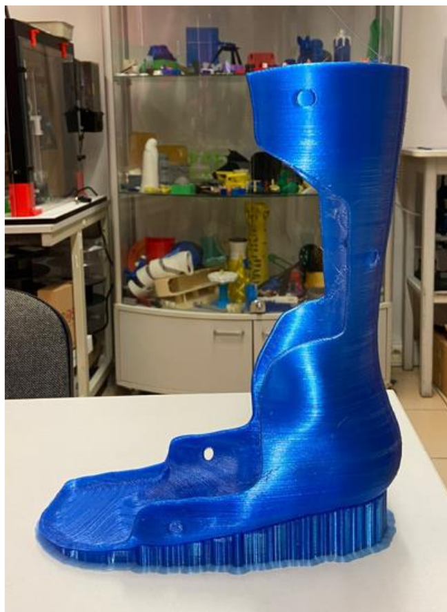
Rysunek 2.2. Orteza stawu skokowego wytworzona metodą FDM z materiału PET-G [75]
