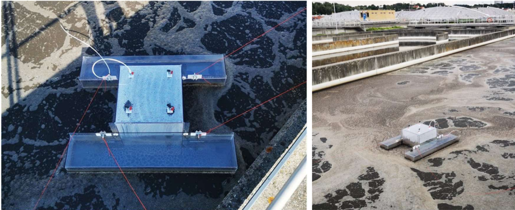
Rysunek 9a, 9b. Zdjęcie komory pomiarowej (ang. flux chamber ). Komora o powierzchni roboczej 50 x 50 [cm] została przymocowana do dwóch pływaków. Cała konstrukcja została wykonana z poliwęglanu [zbiory własne].
