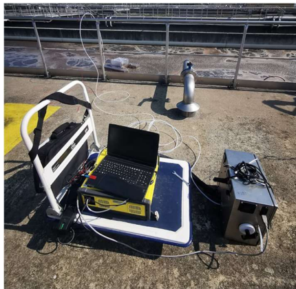
Rysunek 10. Zdjęcie aparatury pomiarowej FTIR: GASMET z kondycjonerem i laptopem z oprogramowaniem CALCMET poliwęglanu [zbiory własne].
