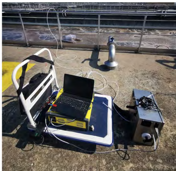
Rysunek 11. Zdjęcie aparatury pomiarowej FTIR: GASMET z kondycjonerem i laptopem z oprogramowaniem CALCMET poliwęglanu [zbiory własne].
