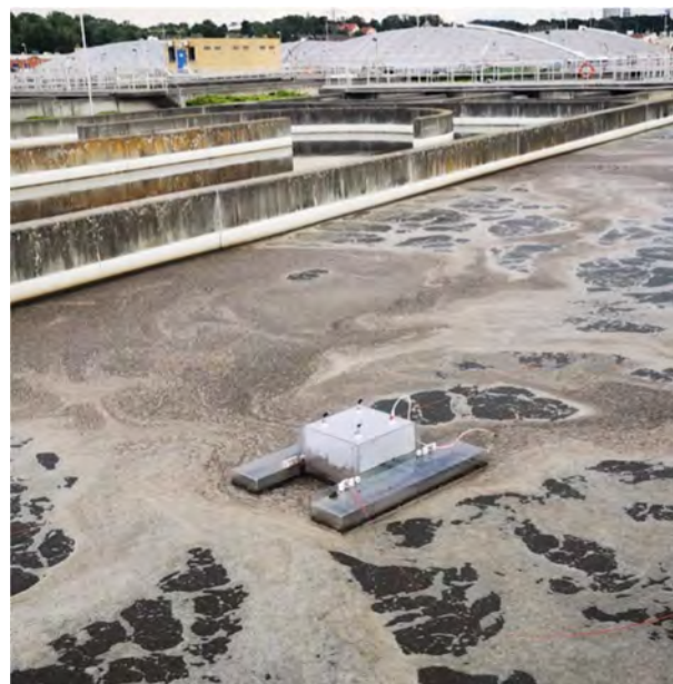
Rysunek 10a, 10b. Zdjęcie komory pomiarowej (ang. flux chamber ). Komora o powierzchni roboczej 50 x 50 [cm] została przymocowana do dwóch pływaków. Cała konstrukcja została wykonana z poliwęglanu [zbiory własne].
