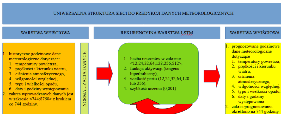
Rys. 8.3. Uniwersalna struktura rekurencyjnej sieci neuronowej wykorzystana do generowania modeli do rozszerzonej prognozy pogody.
