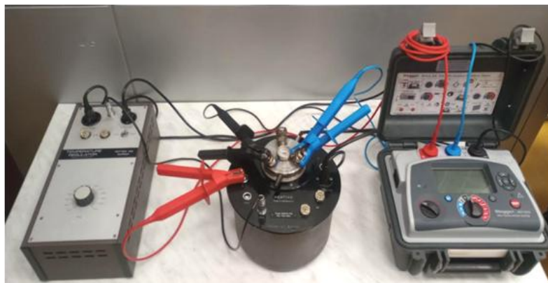
Rys. 7.9. Stanowisko do badania rezystywności estru; od lewej regulator temperatury, kondensator pomiarowy umieszczony w płaszczu grzejnym, miernik rezystancji izolacji Megger MIT1025
