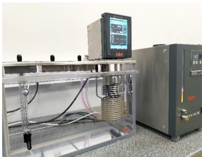
Rys. 7.5. Układ do badania lepkości estru i lepkości roztworu powstałego podczas badania stopnia polimeryzacji celulozy
