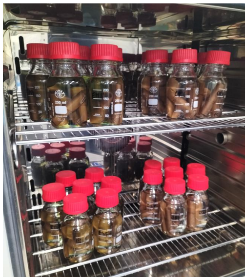
Rys. 9.1. Próbk papieru celulozowego zaimpregnowane estrem naturalnym lub olejem mineralnym przygotowane do starzenia w cieplarni laboratoryjnej
