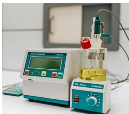
Rys. 7.1. Titrator do badania zawartości wody w cieczach elektroizolacyjnych i papierze
