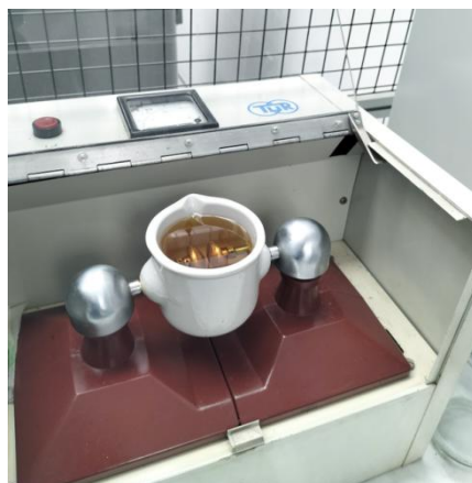
Rys. 7.7. Stanowisko do badania napięcia przebicia estru
