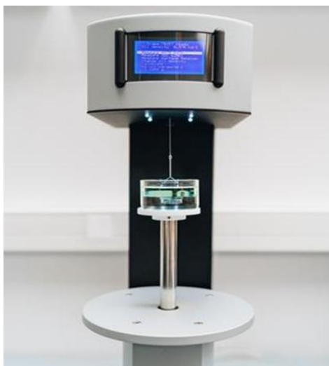
Rys. 7.4. Tensjometr do badania napięcia międzyfazowego
