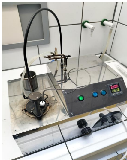
Rys. 7.6. Stanowisko do pomiaru temperatury zapłonu par estru
