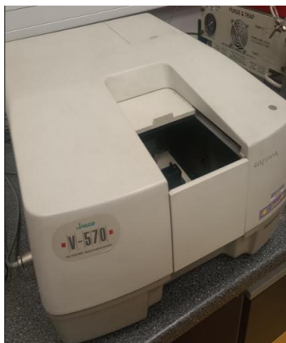
Rys. 7.10. Spektrofotometr do pomiaru widma absorbancji estru
