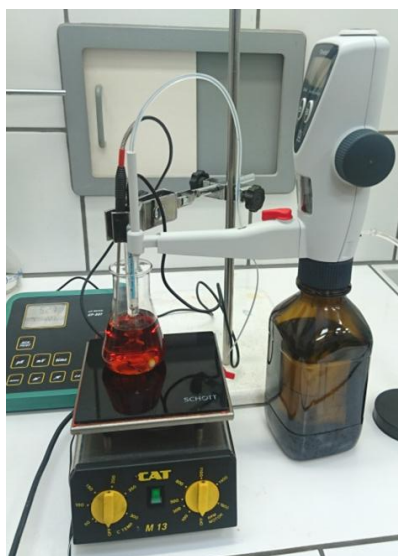
Rys. 7.3. Układ do badania liczby kwasowej cieczy elektroizolacyjnych
