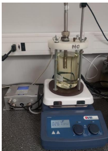
Rys. 7.2. Stanowisko do badania rozpuszczalności wody w estrze
