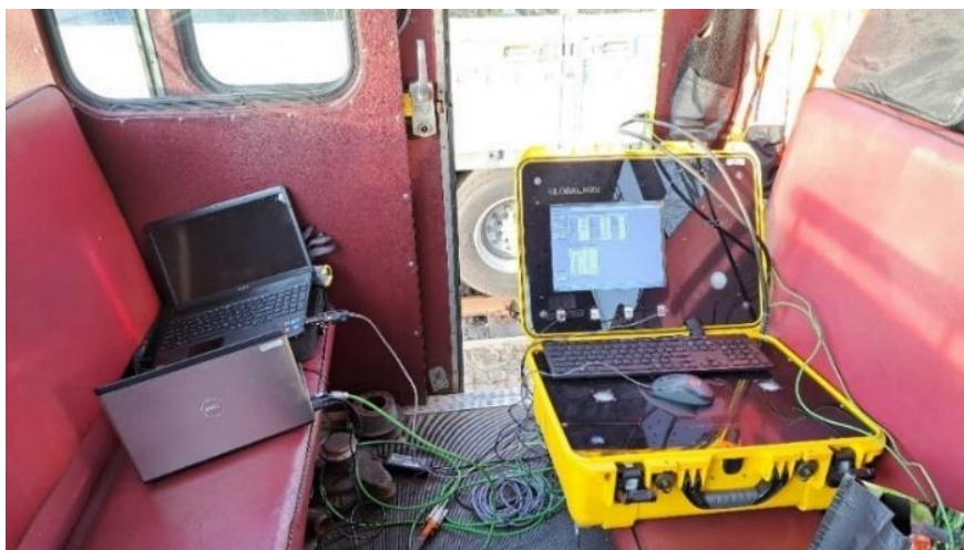
Rys. 6.12. Wnętrze kabiny WM-15A: po lewej stronie znajdują się komputery rejestrujące wyniki pomiarów, po prawej stronie aparatura PEMS Axion R/S+™
