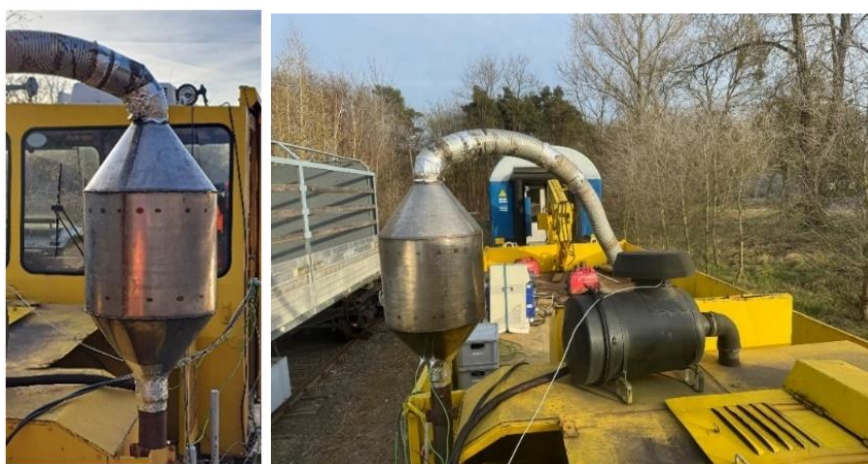
Rys. 9.1. Wytypowany filtr DPF zamontowany na układzie wylotowym pojazdu WM-15A
