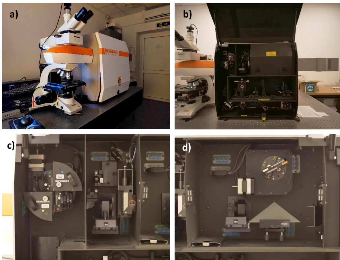
Rysunek 6.1. Zdjęcia układu przedstawiające a) spektrometr Ramana z mikroskopem, b) wnetrzne spektrometru Ramana, c) filtry krawędziowe, d) spektrograf
